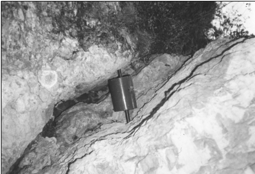
Obr. 5.5.13a: Zabudované terčové meradlo TM-71
