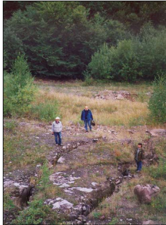
Obr. 5.5.11 Trhliny na povrchu nad podrúbaným územím
