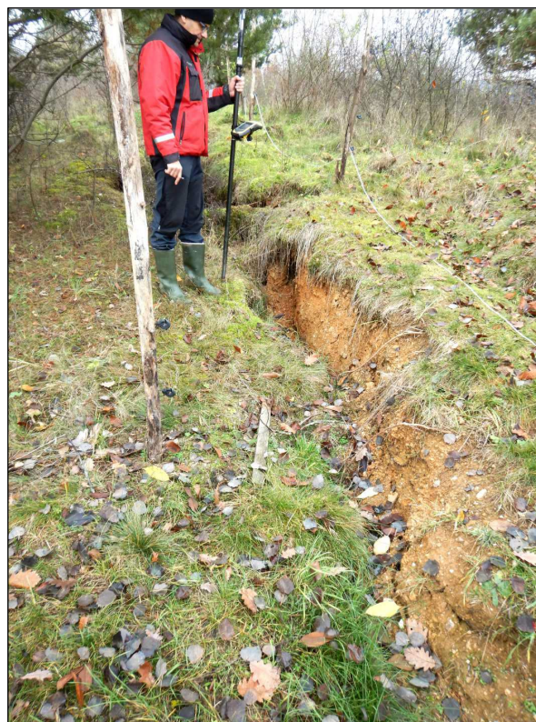
Obr. 4.12.5: Výrazná aktivizácia v r. 2022: a) trhliny t1, b) trhliny t1a
