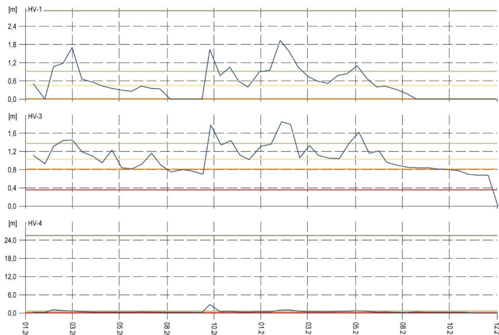
Obr. 4.2.5. Vývoj výdatnosti na vybraných odvodňovacích vrtoch na zosuvnej lokalite Handlová-Kunešovská cesta v rokoch 2020 a 2021, spolu so základnými štatistickými ukazovateľmi. Modrá – nameraná výdatnosť (prietok na ústí odvodňovacieho vrty), červená – minimálna výdatnosť, oranžová – 1. kvartil, žltá – 2. kvartil, bledozelená – 3. kvartil, tmavozelená – maximálna výdatnosť. Štatistické ukazovatele sú odvodené z údajov, ktoré boli namerané na jednotlivých odvodňovacích vrtoch počas referenčného obdobia: 2012 – 2019.
