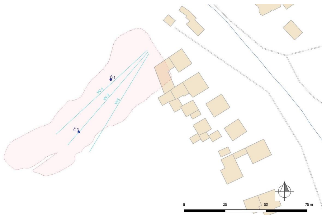
Obr. 4.10.1. Lokalita Čirč – situácia monitorovaných objektov, na ktorých sú zabezpečované režimové pozorovania (objekty označené ako body – piezometrické vrty, objekty označené ako línie – hĺbkové odvodnenie pomocou subhorizontálnych odvodňovacích vrtov); ohraničenie zosuvov podľa Šimekovej et al. (2012), mapový podklad: ZBGIS®.
