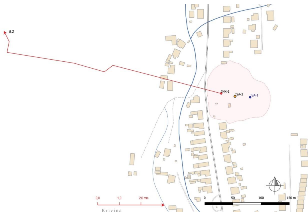
Obr. 4.3.1. Lokalita Svätý Anton – vektory deformácií namerané v rokoch 2020 a 2021 (obdobia jednotlivých meracích etáp sú v súlade s tab. 4.3.2; číslo zobrazené pri poslednom vektore označuje hĺbku zaznamenatej deformácie od povrchu terénu v m; vrty JSA-1 a 2 slúžia na monitorovanie režimových ukazovateľov); ohraničenie zosuvu podľa Laurenčíka a Sluku (2015 in Šimeková et al., 2015), mapový podklad: ZBGIS®.
