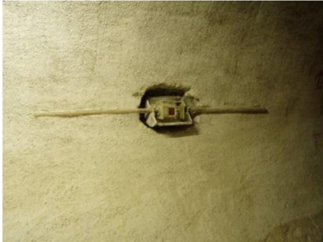
Obr. 28 Inštalácia dilatometra TM-71 v únikovej štôlni tunela Branisko
