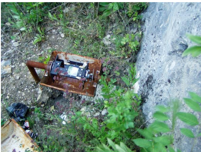
Obr. 33 Inštalácia dilatometra TM-71 na tektonickej poruche v lokalite Dobrá Voda
