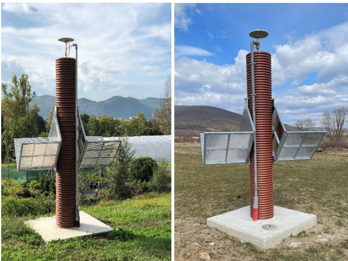
Obr. 4a Kolokačná stanica GNSS a InSAR, ZVOL – vľavo, DVCN - vpravo
