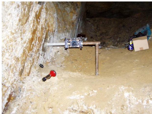
Obr. 30 Inštalácia dilatometra TM-71 v prieskumnej štôlni Izabela na lokalite Ipeľ
