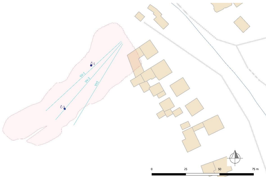
Obr. 4.10.1. Lokalita Čirč – situácia monitorovaných objektov, na ktorých sú zabezpečované režimové pozorovania (objekty označené ako body – piezometrické vrty, objekty označené ako línie – hĺbkové odvodnenie pomocou subhorizontálnych odvodňovacích vrtoch); ohraničenie zosuvov podľa Šimekovej et al. (2012), mapový podklad: ZBGIS®.
