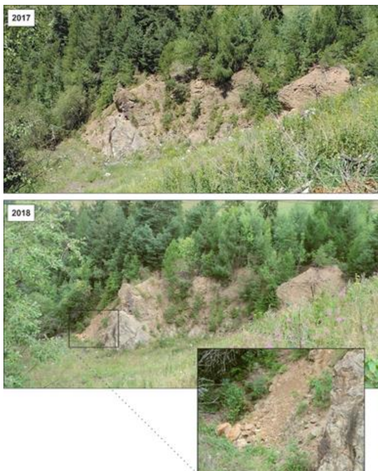
Obr. 18: Porovnávacie fotografické snímkovania západnej časti závalového pásma Baniská o severný okraj závalového pásma zo stanovi–a 3 v detaile s akumuláciou odvalených horninových blokov
