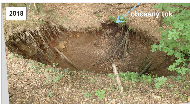
Obr. 7: Zával Z1 nad banskou chodbou –ôlne Rýhová dokumentovaný v r. 2015 a 2018 (poh ad zo severu)
