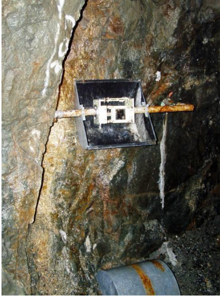
Obr. 30 In–talácia dilatometra TM-71 v prieskumnej –tôlni Izabela na lokalite Ipe
