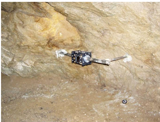
Obr. 32 In–talácia dilatometra TM-71 v opustenej –tôlni sv. Anton Paduánsky na lokalite Vyhne
