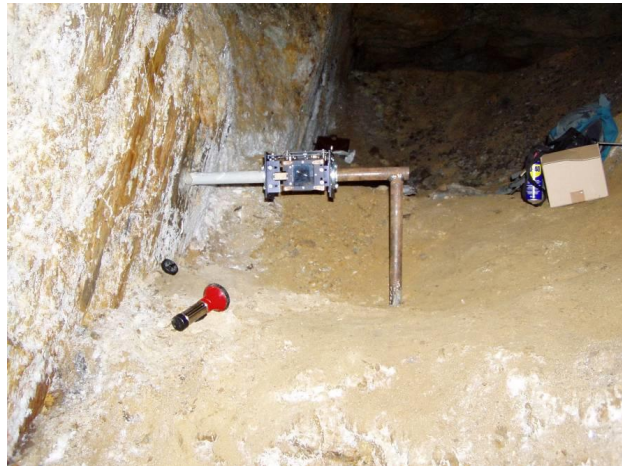
Obr. 31 In–talácia dilatometra TM-71 v –tôlni V–ech–svätých (stará) na lokalite Banská Hodruša (Hámre)
