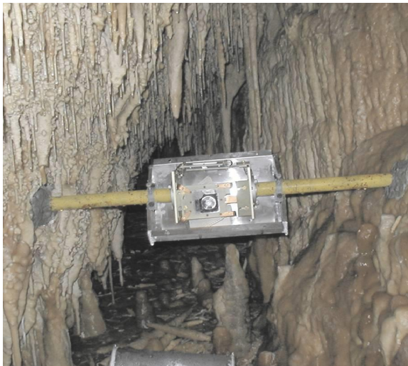
Obr. 29 Inštalácia dilatometra TM-71 v úrovnej chodbe (Demänovská jaskyňa a Slobody)
