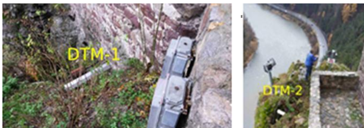
Obr. 22b Pozícia dilatometrov Geokon DTM1 a DTM2 v trhline pod kaplnkou Strečnianskeho hradu.
