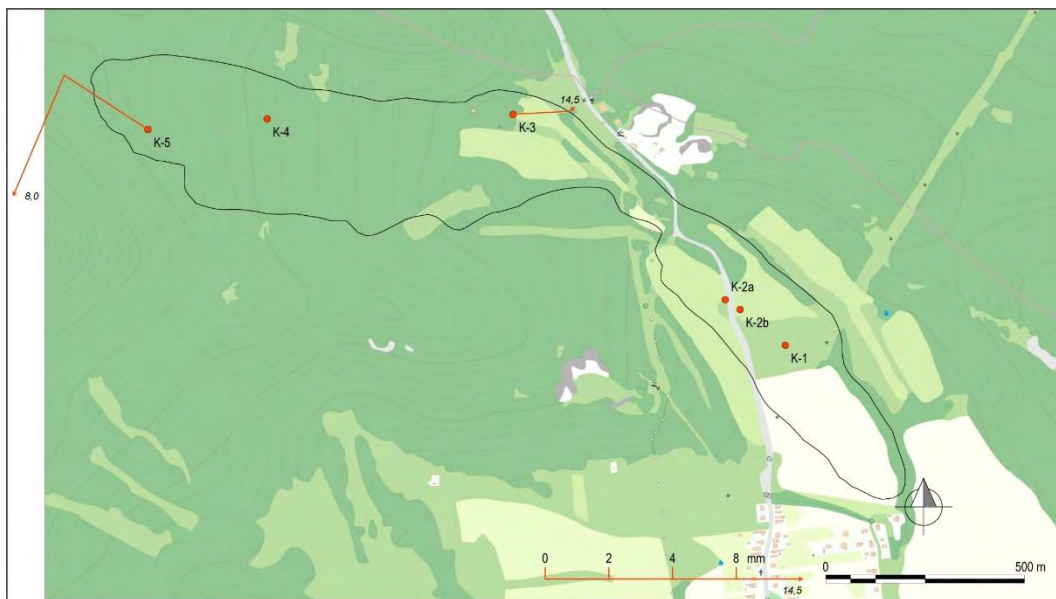
Obr. 4.9.3. Lokalita Fintice – výsledky inklinometrických meraní v rokoch 2015 a 2016 (obdobia jednotlivých meracích etáp sú v súlade s tab. 4.9.3; čísla zobrazené pri jednotlivých vektoroch označujú hĺbku zaznamenananej deformácie od povrchu terénu v m; mapový podklad: ZBGIS®).
