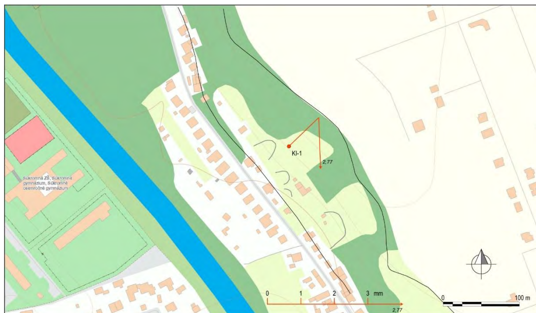
Obr. 4.27.1. Lokalita Košice-Krásna – výsledky inklinometrických meraní v rokoch 2015 a 2016 (obdobia jednotlivých meracích etáp sú v súlade s tab. 4.27.2; číslo zobrazené pri poslednom etapovom vektore označuje hĺbku zaznamenananej deformácie od povrchu terénu v m); obrysy zosuvov podľa Grman et al. (2010), mapový podklad: ZBGIS®.
