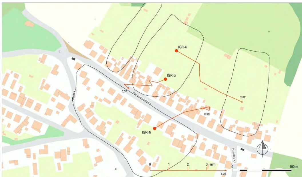
Obr. 4.5.1. Lokalita Velká Lehůtka, Remeselnická ul. – výsledky inklinometrických meraní – vektory deformácií namerané v rokoch 2015 a 2016 (obdobia meracích etáp sú v súlade s tab. 4.5.2; čísla zobrazené pri jednotlivých vektoroch označujú hĺbku zaznamenananej deformácie od ústia pažnice v m); ohraničenie zosuvu: Fekeč a Ilkanič, 2014b in Šimeková et al., 2014, mapový podklad: ZBGIS®.
