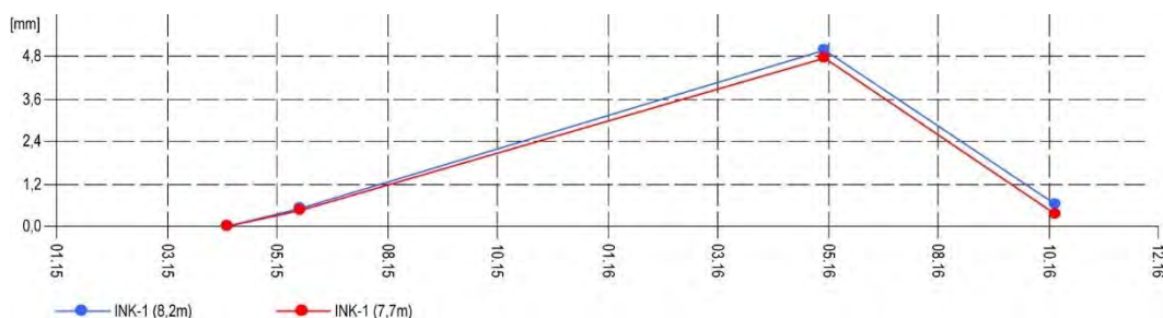
Obr. 4.10.3. Prírastky deformácie namerané na šmykovej ploche metódou presnej inklinometrie na lokalite Svätý Anton v období rokov 2015 a 2016.
