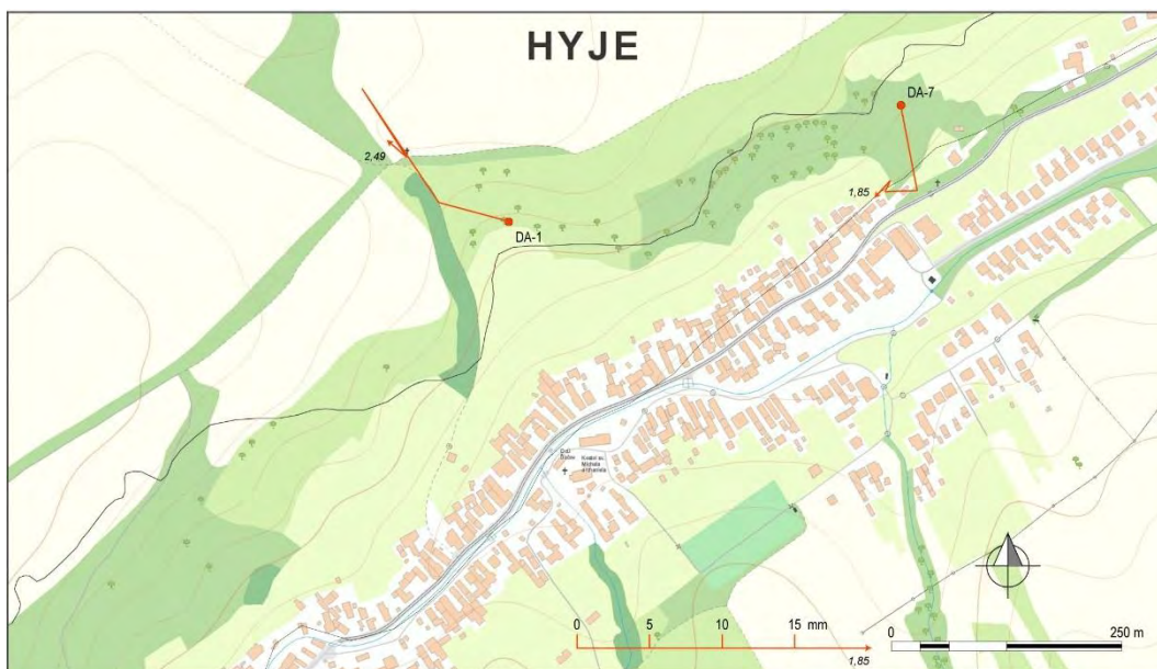
Obr. 4.17.1. Lokalita Dačov – výsledky inklinometrických meraní v rokoch 2015 a 2016 (obdobia jednotlivých meracích etáp sú v súlade s tab. 4.17.2; čísla zobrazené pri vektoroch označujú hĺbku zaznamenatej deformácie od povrchu terénu v m); mapový podklad: ZBGIS®.
