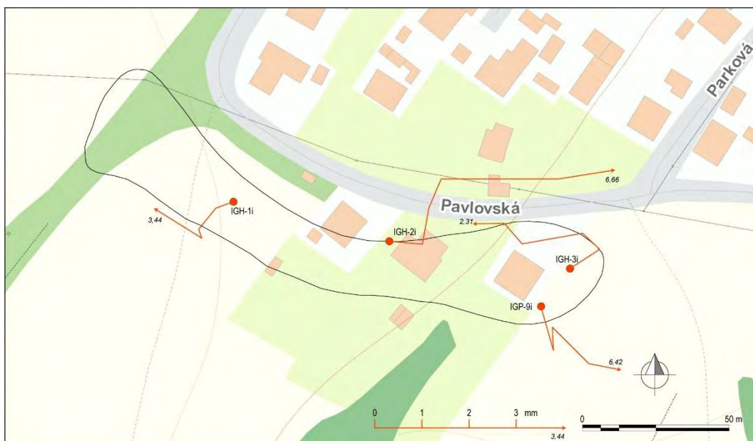
Obr. 4.4.1. Lokalita Prievdza-Hradec (Pavlovská ul.) – výsledky inklinometrických meraní. Červená – vektory deformácií namerané v rokoch 2015 až 2016 (obdobia jednotlivých meracích etáp sú v súlade s tab. 4.4.2; zobrazené čísla pri vektoroch predstavujú hĺbku zaznamenananej deformácie od povrchu terénu v m; mapový podklad: ZBGIS®).
