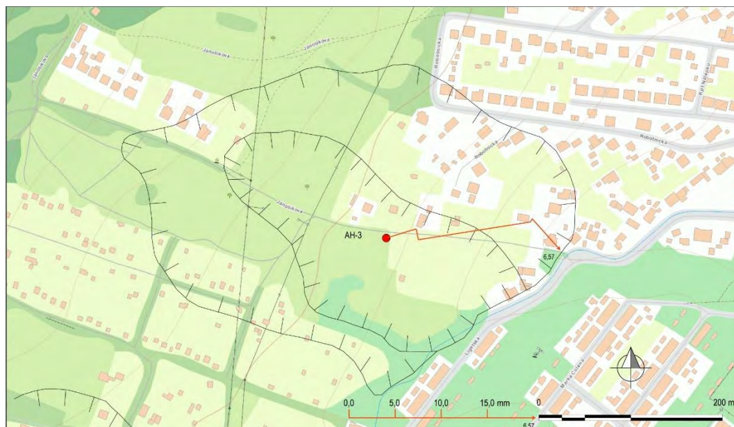
Obr. 4.6.1. Handlová-Morovnianske sídlisko (oblasť Jánošíkovej cesty) – výsledky inklinometrických meraní za roky 2015 a 2016 (obdobia jednotlivých meraní sú v súlade s tab. 4.6.2; čísla zobrazené pri jednotlivých vektoroch označujú hĺbku zaznamenananej deformácie od povrchu terénu v m); mapový podklad: ZBGIS®.
