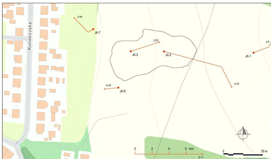
Obr. 4.7.1. Lokalita Handlová-Kunešovská cesta – výsledky inklinometrických meraní za roky 2015 a 2016 (obdobia jednotlivých meraní sú v súlade s tab. 4.7.2; čísla zobrazené pri jednotlivých vektorech označujú hĺbku zaznamenananej deformácie od povrchu terénu v m); mapový podklad: ZBGIS®.
