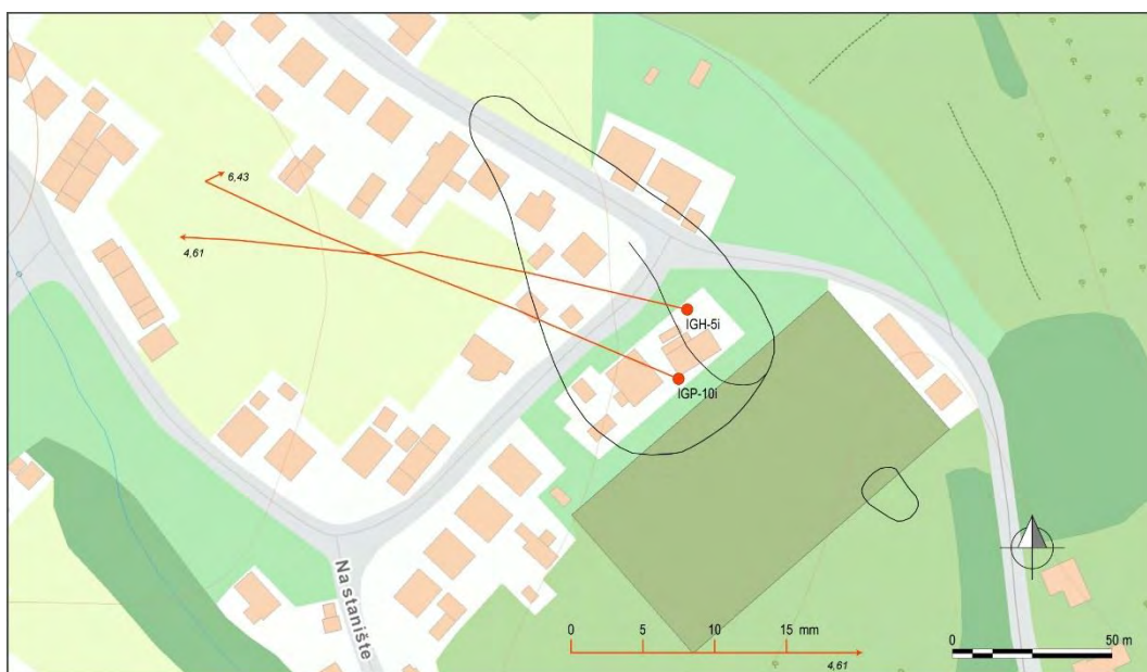
Obr. 4.4.2. Lokalita Prievdza-Hradec (ul. Na Stanište) – výsledky inklinometrických meraní. Červená – vektory deformácií namerané v rokoch 2015 až 2016 (obdobia jednotlivých meracích etáp sú v súlade s tab. 1.2; zobrazené čísla pri vektoroch predstavujú hĺbku zaznamenananej deformácie od povrchu terénu v m; mapový podklad: ZBGIS®).
