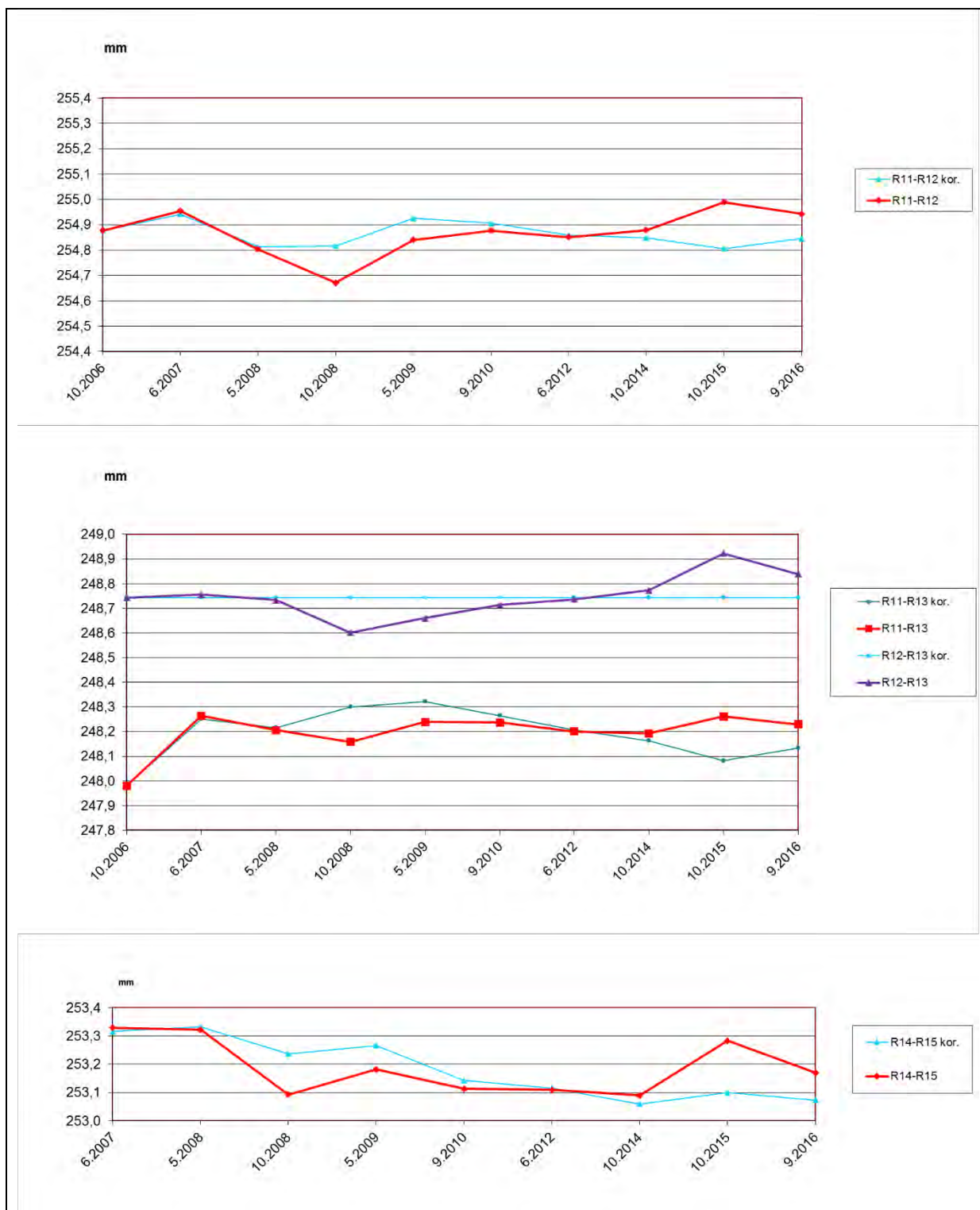
Obr. 4.39.3. Výsledky merania posuvu blokov na lokalite Pod večným dažďom dilatometrom Somet. Grafy s korekciou nameraných hodnôt zohľadňujú zmeny podmienok a techniky merania (označené príponou kor. – údaje v nich sú upravované v závislosti od hodnoty nameranej vzdialenosti medzi bodmi R12 – R13, situovanými na jednom samostatnom horninovom bloku).
