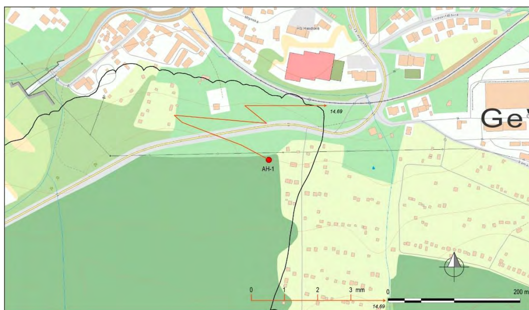
Obr. 4.8.1. Lokalita Handlová-zosuv z roku 1960 – výsledky inklinometrických meraní za obdobie rokov 2015 a 2016 (obdobia jednotlivých meraní sú v súlade s tab. 4.8.2; číslo zobrazené pri poslednom vektore označuje hĺbku zaznamenananej deformácie od povrchu terénu v m); mapový podklad: ZBGIS®.
