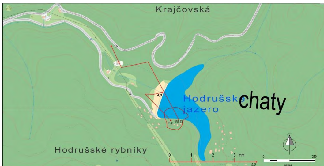
Obr. 4.11.1. Lokalita Hodruša-Hámre – výsledky inklinometrických meraní v roku 2016 (obdobia jednotlivých meracích etáp sú v súlade s tab. 4.11.2; čísla zobrazené pri jednotlivých vektorech označujú hĺbku zaznamenananej deformácie od ústia pažnice v m; mapový podklad: ZBGIS®)
