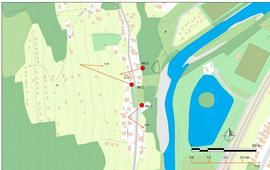
Obr. 4.21.1. Lokalita Žilina-Vranie – výsledky inklinometrických meraní v období rokov 2015 a 2016 (obdobie meracej etapy je v súlade s tab. 4.18.2; číslo zobrazené pri vektore označuje hĺbku zaznamenananej deformácie od povrchu terénu v m); mapový podklad: ZBGIS®.
