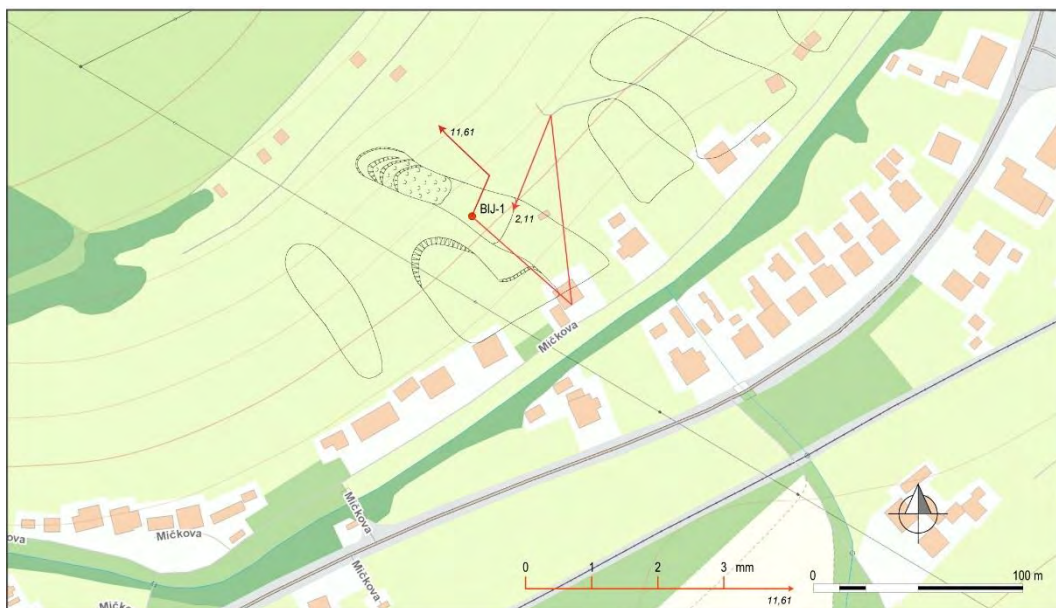
Obr. 4.18.1. Lokalita Bardejovská Zábava – výsledky inklinometrických meraní v rokoch 2015 a 2016 (obdobia jednotlivých meracích etáp sú v súlade s tab.4.15.2; čísla zobrazené pri jednotlivých vektoroch označujú hĺbku zaznamenananej deformácie od povrchu terénu v m); obrysy zosuvov podľa Havča (2012), mapový podklad: ZBGIS®.
