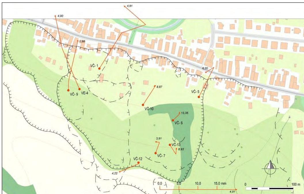
Obr. 4.3.5. Lokalita Velká Čausa – výsledky inklinometrických meraní v rokoch 2015 a 2016 (obdobia jednotlivých meracích etáp sú v súlade s tab. 4.3.5; čísla zobrazené pri jednotlivých vektorech označujú hĺbku zaznamenananej deformácie od povrchu terénu v m); obrysy zosuvov podľa Jadroňa a Mokrej (1999), mapový podklad: ZBGIS®.
