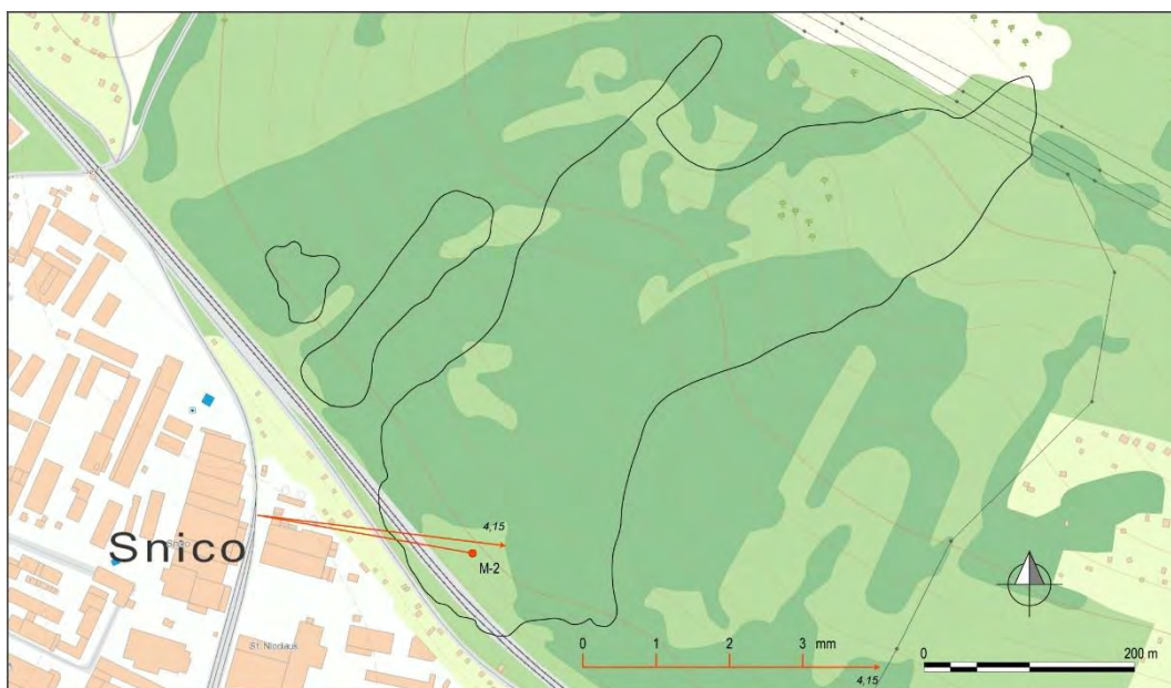
Obr. 4.15.3. Lokalita Okoličné – výsledky inklinometrických meraní v rokoch 2015 a 2016 (obdobia meracích etáp sú v súlade s tab. 4.15.3; čísla zobrazené pri vektoroch označujú hĺbku zaznamenananej deformácie od povrchu terénu v m); obrysy zosuvov podľa: Fussgänger a Jadroň (1977), mapový podklad: ZBGIS®.
