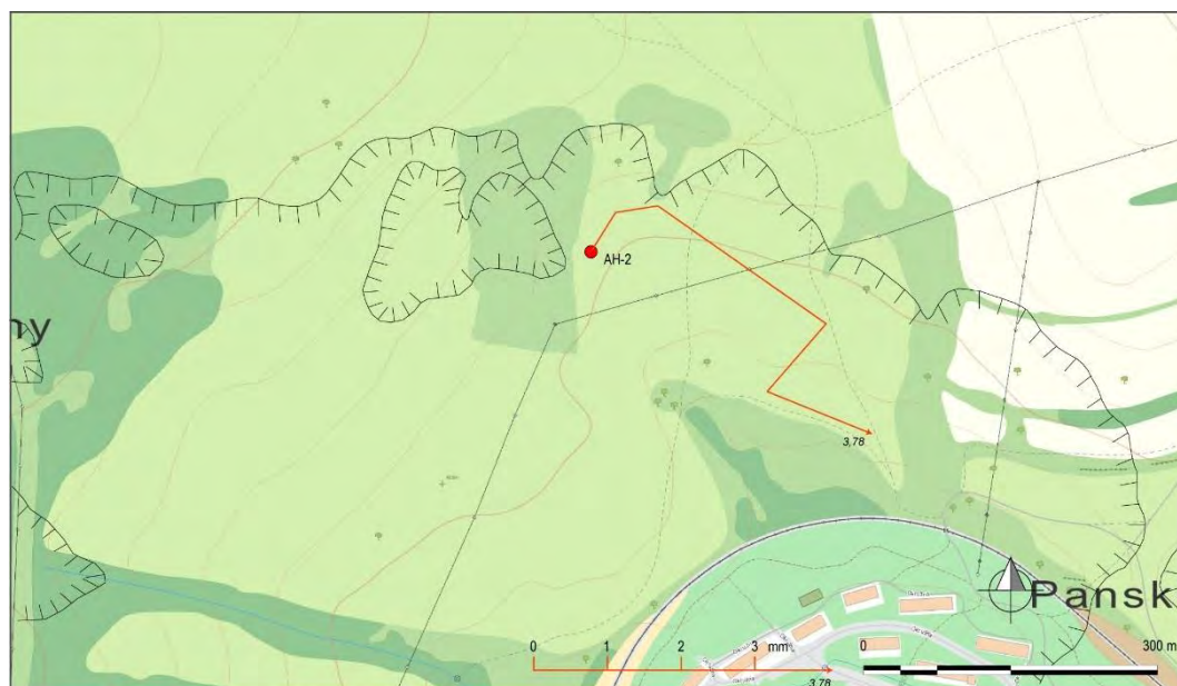
Obr. 4.6.3. Handlová-Morovnianske sídlisko (oblasť nad železničným oblúkom) – výsledky inklinometrických meraní za rok 2015 (obdobia jednotlivých meraní sú v súlade s tab. 4.6.2; čísla zobrazené pri jednotlivých vektorech označujú hĺbku zaznamenananej deformácie od povrchu terénu v m); mapový podklad: ZBGIS®.
