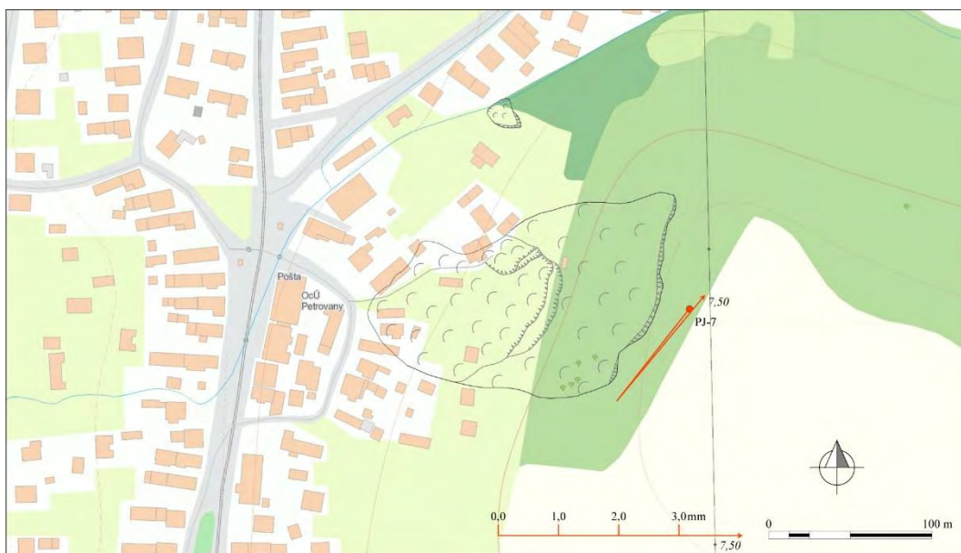
Obr. 4.29.1. Lokalita Petrovany – výsledky inklinometrických meraní v rokoch 2015 a 2016 (obdobia jednotlivých meracích etáp sú v súlade s tab. 4.29.2; číslo zobrazené pri vektore označuje hĺbku zaznamenananej deformácie od povrchu terénu v m); mapový podklad: ZBGIS®.
