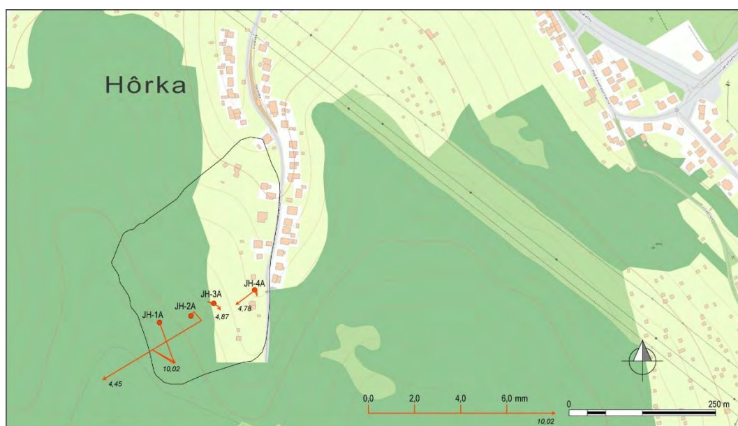
Obr. 4.19.1. Lokalita Prešov-Horárska ul. – výsledky inklinometrických meraní v rokoch 2015 a 2016 (obdobia jednotlivých meracích etáp sú v súlade s tab. 4.19.2; čísla zobrazené pri jednotlivých vektoroch označujú hĺbku zaznamenananej deformácie od povrchu terénu v m); mapový podklad: ZBGIS®.
