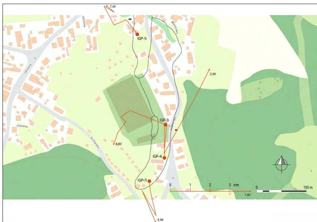
Obr. 4.5.2. Lokalita Veľká Lehôtka, Podhorská ul. – výsledky inklinometrických meraní – vektory deformácií namerané v rokoch 2015 a 2016 (obdobia meracích etáp sú v súlade s tab. 4.5.2; čísla zobrazené pri jednotlivých vektoroch označujú hĺbku zaznamenananej deformácie od ústia pažnice v m); ohraničenie zosuvu: Fekeč a Ilkanič, 2014b in Šimeková et al., 2014, mapový podklad: ZBGIS®.
