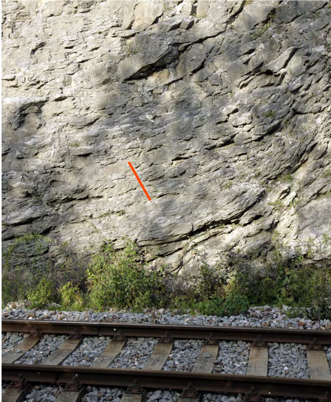
Obr. 1.125 Umiestnenie stanoviska na meranie mikromorfologických zmien povrchu odkrytého zárezu železnice pri obci Jakub. Červenou líniou je zvýraznené stanovisko umiestnenia meradla morfologických zmien (foto M. Brček, 2009)
