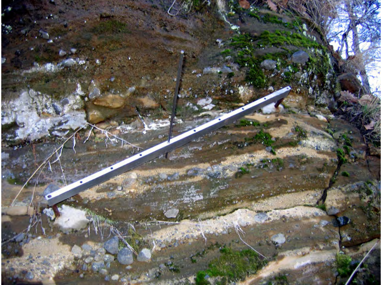
Obr. 1.114 Situovanie meradla mikromorfologických zmien povrchu horniny na skalnej stene oproti katastrofálnemu handlovskému zosuvu (lokalita Handlová-Baňa; foto P. Liščák, 2005)
