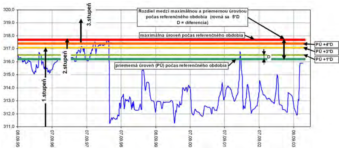
Obr. 1.3 Postup odvodenia referenčných hodnôt pre semikvantitatívne hodnotenie zmien úrovne hladiny podzemnej vody, obsiahnutý v tab. 1.6 (záznam z pozorovania hladiny podzemnej vody vo vrte VČ-4 z lokality Veľká Čausa). Postup vypracoval S. Scherer (2004)
