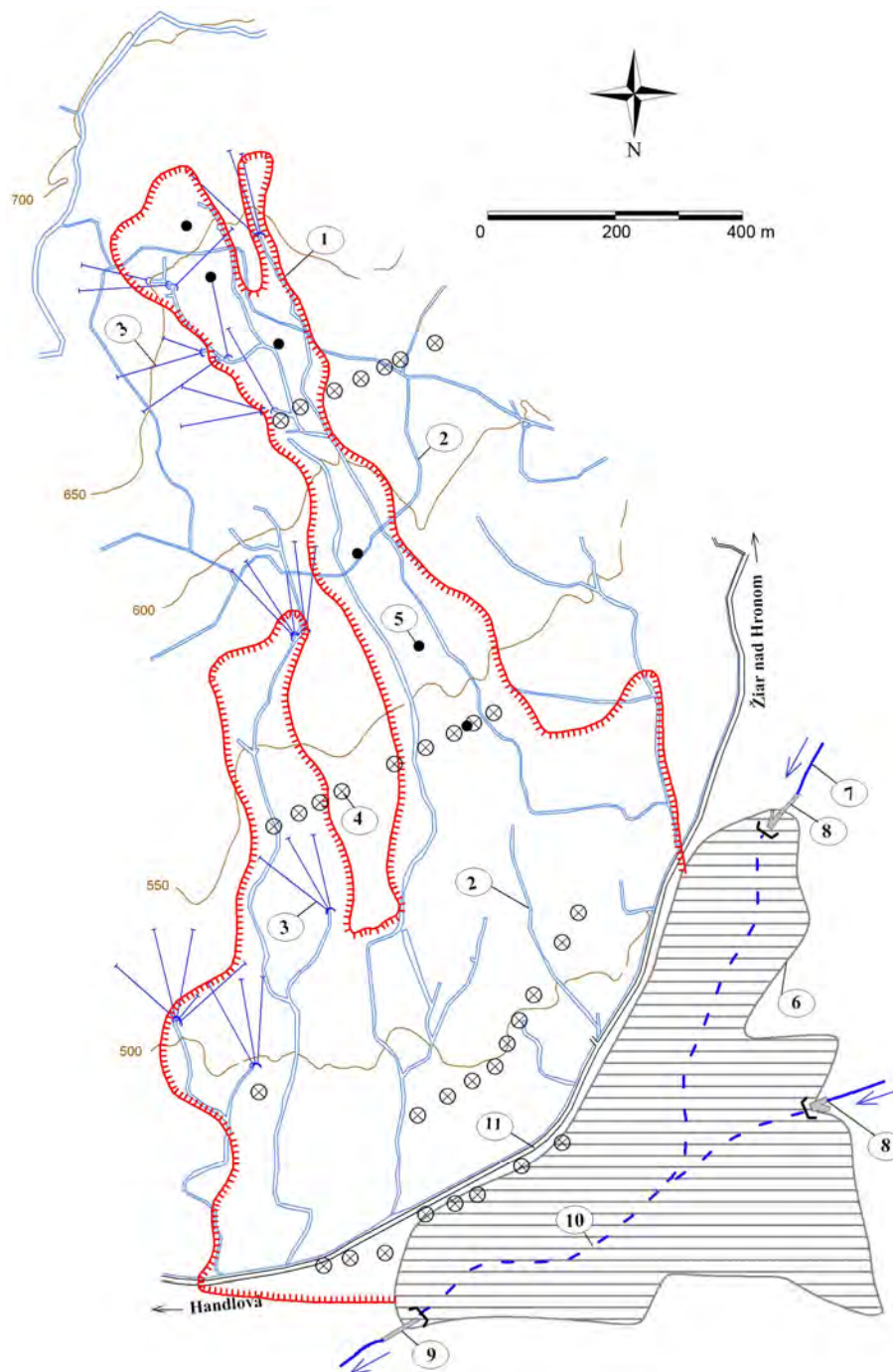
Obr. 1.133 Lokalita Handlová – situovanie Stabilizačného násypu na úpätí svahu katastrofálneho zosuvu z roku 1960/1961
