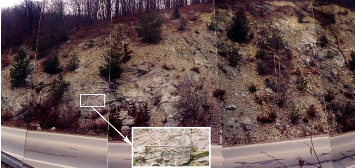
Obr. 1.131 Skalná stena odrezu cesty na lokalite Lipovník (s detailom umiestnenia meradla mikromorfologických zmien – foto Ľ. Petro, 2006)
