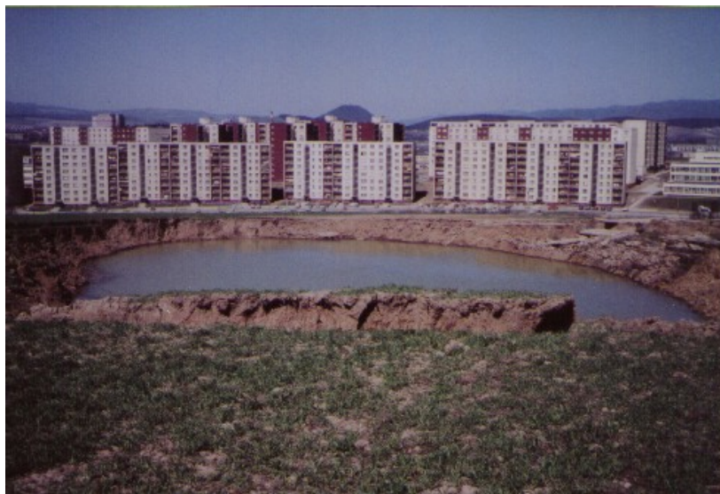
Obr. 57: Prepadlisko v lúhovacom poli ložiska Prešov - Solivar (apríl 1988).
