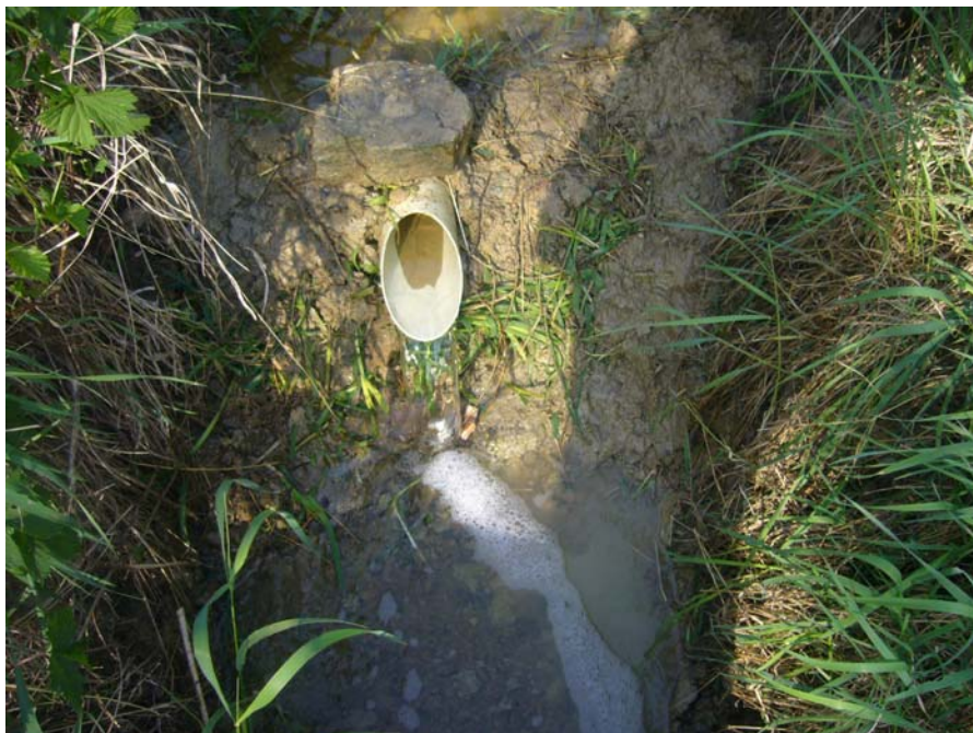
Obr. 13 Výtok z čela skládky, meranie prietoku
