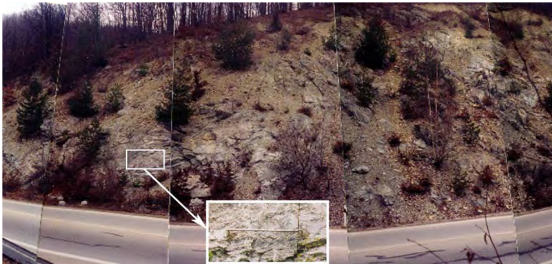
Obr. 2.1.120: Situovanie meradla mikromorfologických zmien povrchu horniny na svahu odrezu – lokalita Lipovník
