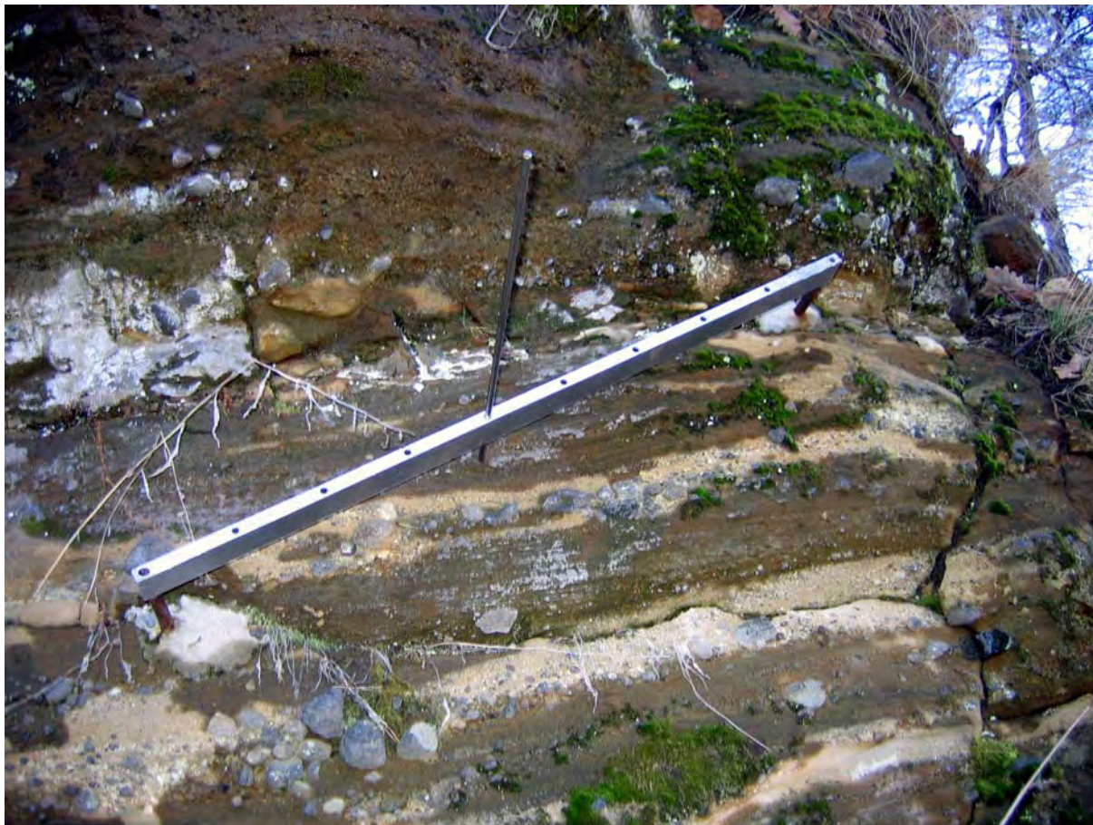
Obr. 2.1.41: Situovanie meradla mikromorfologických zmien povrchu horniny na skalnej stene oproti katastrofálnemu handlovskému zosuvu
