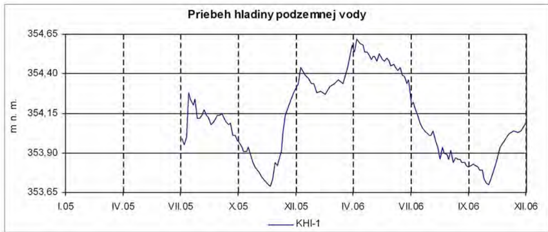
Obr. 2.1.71: Priebeh zmien hĺbky hladiny podzemnej vody vo vrte KHI-1.
