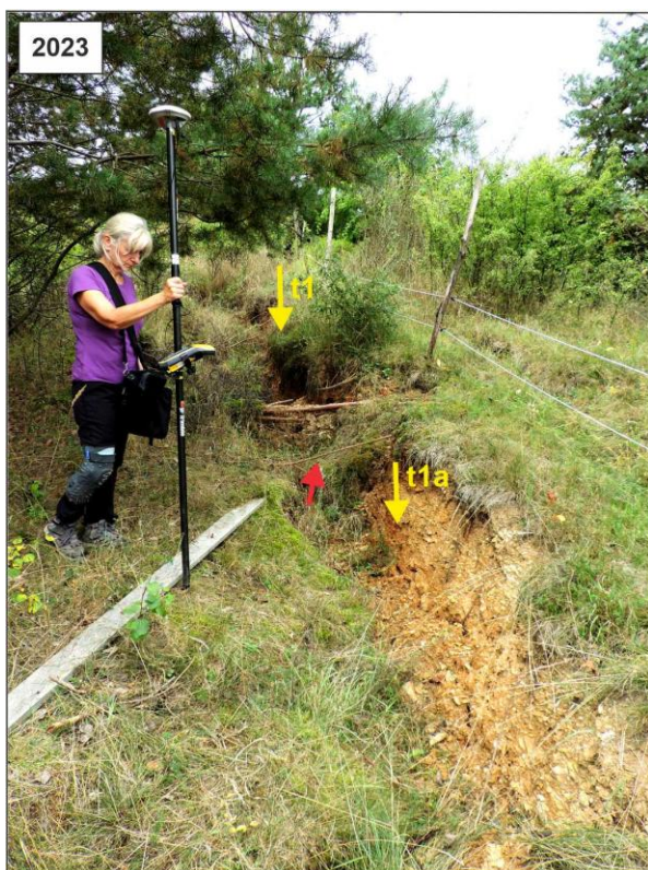
Obr. 4.12.7: Porovnávacie fotografické snímky trhliny t1a s prechodom do trhliny t1 z r. 2023 a r. 2024 s vyznačením pretrhnutia koreňa pri rozširovaní trhliny (červenou šípku).
