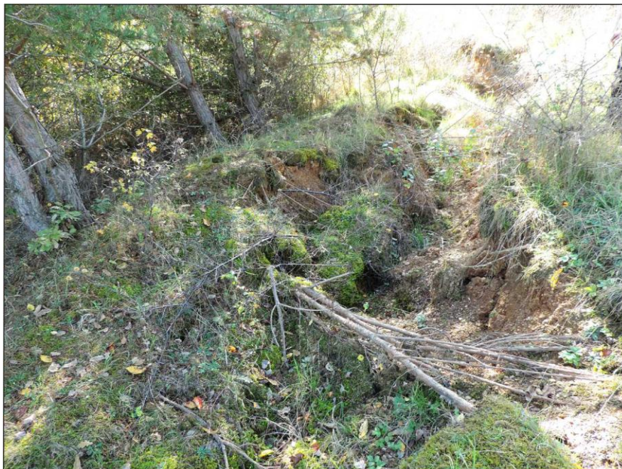
Obr. 4.12.6: Výrazne otvorená aktívna trhlina t1.
