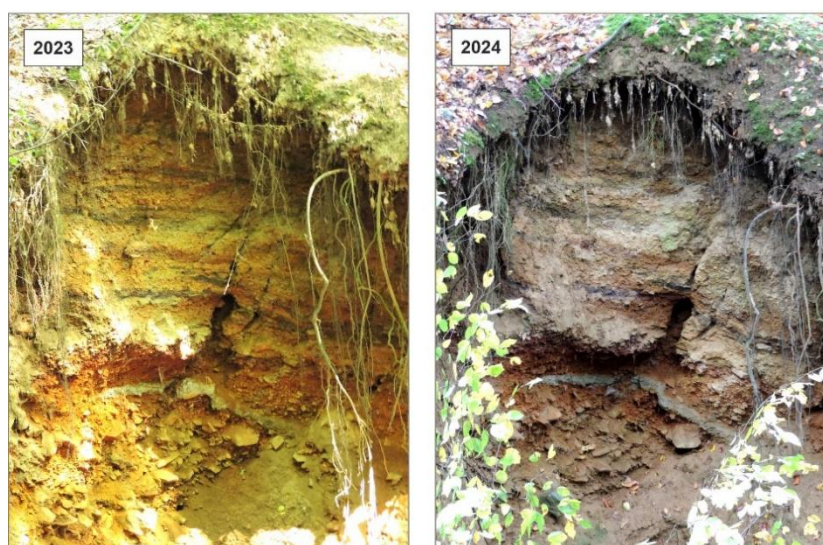
Obr. 4.4.4: Porovnávacie fotografické snímkovanie detailu trhlín na V stene závalu Z1 v smere na zával Z3 z r. 2023 a 2024.
