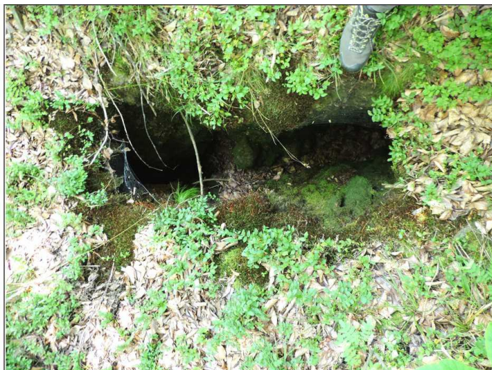
Obr. 4.6.11: Východné ukončenie závalového pásma Baniská: a) výrazná ťahová trhlina na južnom okraji južnej vetvy, b) široká ťahová trhlina v oblasti reliktu horninového masívu medzi severnou a južnou vetvou závalového pásma.
