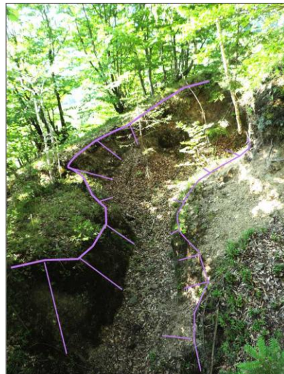
Obr. 4.6.11: Východné ukončenie závalového pásma Baniská: a) výrazná ťahová trhlina na južnom okraji južnej vetvy, b) široká ťahová trhlina v oblasti reliktu horninového masívu medzi severnou a južnou vetvou závalového pásma.
