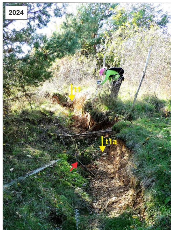
Obr. 4.12.7: Porovnávacie fotografické snímky trhliny t1a s prechodom do trhliny t1 z r. 2023 a r. 2024 s vyznačením pretrhnutia koreňa pri rozširovaní trhliny (červenou šípku).
