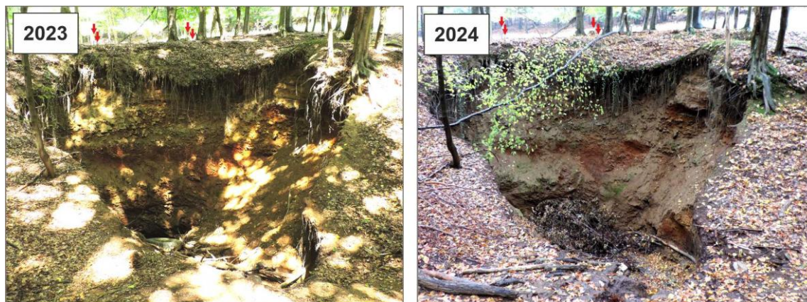
Obr. 4.4.3: Porovnávacie fotografické snímkovanie závalu Z1 z r. 2023 a 2024 (pohľad z juhu) s označením situovania monitorovacích kolíkov (červenými šípkami).
