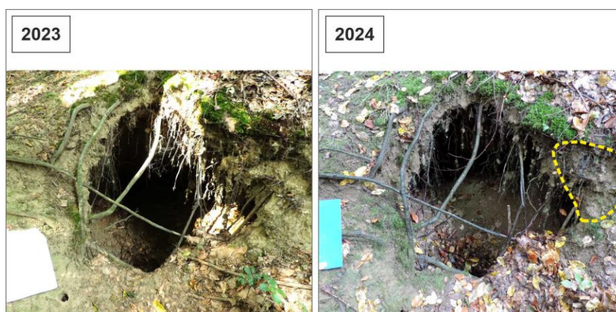
Obr. 4.4.6: Lokálny menší zával na SZ okraji závalu Z3, stav z r. 2023 a r. 2024 s označením prepádnutej časti povrchu terénu.
