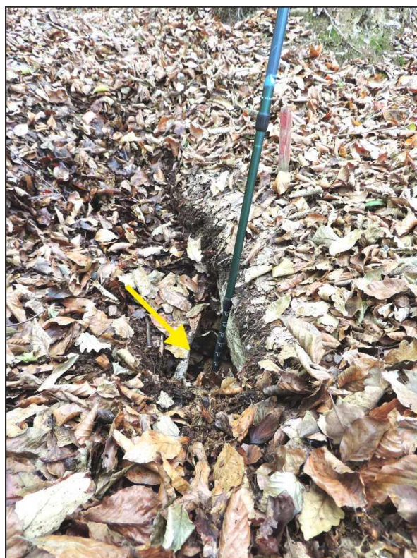
Obr. 4.7.12: Nové ťahovo – poklesové trhliny zaznamenané v r. 2024: a) trhlina 6, b) trhlina 16.
