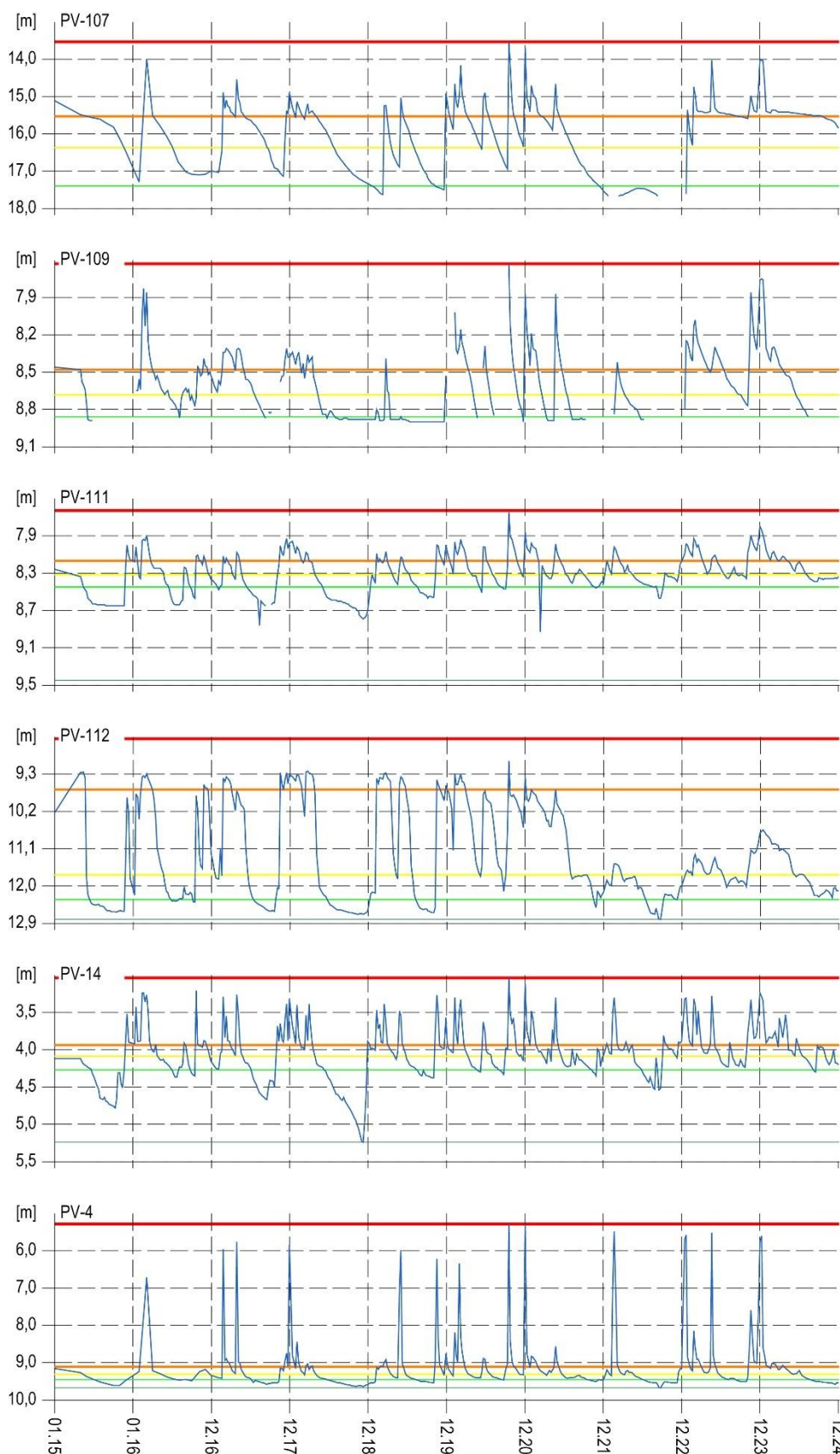
Obr. 4.20.14. Dlhodobý vývoj hladiny podzemnej vody na lokalite Handlová-Stabilizačný násyp, nameranej v rokoch 2015 až 2024 vo vrtoch: PV-107, PV-109, PV-111, PV-112, PV-14 a PV-4 a porovnanie so štatistickými ukazovateľmi, ktoré boli odvodené z údajov o HPV referenčného obdobia (január 2003 – december 2022); červená – maximálna, tmavozelená – minimálna HPV RO, bledozelená – 1. kvartil, žltá – 2. kvartil, oranžová – 3. kvartil HPV počas RO.
