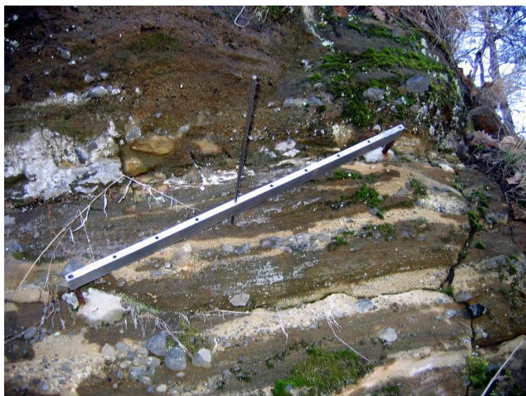
Obr. 4.16.1. Situovanie meradla mikromorfologických zmien povrchu horniny na skalnej stene oproti katastrofálnemu handlovskému zosuvu (lokalita Handlová-Baňa).
