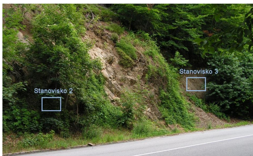
Obr. 4.19.1. Situovanie stanovišť 2 a 3 na lokalite Pezinská Baba na meranie mikromorfologických zmien povrchu horniny na svahu odrezu cesty.
