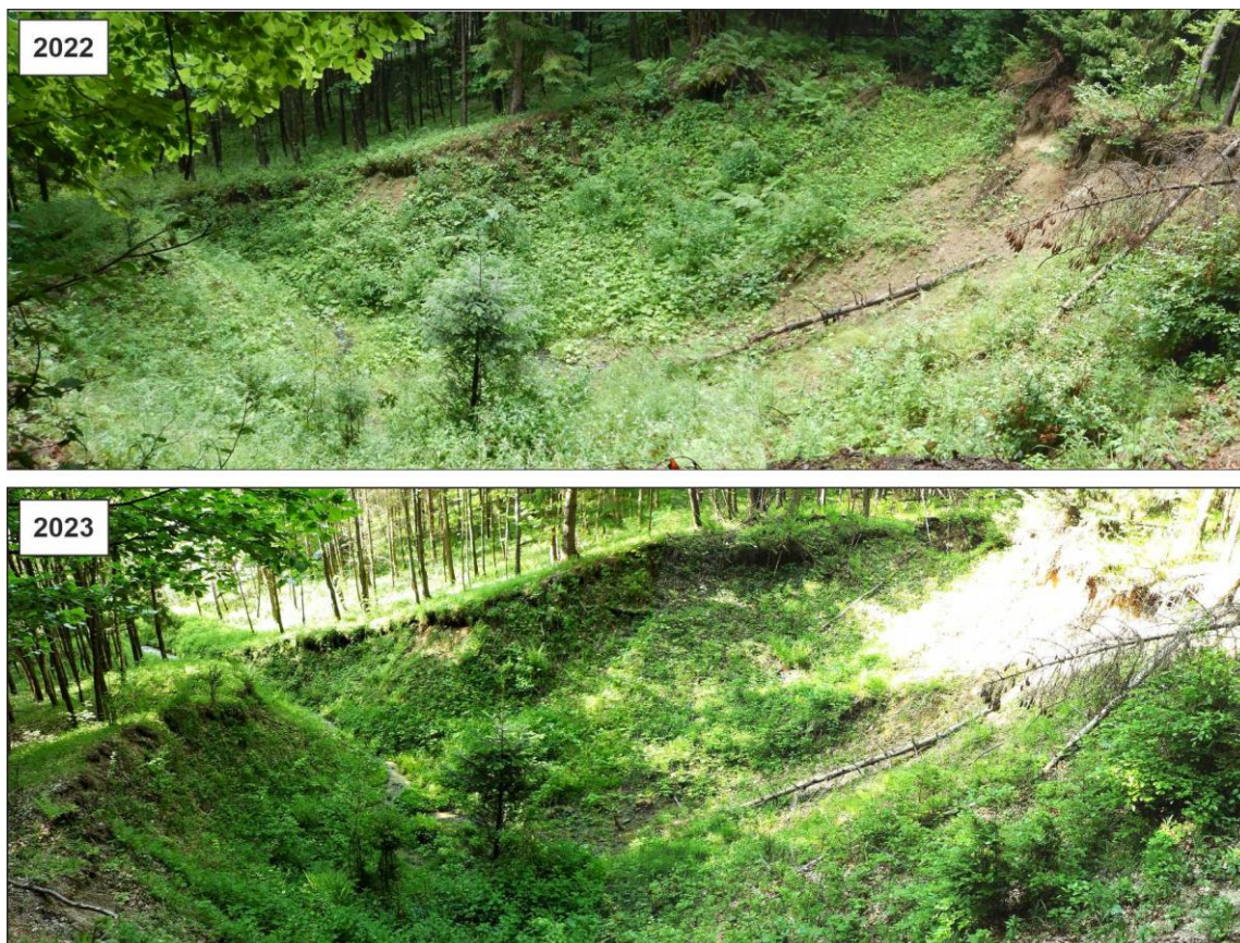
Obr. 4.11.3 Fotografické snímkovania závalov na Novej štôlni. Porovnávacie snímkovania z r. 2022 a z r. 2023: a) zo stanovišťa 1, b) zo stanovišťa 4
