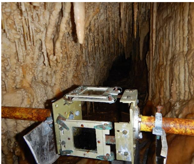
Obr. 35 Inštalácia dilatometra TM-71 v Čarovnej chodbe (Demänovská jaskyňa Slobody)
