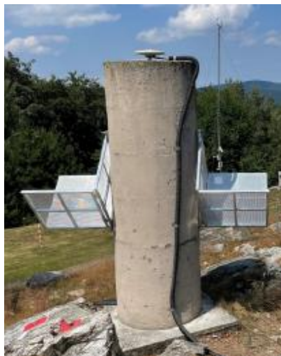
Obr. 4 Kolokačné stanice GNSS a InSAR (GKÚ 2023)
