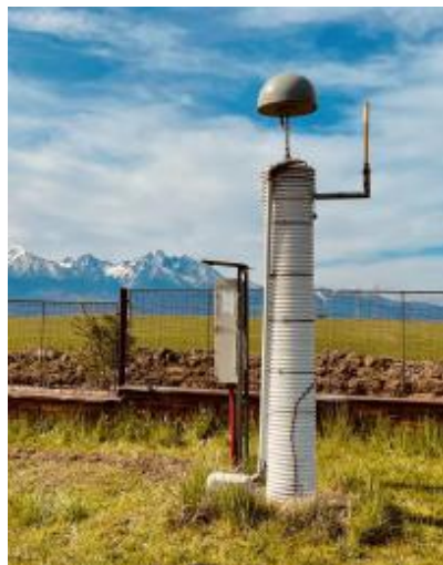
Obr. 4 Kolokačné stanice GNSS a InSAR (GKÚ 2023)
