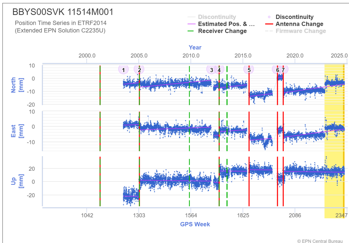
Obr. 26 Znážornenie pohybu bodu BBYS v ETRS89
