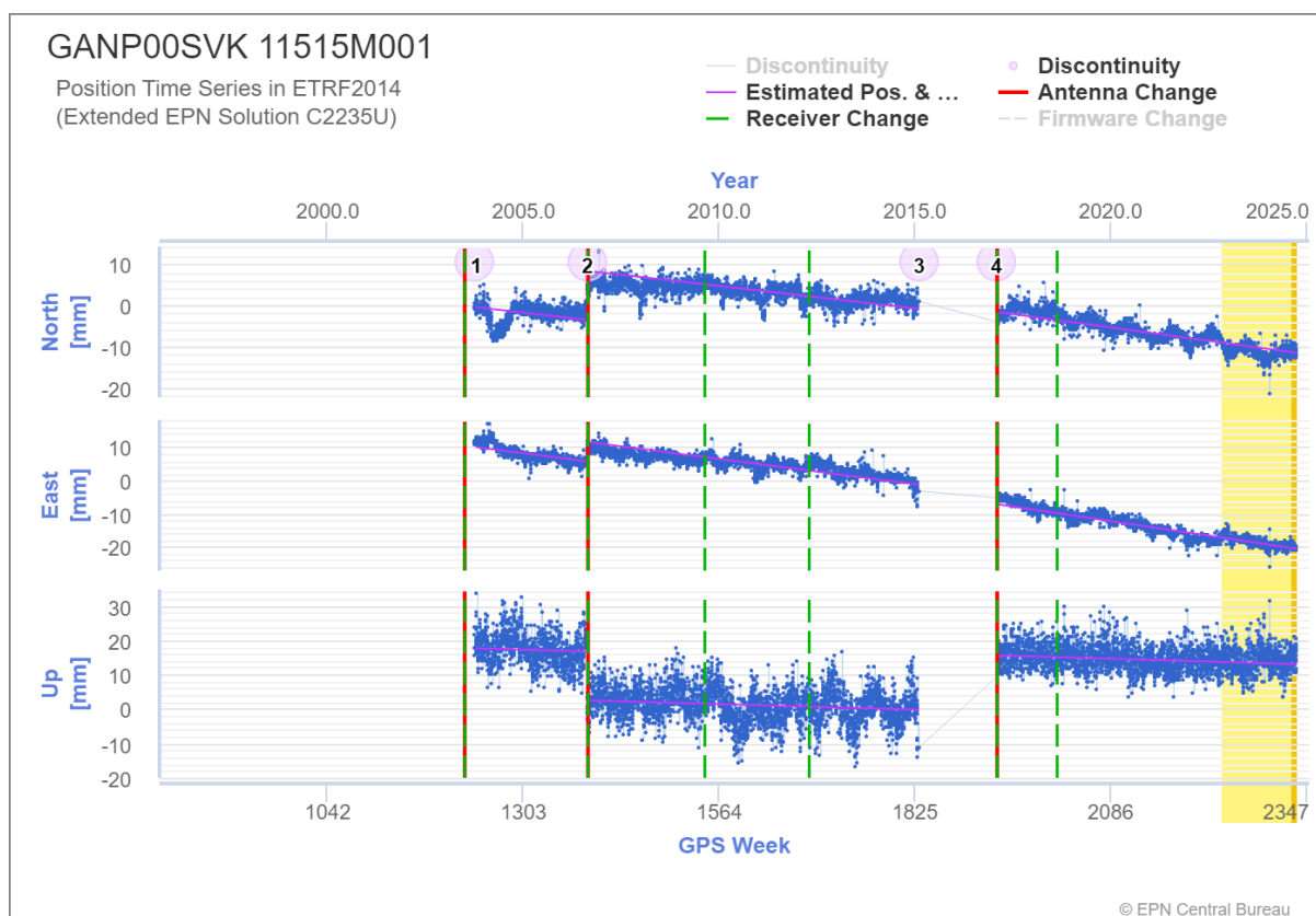
Obr. 25 Znáznornenie pohybu bodu GANP v ETRS89
