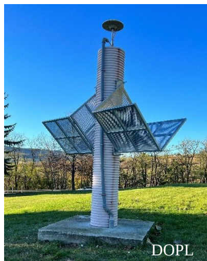
Obr. 4 Kolokačné stanice GNSS a InSAR (GKÚ 2023)
