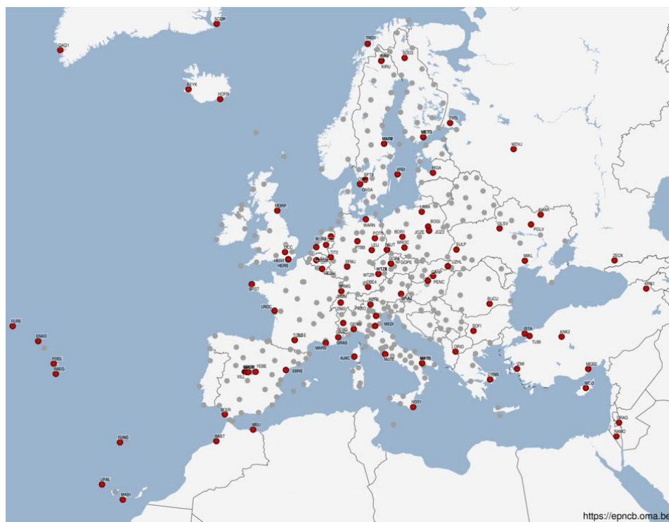
Obr. 7 Rozmiestnenie permanentných staníc EPN k 31. 12. 2023 a výber staníc EPN zaradených do svetovej siete IGS
