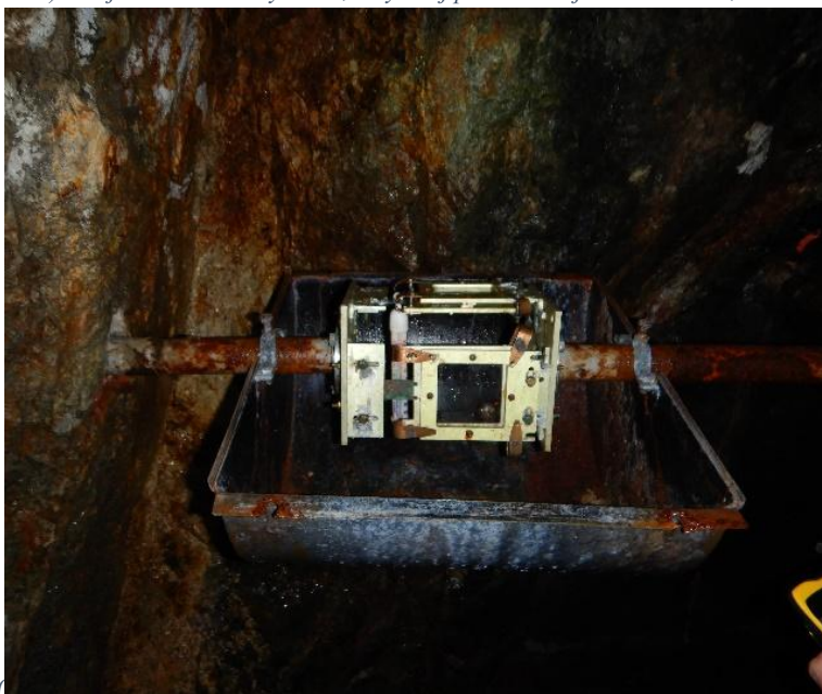
2002 inštalovaný dilatometer TM-71 (
