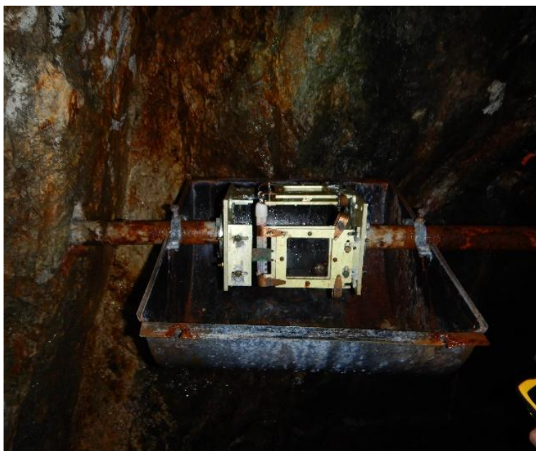
Obr. 36 Inštalácia dilatometra TM-71 v prieskumnej štôlni Izabela na lokalite Ipeľ
