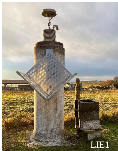
Obr. 4 Kolokačné stanice GNSS a InSAR (GKÚ 2023)
