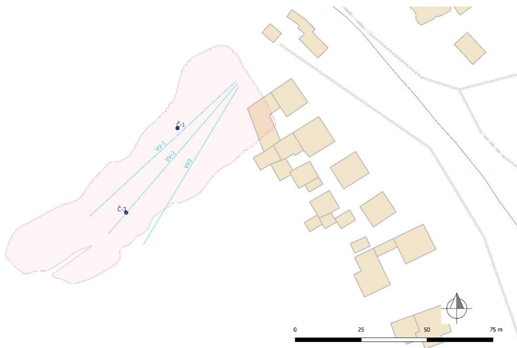
Obr. 4.10.1. Lokalita Čirč – situácia monitorovaných objektov, na ktorých sú zabezpečované režimové pozorovania (objekty označené ako body – piezometrické vrty, objekty označené ako línie – hĺbkové odvodnenie pomocou subhorizontálnych odvodňovacích vrto); ohraničenie zosuvov podľa Šimekovej et al. (2012), mapový podklad: ZBGIS®.
