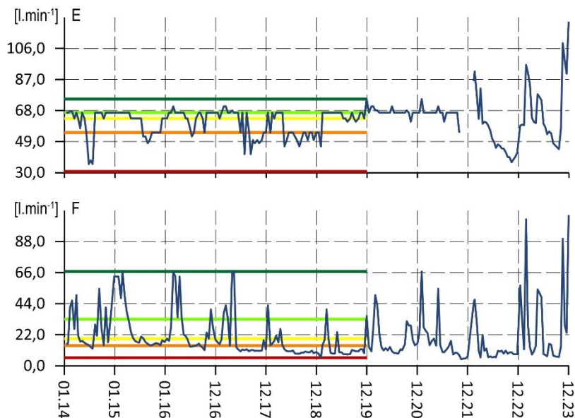
Obr. 4.1.21 Dlhodobý vývoj výdatnosti meraný na odvodňovacích zariadeniach (ústie potrubia zo šácht) E a F na zosuvnej lokalite Handlová-Morovnianske sídlisko (časť Malá Hôrka) v rokoch 2014 a 2023, spolu so základnými štatistickými ukazovateľmi. Modrá – nameraná výdatnosť (prietok na ústí odvodňovacieho zariadenia), červená – minimálna výdatnosť, oranžová – 1. kvartil, žltá – 2. kvartil, bledozelená – 3. kvartil, tmavozelená – maximálna výdatnosť. Štatistické ukazovatele sú odvodené z údajov, ktoré boli namerané na jednotlivých odvodňovacích vrtoch počas referenčného obdobia: roky 2012 – 2019.
