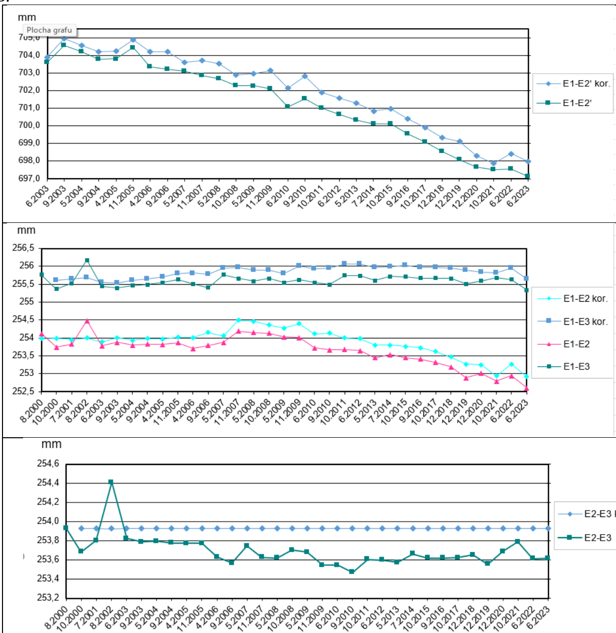
Obr. 4.18.2. Výsledky dlhodobého merania posuvu blokov na lokalite Demjata; A – meradlom posuvov, B – dilatometrom Somet. Grafy s korekciou nameraných hodnôt zohľadňujú zmeny podmienok a techniky merania (označené príponou kor. – údaje v nich sú upravované v závislosti od hodnoty nameranej vzdialenosti medzi bodmi E2-E3, situovanými na jednom samostatnom horninovom bloku).
