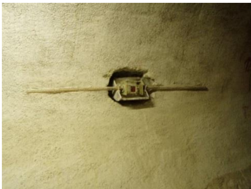
Obr. 33 Inštalácia dilatometra TM-71 v únikovej štôľni tunela Branisko
