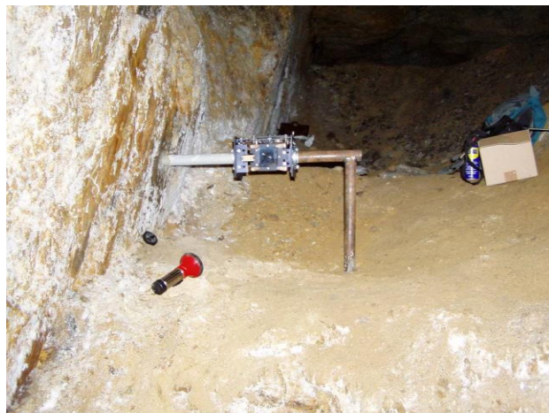
Obr. 36 Inštalácia dilatometra TM-71 v štôľni Starovšechsvätých na lokalite Banská Hodruša - Hámre
