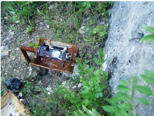
Obr. 38 Inštalácia dilatometra TM-71 na tektonickej poruche v lokalite Dobrá Voda
