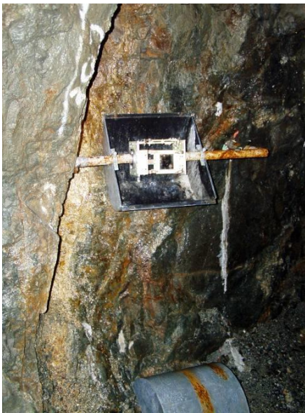
Obr. 35 Inštalácia dilatometra TM-71 v prieskumnej štôľni Izabela v lokalite Ipeľ
