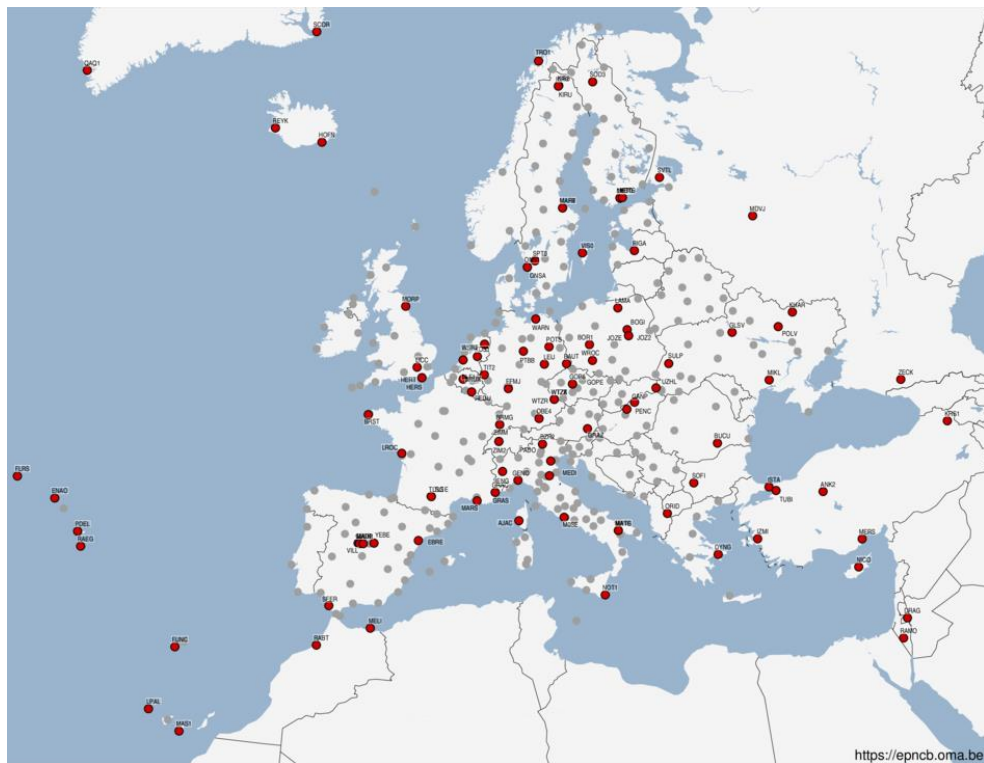
Obr. 6 Rozmiestnenie permanentných staníc EPN k 31.12.2022 a výber staníc EPN zaradených do svetovej siete IGS.
