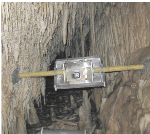
Obr. 34 Inštalácia dilatometra TM-71 v Čarovnej chodbe (Demänovská jaskyňa Slobody)
