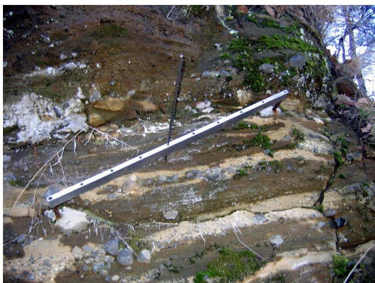
Obr. 4.17.1. Situovanie meradla mikromorfologických zmien povrchu horniny na skalnej stene oproti katastrofálnemu handlovskému zosuvu (lokalita Handlová-Baňa)
