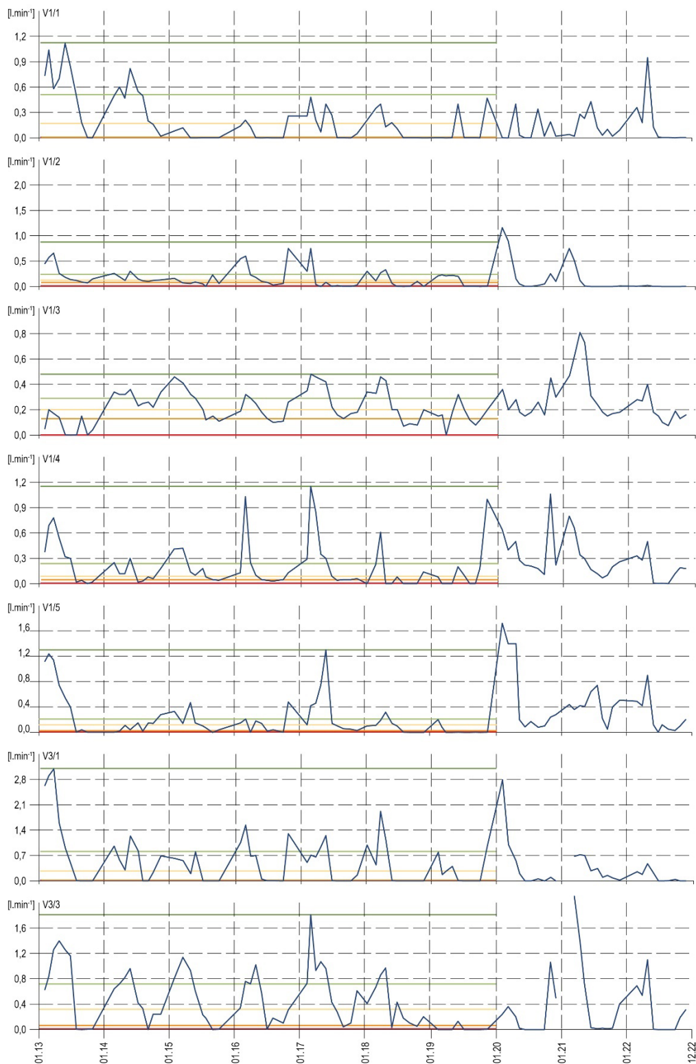
Obr. 4.5.8 Dlhodobý vývoj výdatnosti na vybraných odvodňovacích vrtoch (V1/1, V1/2, V1/3, V1/4, V1/5, V3/1 a V3/3) na zosuvnej lokalite Slanec-TP v rokoch 2013 až 2022, spolu so základnými štatistickými ukazovateľmi. Modrá – nameraná výdatnosť (prietok na ústí odvodňovacieho vrtu), červená – minimálna výdatnosť, oranžová – 1. kvartil, žltá – 2. kvartil, bledozelená – 3. kvartil, tmavozelená – maximálna výdatnosť. Štatistické ukazovatele sú odvodené z údajov, ktoré boli namerané na jednotlivých odvodňovacích vrtoch počas referenčného obdobia: 2012 – 2019.
