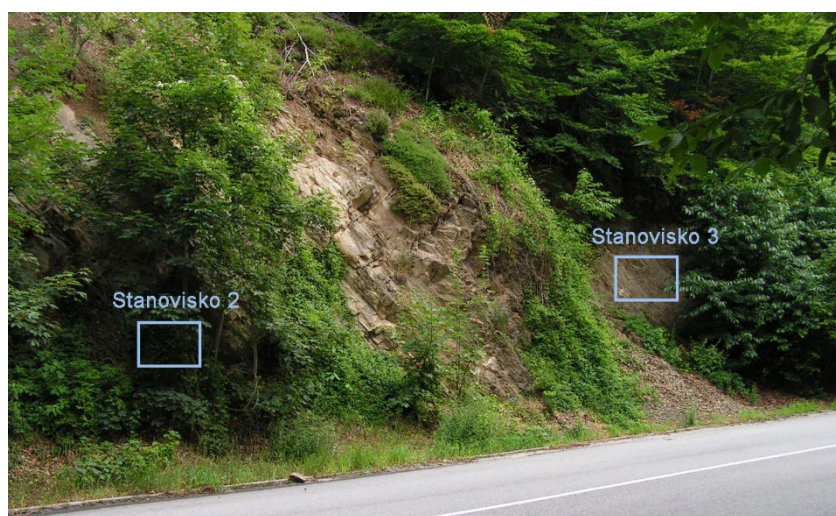
Obr. 4.20.1. Situovanie stanovišť 2 a 3 na lokalite Pezinská Baba na meranie mikromorfologických zmien povrchu horniny na svahu odrezu cesty
