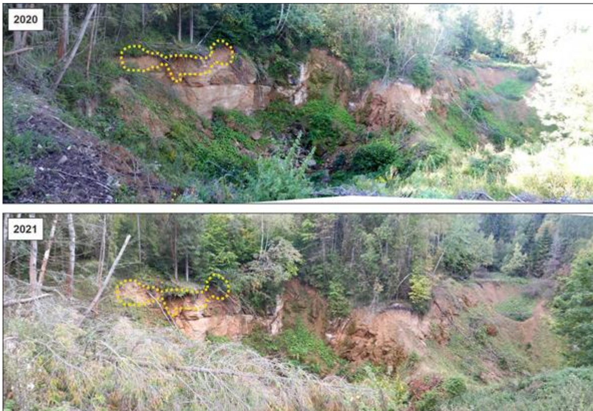
Obr. 4.11.5 Porovnávacie fotografické snímky juhovýchodného okraja závalu Z3 z r. 2020 a 2021 s vyznačením miesta aktivizácie okraja závalu dokumentovanej v r. 2021
