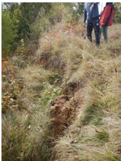
Obr. 4.12.5 Hrana novej retrográdnej odlučnej plochy zosuvu Obr. 4.12.6: Detail novej ťahovo – poklesovej trhliny tla
