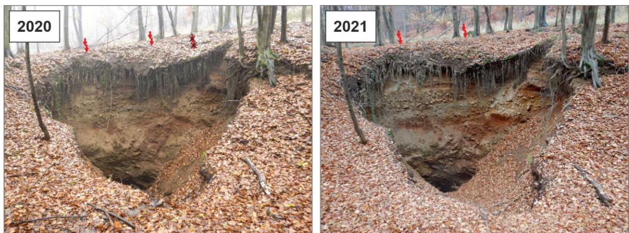
Obr. 4.4.4 Porovnávacie fotografické snímkovanie závalu Z1 nad banskou chodbou štólne Rýhová z r. 2020 a 2021 (pohľad z juhu) s označením situovania monitorovacích kolíkov (červenými šípkami)
