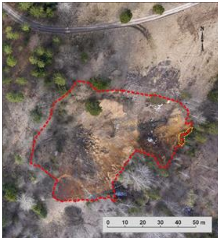
Obr. 4.11.6 Ortofotosnímka závalu Z3 s vyznačením jeho ohraničenia (červená línia) a miesta aktivizácie okraja závalu (žltá línia) dokumentovanej v r. 2021 (snímka - zdroj: súkromný archív, Greisel, 2020)
