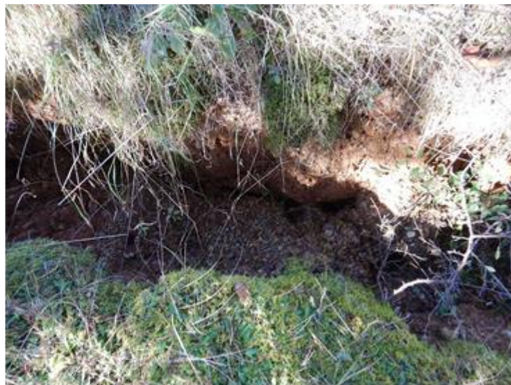
Obr. 4.12.5 Hrana novej retrográdnej odlučnej plochy zosuvu Obr. 4.12.6: Detail novej ťahovo – poklesovej trhliny tla
