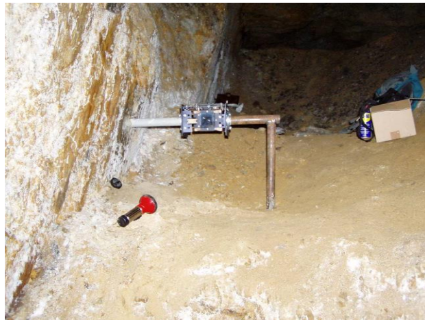
Obr. 31 Inštalácia dilatometra TM-71 v štólne Vŕsechsvätých (stará) na lokalite Banská Hodruša - Hámre
