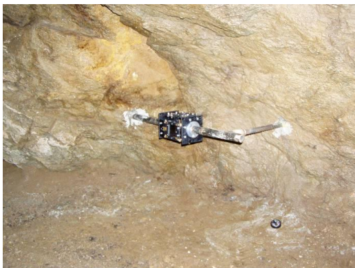
Obr. 32 Inštalácia dilatometra TM-71 v opustenej štólne sv. Anton Paduánsky na lokalite Vyhne
