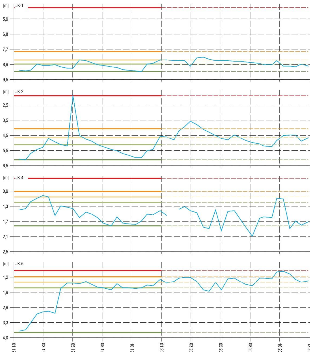
Obr. 4.2.2. Zmeny úrovne hladiny podzemnej vody (HPV) na lokalite Handlová-Kunešovská cesta, namerané v rokoch 2019 a 2020 vo vrtoch: JK-1, JK-2, JK-4 a JK-5, spolu so štatistickým ukazovateľmi, ktoré boli odvodené z údajov o HPV nameranej počas referenčného obdobia (RO: január 2011 – december 2019); červená – maximálna, zelená – minimálna HPV počas RO, bledozelená – 1. kvartil, žltá – 2. kvartil, oranžová – 3. kvartil HPV počas RO.
