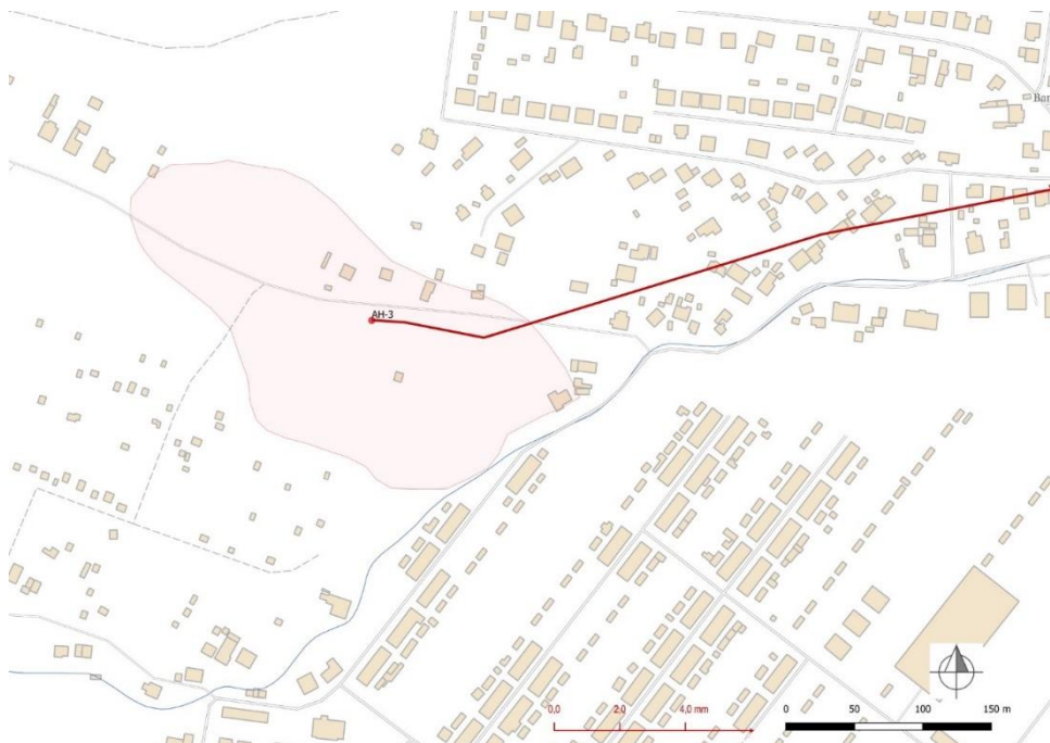
Obr. 4.1.3. Lokalita Handlová-Morovnianske sídlisko (oblasť Jánošíkova cesta) – vektory deformácií namerané v rokoch 2019 a 2020 (obdobia jednotlivých meracích etáp sú v súlade s tab. 4.1.2; hĺbka zaznamenatej deformácie je 6,87 m pod terénom); mapový podklad: ZBGIS®.
