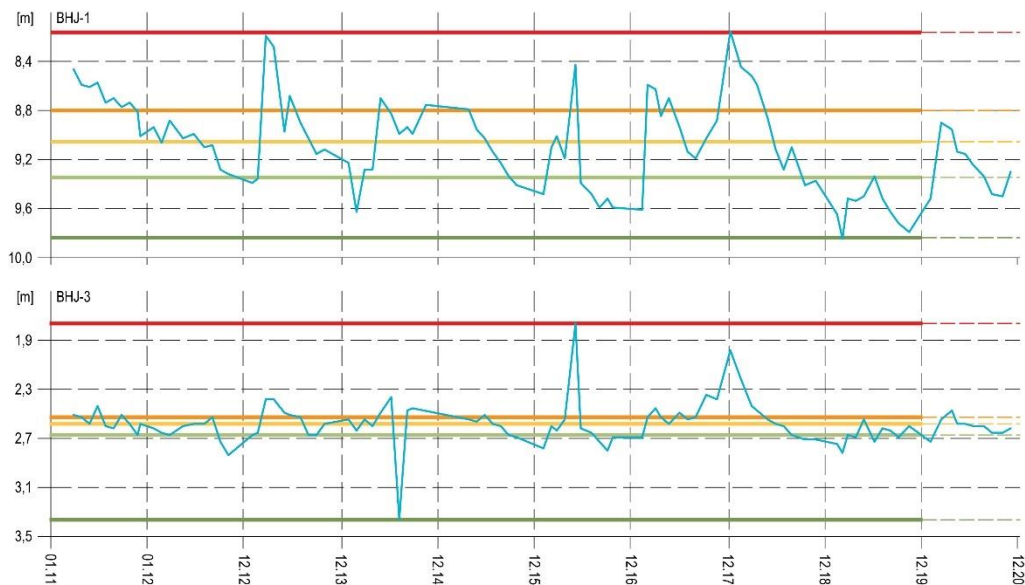
Obr. 4.9.7. Porovnanie úrovne hladiny podzemnej vody (HPV) na lokalite Bardejovská Zábava, nameranej v rokoch 2011 až 2020 vo vrtoch: BHI-1 a BHI-3, so štatistickým ukazovateľmi, ktoré boli odvodené z údajov o HPV nameranej počas referenčného obdobia (RO: marec 2011 – november 2019); červená – maximálna, zelená – minimálna HPV počas RO, bledozelená – 1. kvartil, žltá – 2. kvartil, oranžová – 3. kvartil HPV počas RO.
