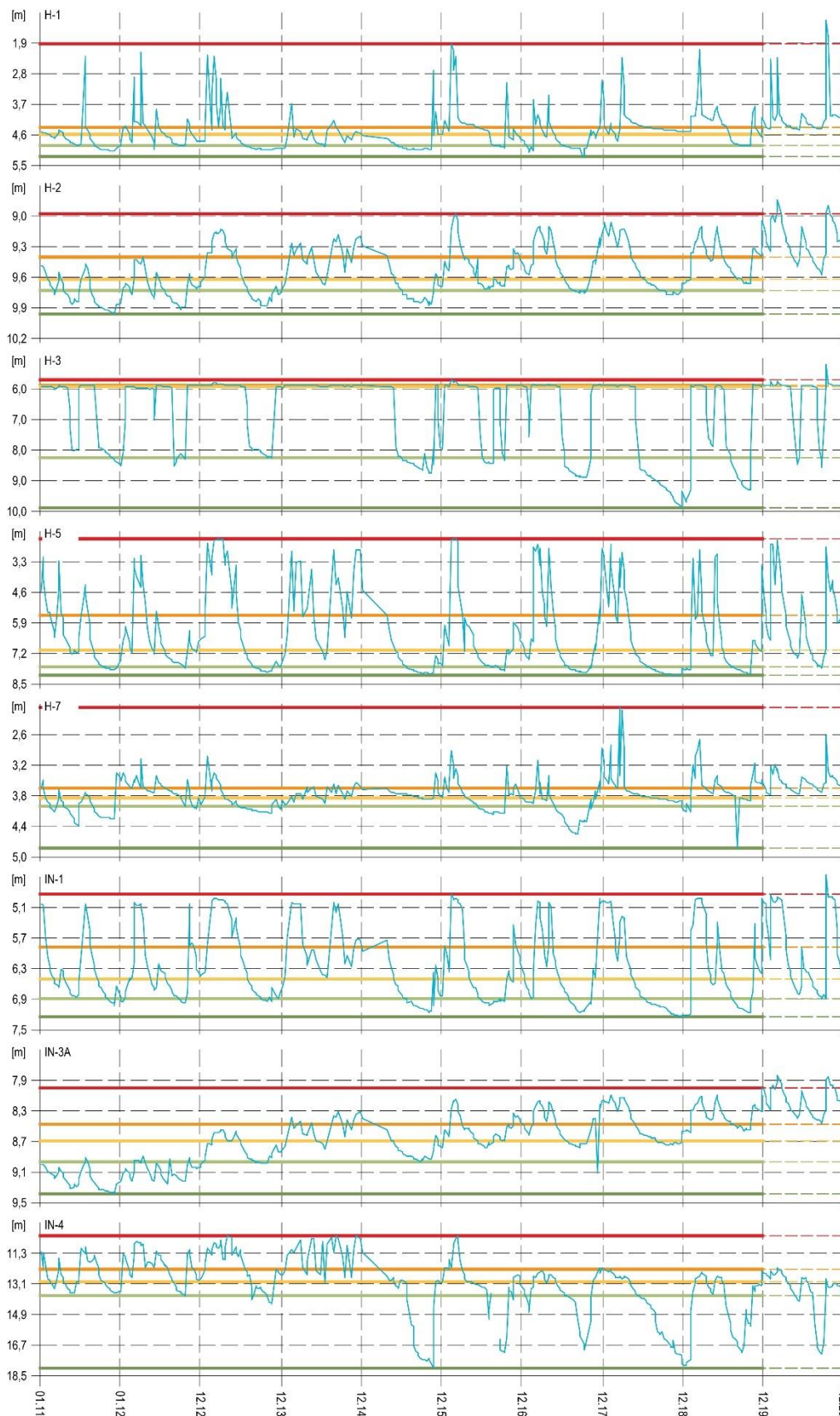
Obr. 4.23.8. Porovnanie úrovne hladiny podzemnej vody (HPV) na lokalite Handlová-Stabilizačný násyp, nameranej v rokoch 2011 až 2020 vo vrtoch: H-1, H-2, H-3, H-5, H-7, IN-1, IN-3A, IN-4, so štatistickým ukazovateľmi, ktoré boli odvodené z údajov o HPV nameranej počas referenčného obdobia (RO: január 2011 – december 2019); červená – maximálna, zelená – minimálna HPV počas RO, bledozelená – 1. kvartil, žltá – 2. kvartil, oranžová – 3. kvartil HPV počas RO.
