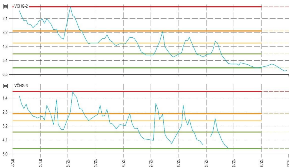
Obr. 4.11.6. Porovnanie úrovne hladiny podzemnej vody (HPV) na lokalite Vyšný Čaj, nameranej v rokoch 2011 až 2020 vo vrtoch: VČHG-2 a VČHG-3, so štatistickými ukazovateľmi, ktoré boli odvodené z údajov o HPV nameranej počas referenčného obdobia (RO: marec 2011 – december 2019); červená – maximálna, zelená – minimálna HPV počas RO, bledozelená – 1. kvartil, žltá – 2. kvartil, oranžová – 3. kvartil HPV počas RO.
