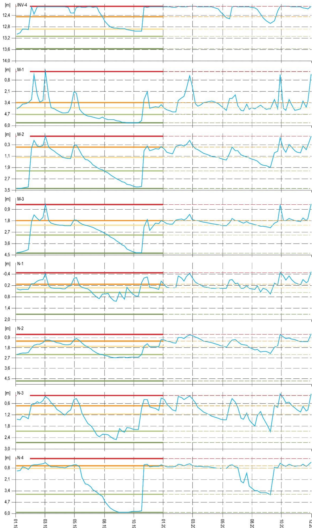
Obr. 4.23.6. Porovnanie úrovne hladiny podzemnej vody (HPV) na lokalite Handlová-Stabilizačný násyp, nameranej v rokoch 2019 a 2020 vo vrtoch: INV-4, M-1, M-2, M-3, N-1, N-2, N-3 a N-4, so štatistickým ukazovateľmi, ktoré boli odvodené z údajov o HPV nameranej počas referenčného obdobia (RO: január 2011 – december 2019); červená – maximálna, zelená – minimálna HPV počas RO, bledozelená – 1. kvartil, žltá – 2. kvartil, oranžová – 3. kvartil HPV počas RO.
