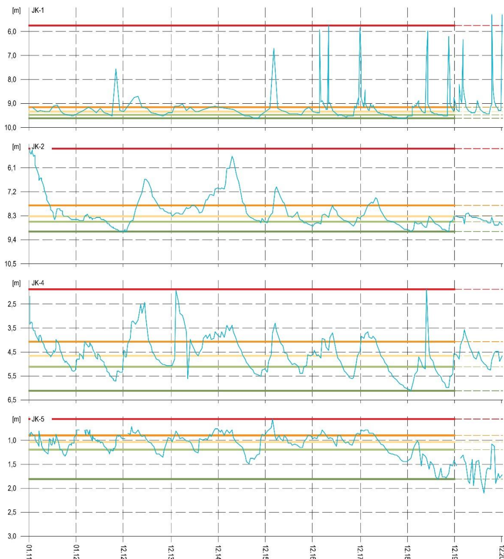
Obr. 4.2.4. Dlhodobé zmeny úrovne hladiny podzemnej vody (HPV) na lokalite Handlová-Kunešovská cesta, namerané v rokoch 2011 až 2020 vo vrtoch: JK-1, JK-2, JK-4 a JK-5, spolu so štatistickým ukazovateľmi, ktoré boli odvodené z údajov o HPV nameranej počas referenčného obdobia (RO: január 2011 – december 2019); červená – maximálna, zelená – minimálna HPV počas RO, bledozelená – 1. kvartil, žltá – 2. kvartil, oranžová – 3. kvartil HPV počas RO.
