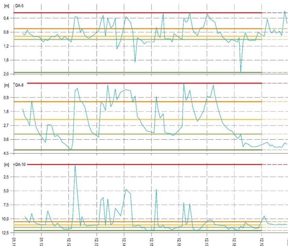
Obr. 4.8.10. Dlhodobé zmeny úrovne hladiny podzemnej vody (HPV) na lokalite Ďačov v rokoch 2011 až 2020 vo vrtoch: DA-5, DA-8 a DA-10, so štatistickým ukazovateľmi, ktoré boli odvodené z údajov o HPV nameranej počas referenčného obdobia (RO: apríl 2011 – november 2019); červená – maximálna, zelená – minimálna HPV počas RO, bledozelená – 1. kvartil, žltá – 2. kvartil, oranžová – 3. kvartil HPV počas RO.
