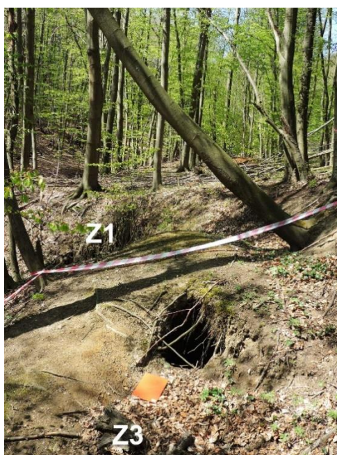
Obr. 17: Pokles povrchu terénu medzi závalmi Z1 a Z3.
