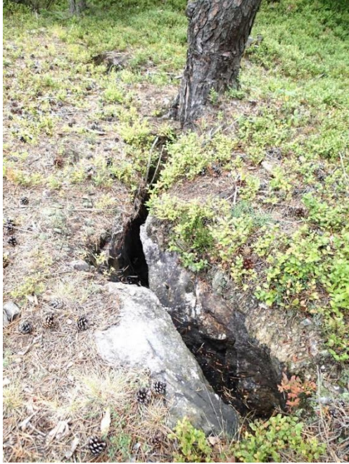
Obr. 30: Trhliny v oblasti poklesového bloku B4: a) (vľavo) otvorená ťahová trhlina, b) (vpravo) trhlina s výrazným poklesovým prejavom.
