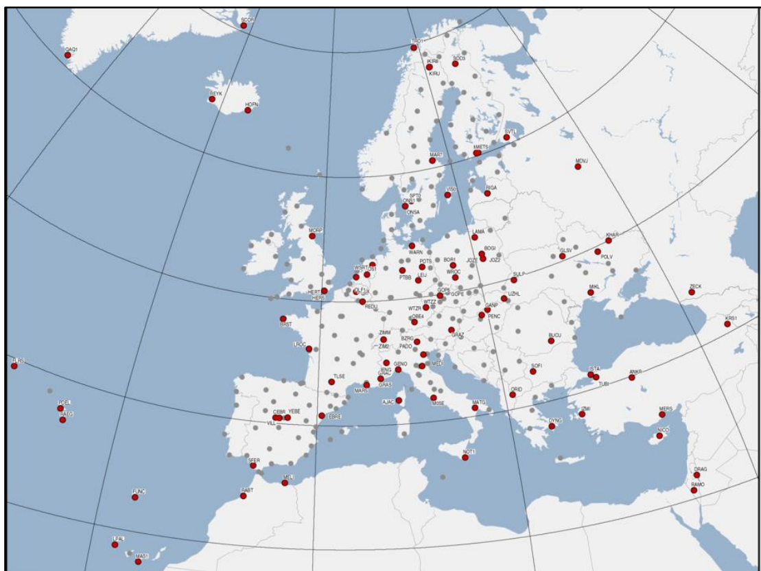
Obr. 6 Rozmiestnenie permanentných staníc EPN k 31.12.2019 a výber staníc EPN zaradených do svetovej siete IGS.
