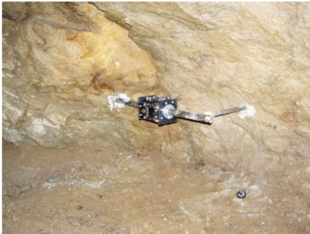
Obr. 32 Inštalácia dilatometra TM-71 v opustenej štôlni sv. Anton Paduánsky na lokalite Vyhne
