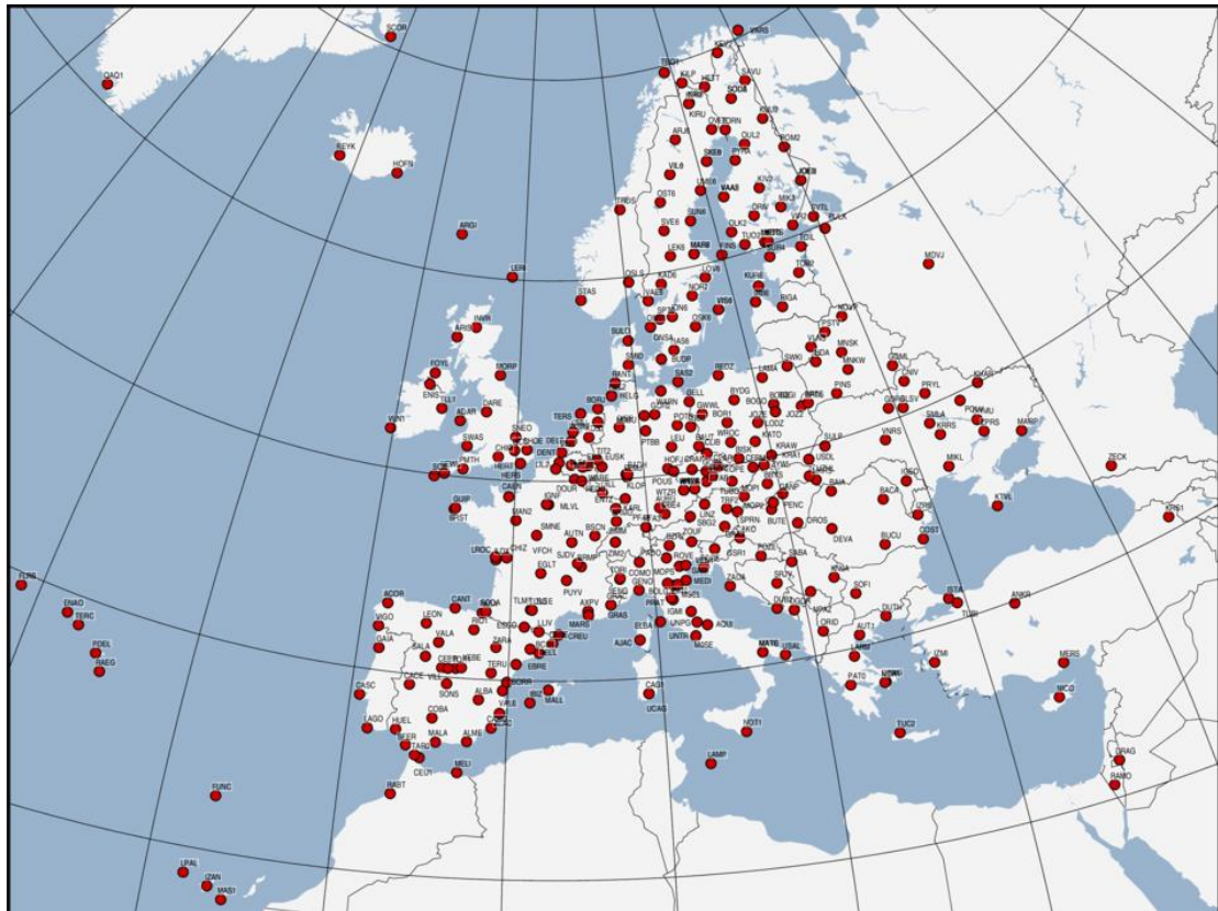
Obr. 5 Rozmiestnenie permanentných staníc EPN k 31.12.2019
