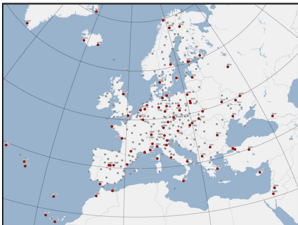
Obr. 6 Rozmiestnenie permanentných staníc EPN k 31. 12. 2017 a výber staníc EPN zaradených do svetovej siete IGS .
