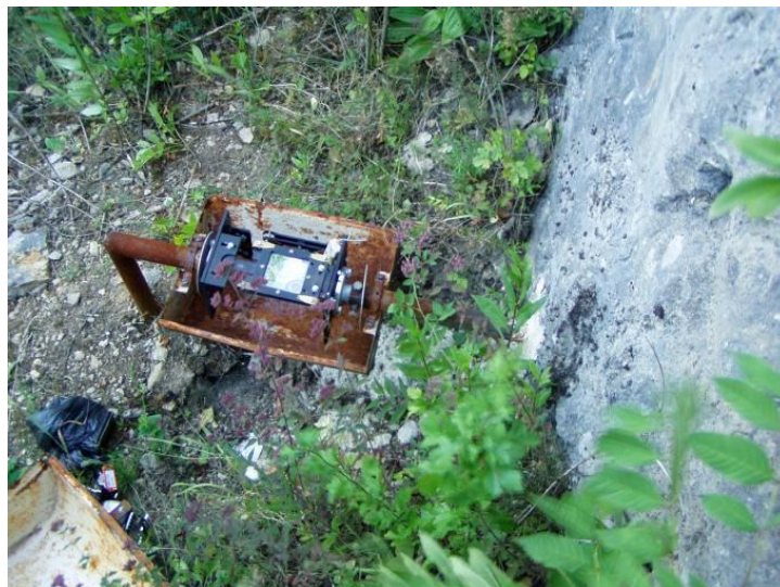
Obr. 33 Inštalácia dilatometra TM-71 na tektonickej poruche na lokalite Dobrá Voda
