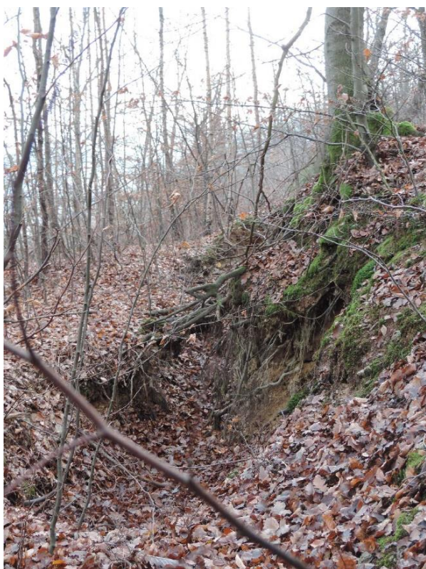
Obr. 38: Aktívna trhlina západne od závalu Z10 s viditeľným napnutým koreňom stromu
