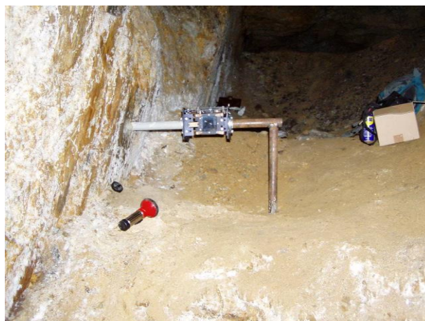
Obr. 19 Inštalácia dilatometra TM-71 v opustenej štôlni Vŕechsvätých (stará) na lokalite Banská Hodruša (Hámre)
