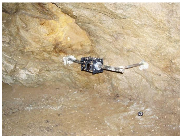
Obr. 20 Inštalácia dilatometra TM-71 v opustenej štôlni sv. Anton Paduánsky na lokalite Vyhne
