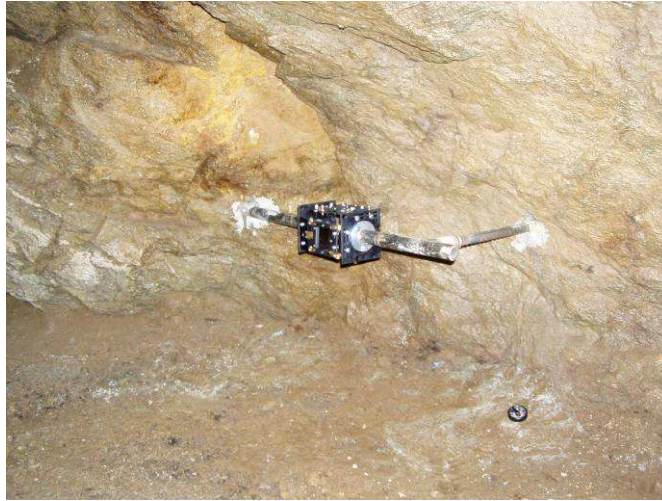
Obr. 21 Inštalácia dilatometra TM-71 v opustenej štôlni sv. Anton Paduánsky na lokalite Vyhne
