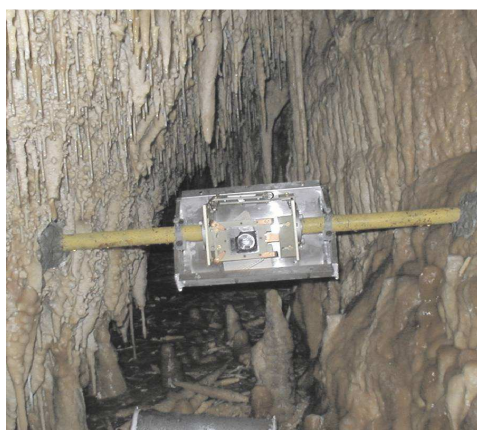
Obr. 18 Inštalácia dilatometra TM-71 v Čarovnej chodbe (Demänovská jaskyňa Slobody)
