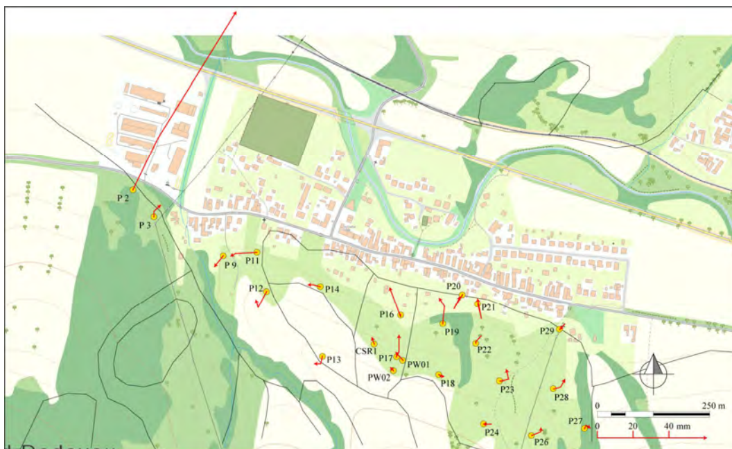
Obr. 4.3.1. Lokalita Velká Čausa – výsledky geodetických (terestrických) meraní za roky 2014 a 2015 (obdobia jednotlivých meraní sú v súlade s tab. 4.3.2); obrysy zosuvov podľa Šimekovej a Martinčekovej et al. (2006), mapový podklad: ZBGIS®
