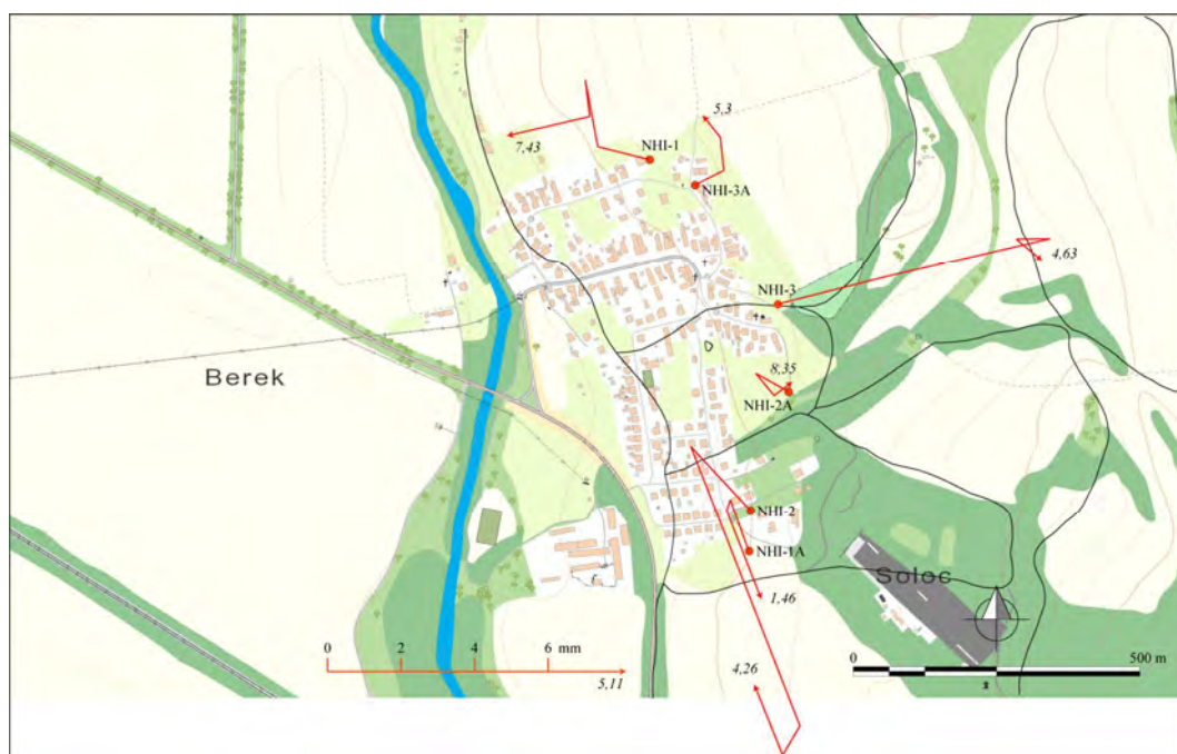
Obr. 4.25.1. Lokalita Nižná Hutka – výsledky inklinometrických meraní za roky 2014 a 2015 (obdobia jednotlivých meraní sú v súlade s tab. 4.25.2; čísla zobrazené pri jednotlivých vektoroch označujú hĺbku zaznamenananej deformácie od povrchu terénu v m); obrysy zosuvov podľa Grmana et al. (2010), mapový podklad: ZBGIS®
