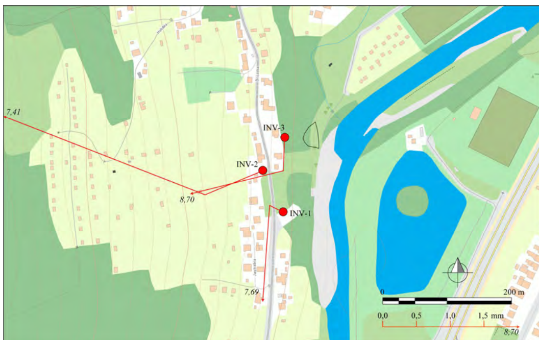
Obr. 4.18.1. Lokalita Žilina-Vranie – výsledky inklinometrických meraní v období rokov 2014 a 2015 (obdobie meracej etapy je v súlade s tab. 4.18.2; číslo zobrazené pri vektore označuje hĺbku zaznamenananej deformácie od povrchu terénu v m); mapový podklad: ZBGIS®
