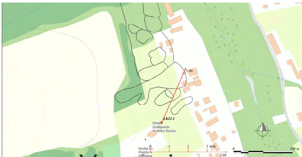
Obr. 4.21.1. Lokalita Lukov – výsledky inklinometrických meraní v roku 2015 (obdobie meracej etapy je v súlade s tab. 4.21.2; zobrazené číslo označuje hĺbku zaznamenananej deformácie od povrchu terénu v m); ohraničenie zosuvu podľa Havča et al. (2010), mapový podklad: ZBGIS®
