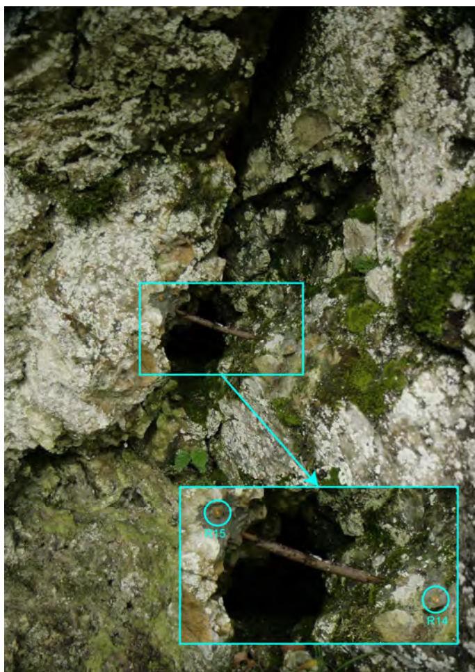
Obr. 4.40.2. Umiestnenie pozorovacích bodov R14 a R15 (Stanovište 2) pre merania dilatometrom Somet na lokalite Pod večným dažďom (Slovenský raj)
