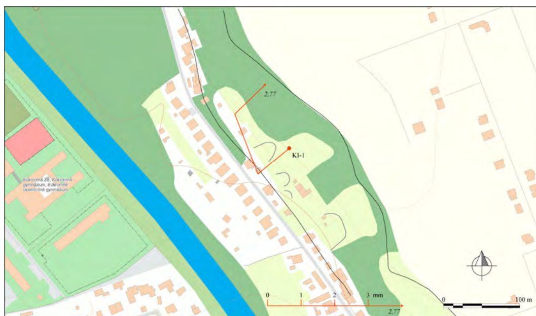
Obr. 4.28.1. Lokalita Košice-Krásna – výsledky inklinometrických meraní v rokoch 2014 a 2015 (obdobia jednotlivých meracích etáp sú v súlade s tab. 4.28.2; číslo zobrazené pri poslednom etapovom vektore označuje hĺbku zaznamenananej deformácie od povrchu terénu v m); obrysy zosuvov podľa Grmana et al. (2010), mapový podklad: ZBGIS®
