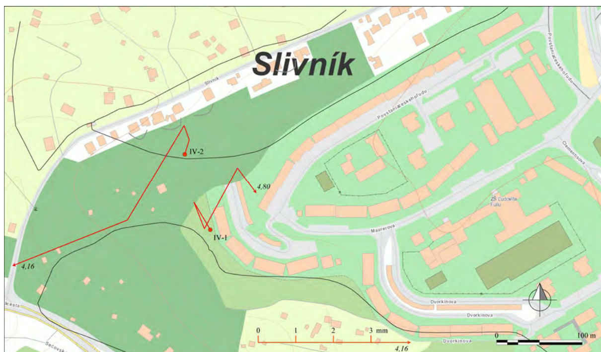
Obr. 4.27.1. Lokalita Košice-sídliisko Dargovských hrdinov výsledky inklinometrických meraní za roky 2014 a 2015 (obdobia jednotlivých meraní sú v súlade s tab. 4.27.2; čísla zobrazené pri jednotlivých vektoroch označujú hĺbku zaznamenananej deformácie od povrchu terénu v m); obrysy zosuvov podľa Grmana et al. (2010), mapový podklad: ZBGIS®
