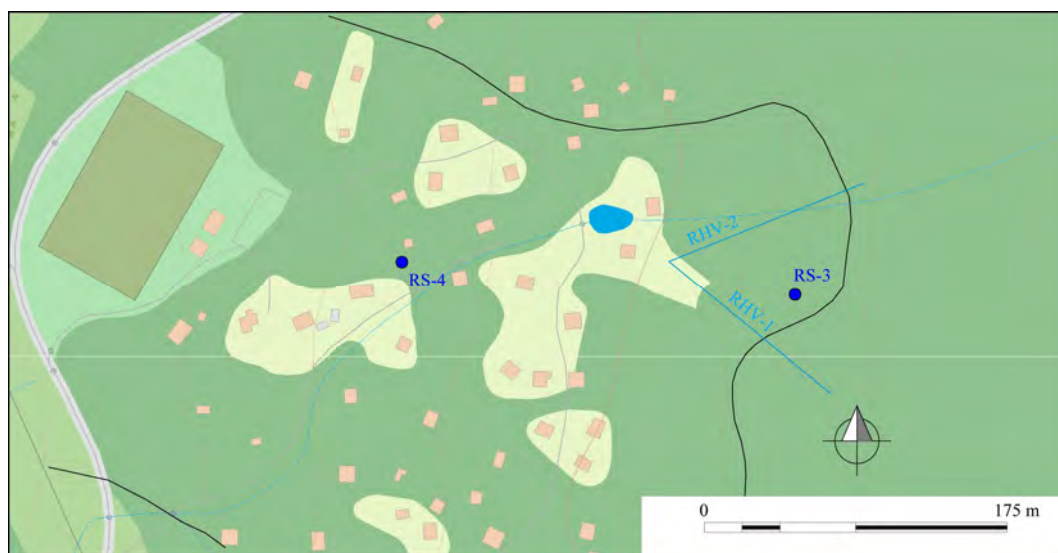
Obr. 4.26.4. Lokalita Ruská Nová Ves – situácia sanačných a monitorovacích objektov; ohraničenie zosuvu podľa Grecha (2012), mapový podklad: ZBGIS®
