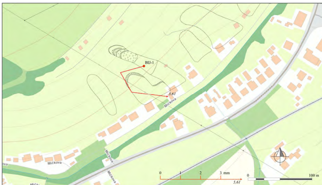
Obr. 4.16.1. Lokalita Bardejovská Zábava – výsledky inklinometrických meraní v rokoch 2014 a 2015 (obdobia jednotlivých meracích etáp sú v súlade s tab.4.15.2; čísla zobrazené pri jednotlivých vektoroch označujú hĺbku zaznamenananej deformácie od povrchu terénu v m); obrisy zosuvov podľa Havča (2012), mapový podklad: ZBGIS ®
