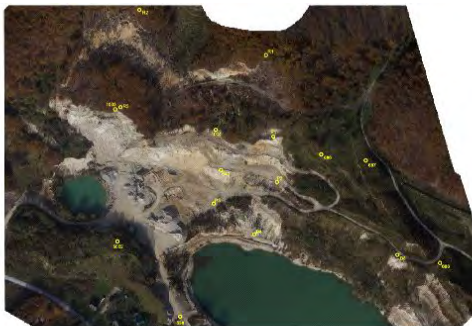
Obr. 4.31.1. Situácia monitorovaných objektov a vektory ich pohybu
