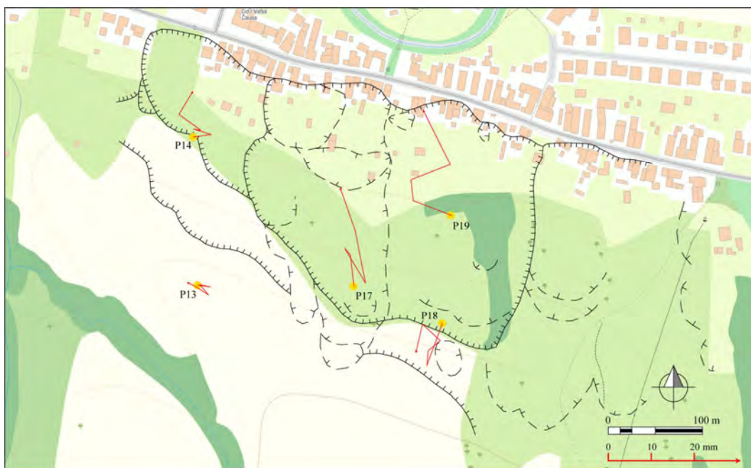
Obr. 4.3.3. Lokalita Veľká Čausa – výsledky geodetických meraní (GNSS) za obdobie rokov 2014 a 2015. Obdobia jednotlivých meracích etáp sú v súlade s tab. 4.3.3; mapový podklad: ZBGIS®
