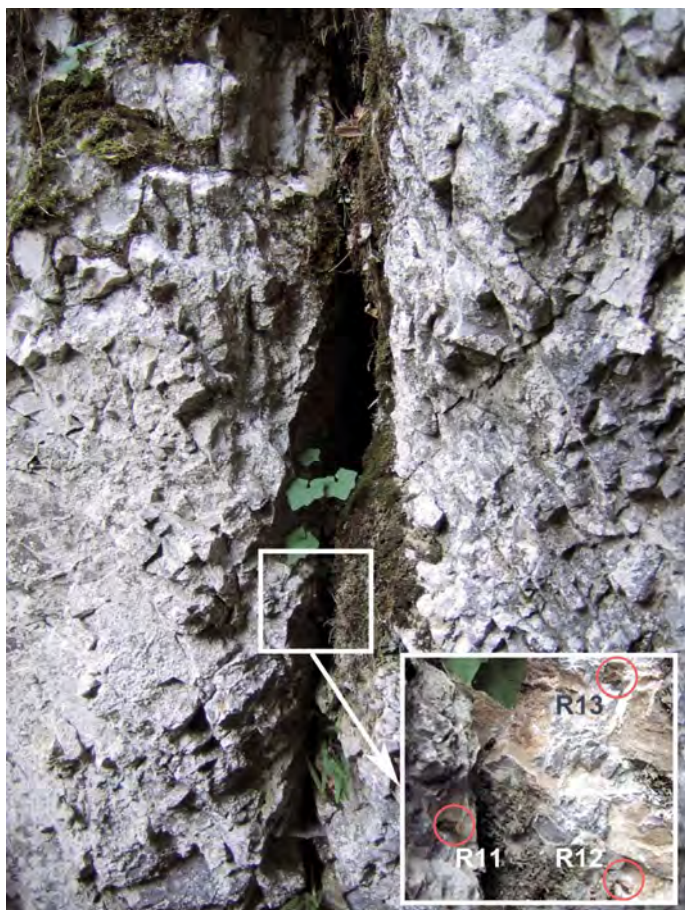
Obr. 4.40.1. Umiestnenie pozorovacích bodov R11, R12 a R13 (Stanovište 1) pre merania dilatometrom Somet na lokalite Pod večným dažďom (Slovenský raj)
