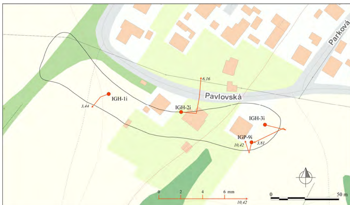
Obr. 4.4.1. Lokalita Prievidza-Hradec (Pavlovská ul.) – výsledky inklinometrických meraní. Červená – vektory deformácií namerané v rokoch 2014 až 2015 (obdobia jednotlivých meracích etáp sú v súlade s tab. 4.4.2; zobrazené čísla pri vektoroch predstavujú hĺbku zaznamenananej deformácie od povrchu terénu v m; mapový podklad: ZBGIS®)
