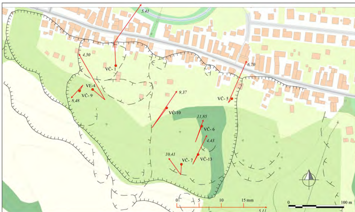
Obr. 4.3.5. Lokalita Velká Čausa – výsledky inklinometrických meraní v rokoch 2014 a 2015 (obdobia jednotlivých meracích etáp sú v súlade s tab. 4.3.5; čísla zobrazené pri jednotlivých vektoroch označujú hĺbku zaznamenananej deformácie od povrchu terénu v m); obrysy zosuvov podľa Jadroňa a Mokrej (1999), mapový podklad: ZBGIS®
