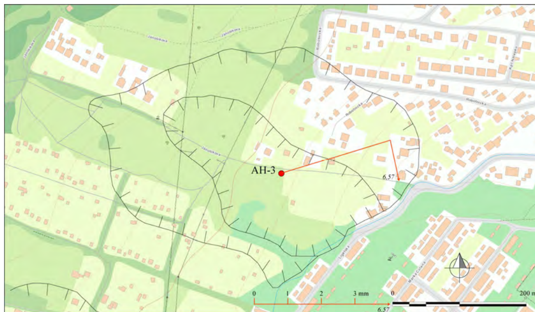
Obr. 4.6.1. Handlová-Morovnianske sídlisko (oblasť Jánošíkovej cesty) – výsledky inklinometrických meraní za rok 2015 (obdobia jednotlivých meraní sú v súlade s tab. 4.6.2; čísla zobrazené pri jednotlivých vektoroch označujú hĺbku zaznamenananej deformácie od povrchu terénu v m); mapový podklad: ZBGIS®
