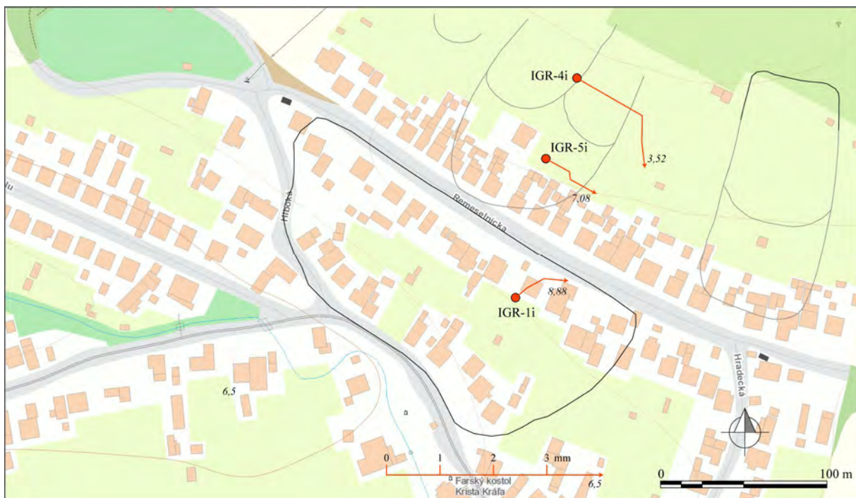
Obr. 4.5.1. Lokalita Velká Lehôtka, Remeselnícká ul. – výsledky inklinometrických meraní – vektory deformácií namerané v rokoch 2014 a 2015 (obdobia meracích etáp sú v súlade s tab. 4.5.2; čísla zobrazené pri jednotlivých vektoroch označujú hĺbku zaznamenananej deformácie od ústia pažnice v m); ohraničenie zosuvu: Fekeč a Ilkanič, 2014b in Šimeková et al., 2014, mapový podklad: ZBGIS®
