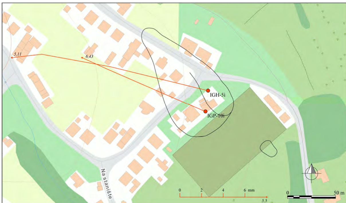
Obr. 4.4.2. Lokalita Prievidza-Hradec (ul. Na Stanište) – výsledky inklinometrických meraní. Červená – vektory deformácií namerané v rokoch 2014 až 2015 (obdobia jednotlivých meracích etáp sú v súlade s tab. 1.2; zobrazené čísla pri vektoroch predstavujú hĺbku zaznamenananej deformácie od povrchu terénu v m; mapový podklad: ZBGIS®)
