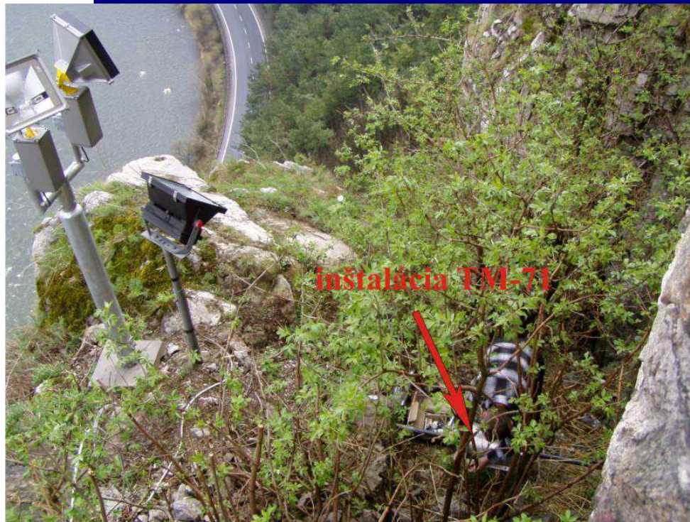
Obr. 22 Pozícia dilatometra TM 71 v trhline pod kaplnkou Strečnianskeho hradu.
