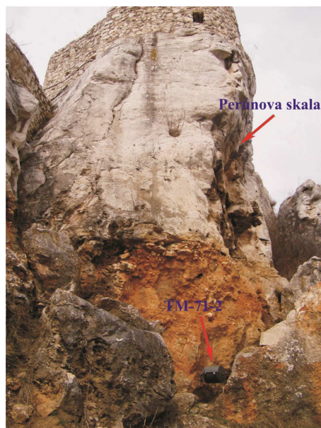
Obr. 10 Inštalácia dilatometra TM 71-2 v trhlíne pod Perúnovou skalou (vchod do Podhradskej jaskyne).
