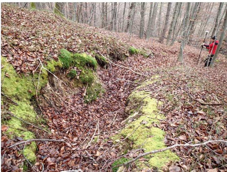
Obr. 11: Ťahovo-poklesová trhlina s prevažujúcim ťahovým charakterom v severozápadnej časti oblasti závalov.
