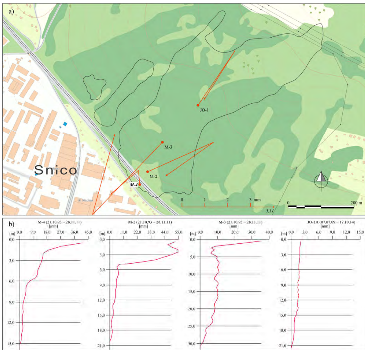
Obr. 1.66. Lokalita Okoličné – výsledky inklinometrických meraní. a – vektory deformácií, namerané v rokoch 2013 a 2014 (obdobia jednotlivých meracích etáp sú v súlade s prílohou 1.13; čísla zobrazené pri jednotlivých vektoroch označujú hĺbku zaznamenananej deformácie od povrchu terénu v m), b – výsledná deformácia inklinometrickej pažnice za dlhšie časové obdobie; obrysy zosuvov podľa: Fussgängera a Jadroňa (1977), mapový podklad: ZBGIS®
