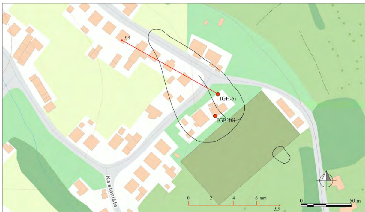
Obr. 1.46. Lokalita Hradec, ulica Na Stanište – výsledky inklinometrických meraní – vektory deformácií namerané v roku 2014 (obdobie meracej etapy je v súlade s prílohou 1.7; čísla zobrazené pri jednotlivých vektoroch označujú hĺbku zaznamenananej deformácie od ústia pažnice v m); ohraničenie zosuvu podľa Fekčá a Ilkaniča (2014b in Šimeková et al., 2014), mapový podklad: ZBGIS®
