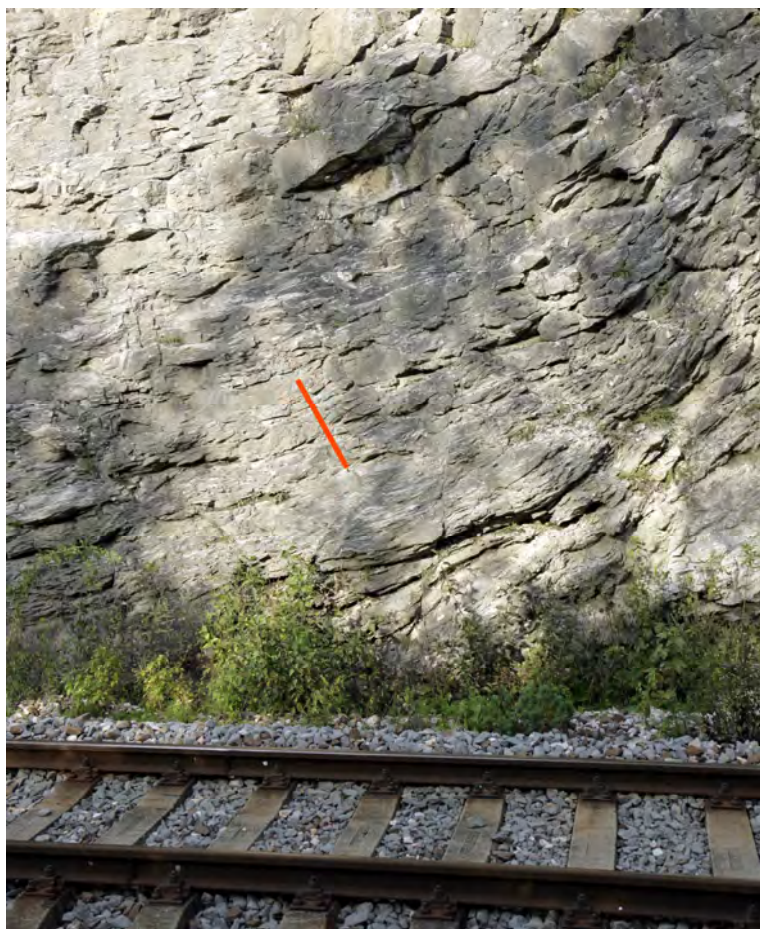
Obr. 1.186. Umiestnenie stanoviska na meranie mikromorfologických zmien povrchu odkrytého zárezu železnice pri obci Jakub. Červenou líniou je zvýraznené stanovisko umiestnenia meradla morfológických zmien
