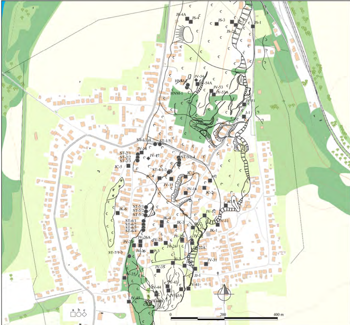
Obr. 1.35. Lokalita Nižná Myšľa – sieť monitorovacích objektov pre režimové pozorovania. Monitorovacie objekty: a – pozorované vertikálne vrty, b – subhorizontálne odvodňovacie vrty, c – vrty s automatickými hladinomermi; ohraničenie zosuvu: Sláma et al. (2012), mapový podklad: ZBGIS®
