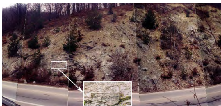
Obr. 1.192. Skalná stena odrezu cesty na lokalite Lipovník (s detailom umiestnenia meradla mikromorfologických zmien – foto L. Petro, 2006)
