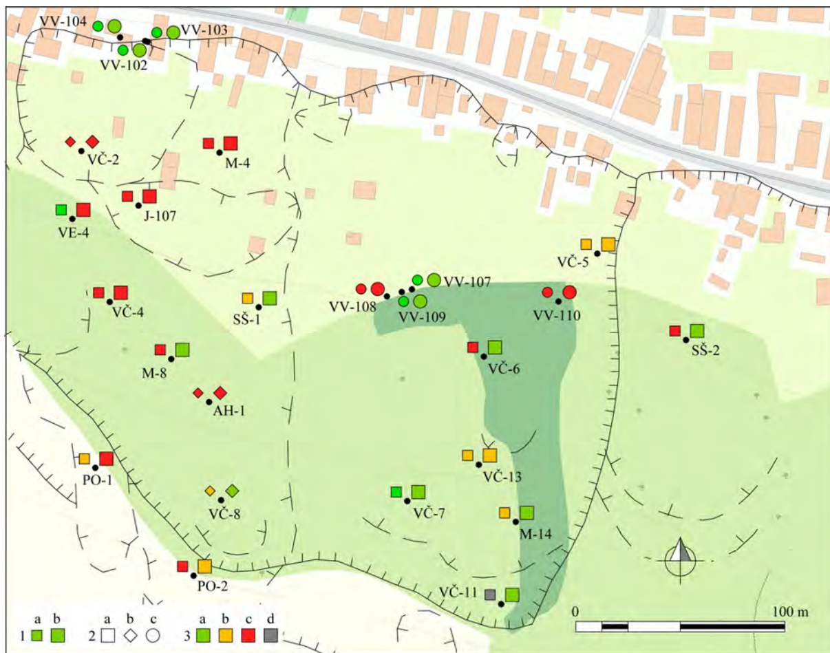
Obr. 1.11. Lokalita Velká Čausa – výsledky režimových pozorování. 1 – režimové pozorování změn hloubky hladiny podzemní vody a výdatností odvodňovacích zařízení v letech: a – 2013, b – 2014, 2 – monitorovací objekty: a – piezometrické vrty měřené pozorovatelem, b – vrty s instalovanými automatickými hladinoměry, c – odvodňovací subhorizontálně vrty, 3 – hodnocení režimových ukazovatelů podle kritérií, zhrnutých v tab. 1.6 (d – nehodnocený); obrysy zosuvov podľa Jadroňa a Mokrej (1999), mapový podklad: ZBGIS®
