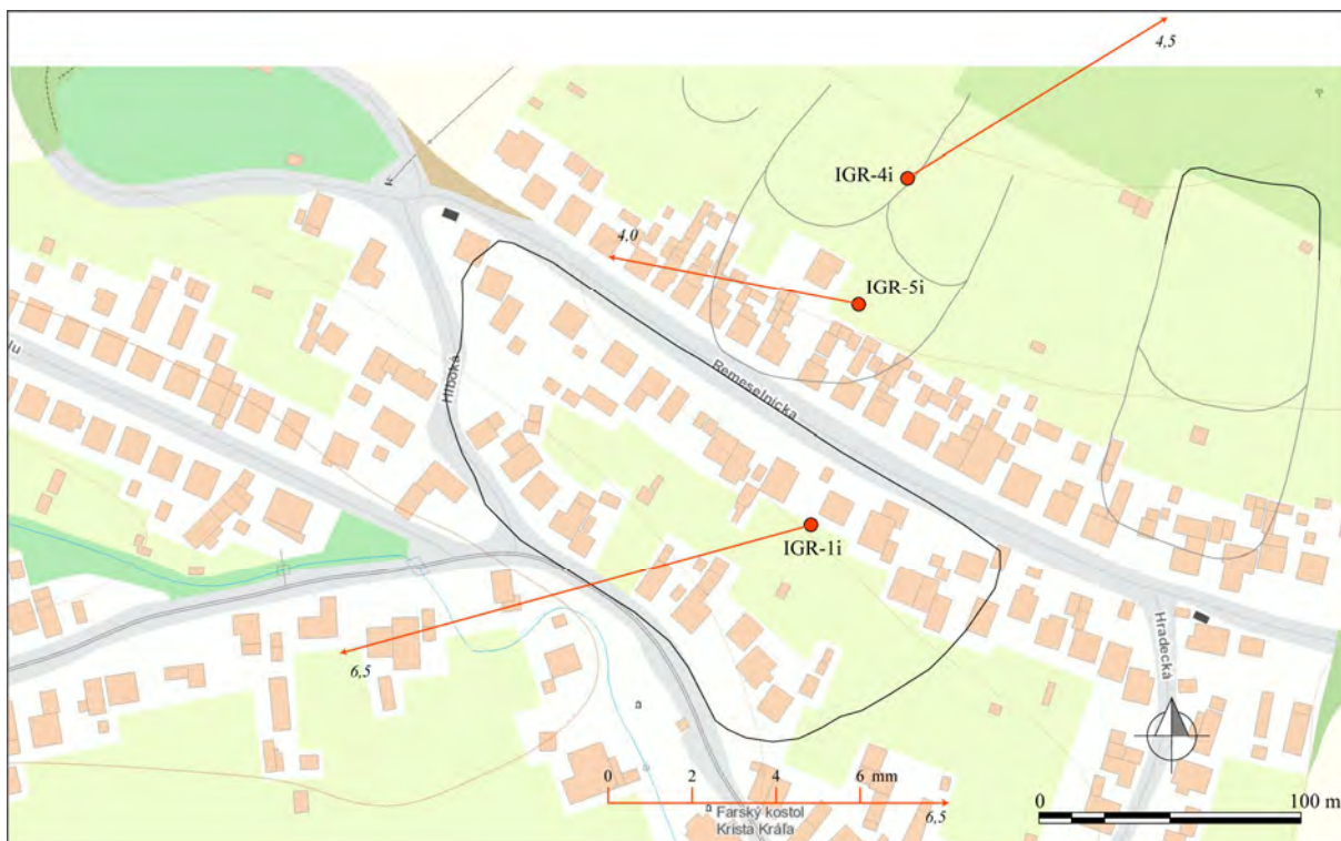
Obr. 1.48. Lokalita Velká Lehôtka, Remeselnická ul. – výsledky inklinometrických meraní – vektory deformácií namerané v roku 2014 (obdobie meracej etapy je v súlade s prílohou 1.8; čísla zobrazené pri jednotlivých vektoroch označujú hĺbku zaznamenananej deformácie od ústia pažnice v m); ohraničenie zosuvu: Fekeč a Ilkanič, 2014b in Šimeková et al., 2014, mapový podklad: ZBGIS®
