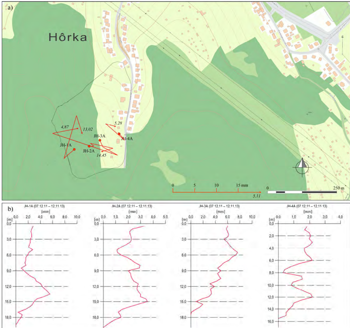
Obr. 1.94. Lokalita Prešov-Horárska ul. – výsledky inklinometrických meraní. a – vektory deformácií namerané v rokoch 2013 a 2014 (obdobia jednotlivých meracích etáp sú v súlade s prílohou 1.19; čísla zobrazené pri jednotlivých vektoroch označujú hĺbku zaznamenananej deformácie od povrchu terénu v m), b – výsledná deformácia inklinometrickej pažnice za dlhšie časové obdobie; mapový podklad: ZBGIS®
