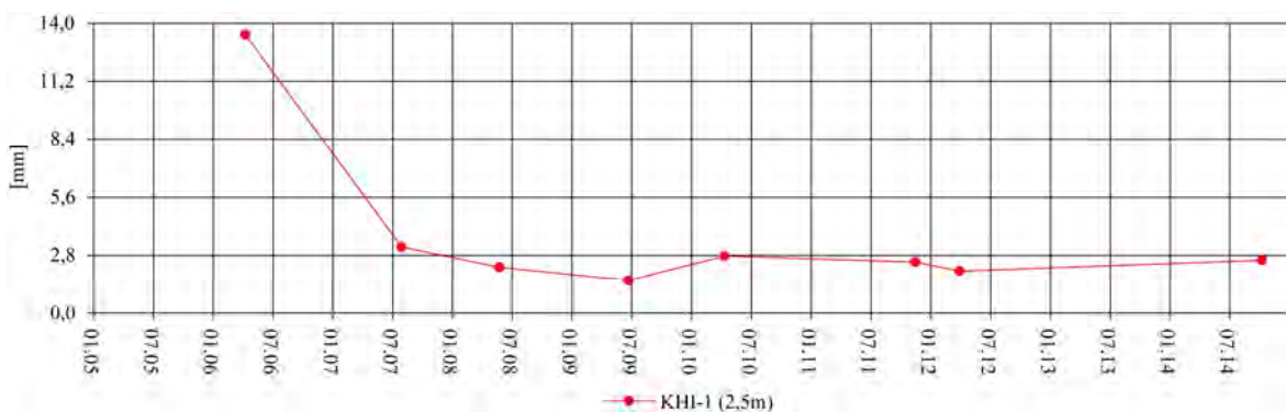
Obr. 1.114. Dlhodobé (2005 – 2013) prírastky deformácie namerané na šmykových plochách metódou presnej inklinometrie na lokalite Kvašov
