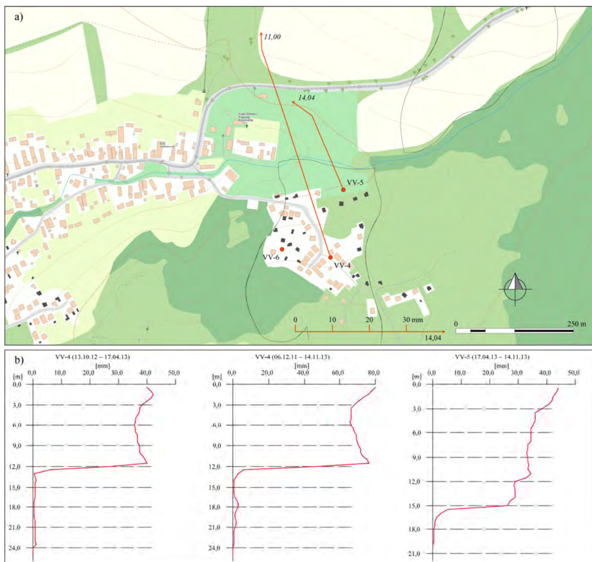
Obr. 1.129. Lokalita Varhaňovce – výsledky inklinometrických meraní. a – vektory deformácií namerané v rokoch 2013 a 2014 (obdobia jednotlivých meracích etáp sú v súlade s prílohou 1.29; čísla zobrazené pri jednotlivých vektoroch označujú hĺbku zaznamenananej deformácie od povrchu terénu v m), b – výsledná deformácia inklinometrickej pažnice za dlhšie časové obdobie; obrisy zosuvov podľa Tupého et al. (2010), mapový podklad: ZBGIS®
