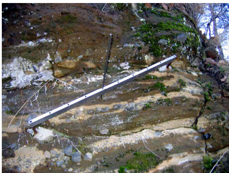
Obr. 1.175. Situovanie meradla mikromorfologických zmien povrchu horniny na skalnej stene oproti katastrofálnemu handlovskému zosuvu (lokalita Handlová-Baňa)
