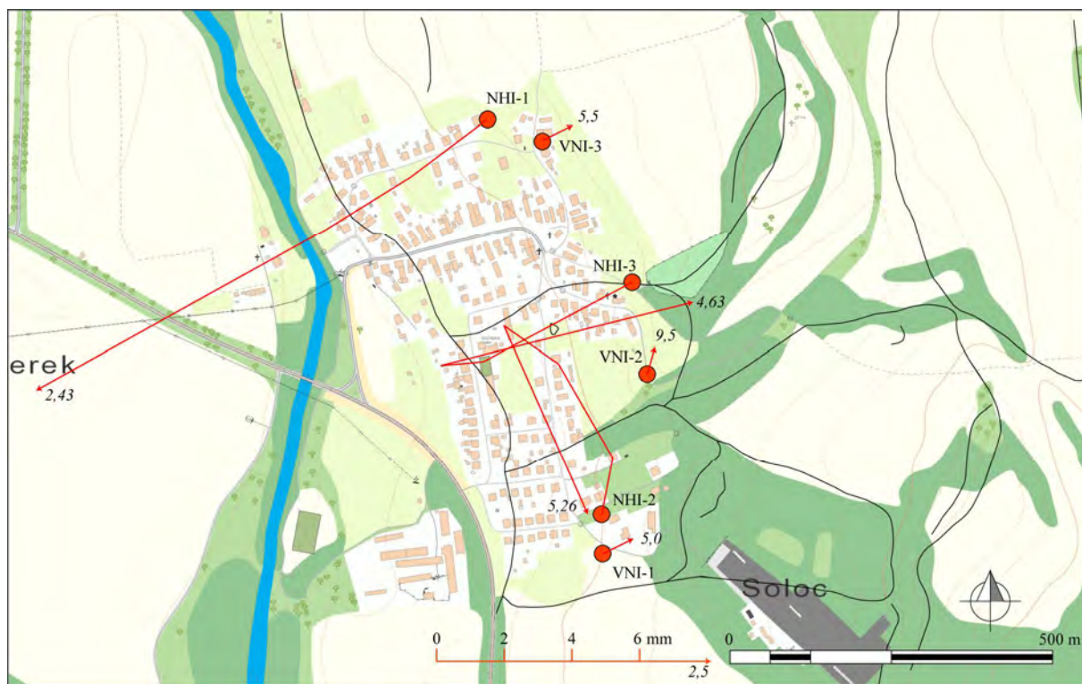
Obr. 1.125. Lokalita Nižná Hutka – výsledky inklinometrických meraní. a – vektory deformácií namerané v rokoch 2013 a 2014 (obdobia jednotlivých meracích etáp sú v súlade s prílohou 1.29; čísla zobrazené pri jednotlivých vektoroch označujú hĺbku zaznamenananej deformácie od povrchu terénu v m), b – výsledná deformácia inklinometrickej pažnice za dlhšie časové obdobie; obrysy zosuvov podľa Grmana et al. (2010), mapový podklad: ZBGIS®
