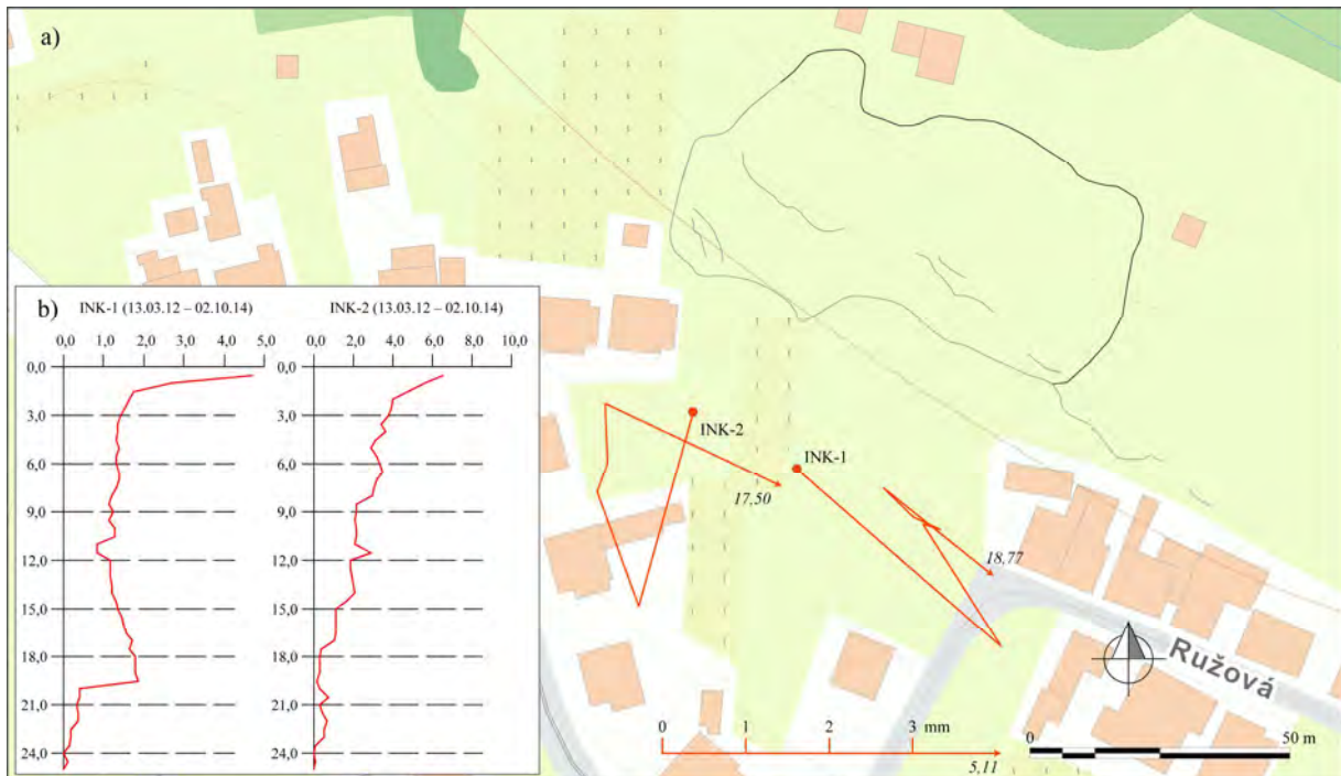
Obr. 1.141. Lokalita Šenkvice – výsledky inklinometrických meraní. a – vektory deformácií namerané v rokoch 2013 a 2014 (obdobia jednotlivých meracích etáp sú v súlade s prílohou 1.33; čísla zobrazené pri jednotlivých vektoroch označujú hĺbku zaznamenananej deformácie od povrchu terénu v m), b – výsledná deformácia inklinometrickej pažnice za dlhšie časové obdobie; obrysy zosuvov podľa Žabkovej et al. (2010), mapový podklad: ZBGIS®
