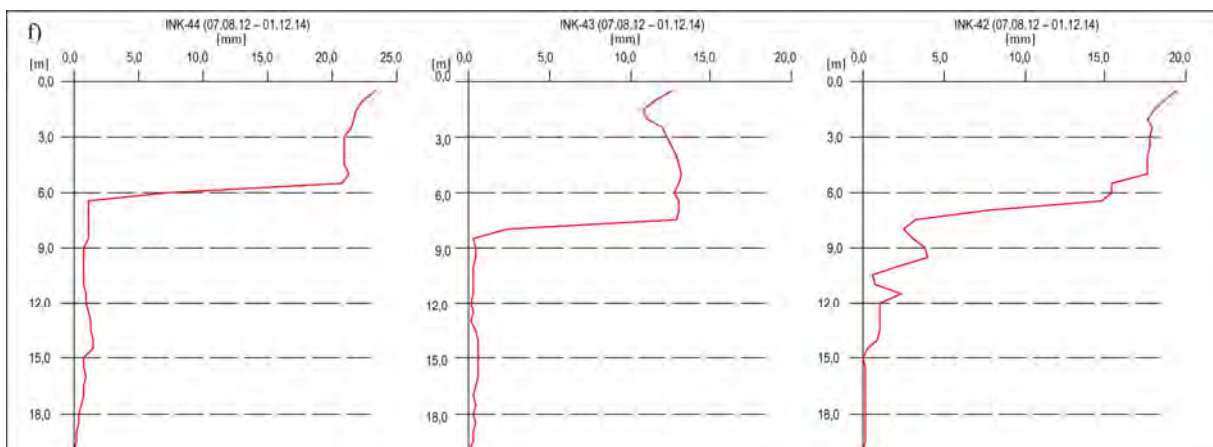
Obr. 1.33f. Lokalita Nižná Myšľa – výsledky inklinometrických meraní – výsledná deformácia inklinometrickej pažnice za dlhšie časové obdobie vo vrtoch INK-42, INK-43 a INK-44
