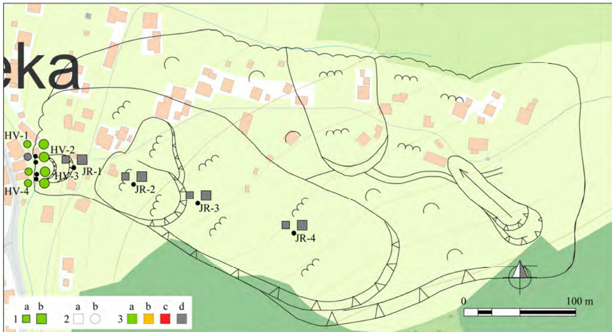
Obr. 1.107. Lokalita Čadca – výsledky režimových pozorovaní. 1 – režimové pozorovania zmien hĺbky hladiny podzemnej vody a výdatnosti odvodňovacích zariadení v rokoch: a – 2013, b – 2014, 2 – monitorovacie objekty: a – piezometrické vrty merané pozorovateľom, b – odvodňovacie subhorizontálne vrty, 3 – hodnotenie režimových ukazovateľov podľa kritérií, zhrnutých v tab. 1.6 (d – nehodnotený); obrisy zosuvov podľa Novotného a Mišútha (2012), mapový podklad: ZBGIS®
