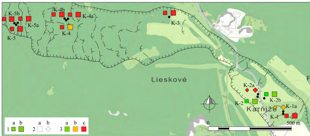
Obr. 1.29. Lokalita Fintice – výsledky režimových pozorovaní. 1 – režimové pozorovania zmien hĺbky hladiny podzemnej vody v rokoch: a – 2013, b – 2014, 2 – monitorovacie objekty: a – pozorované vertikálne vrty, b – vrty s automatickými hladinomerami, 3 – hodnotenie režimových ukazovateľov podľa kritérií, zhrnutých v tab. 1.6; mapový podklad: ZBGIS®
