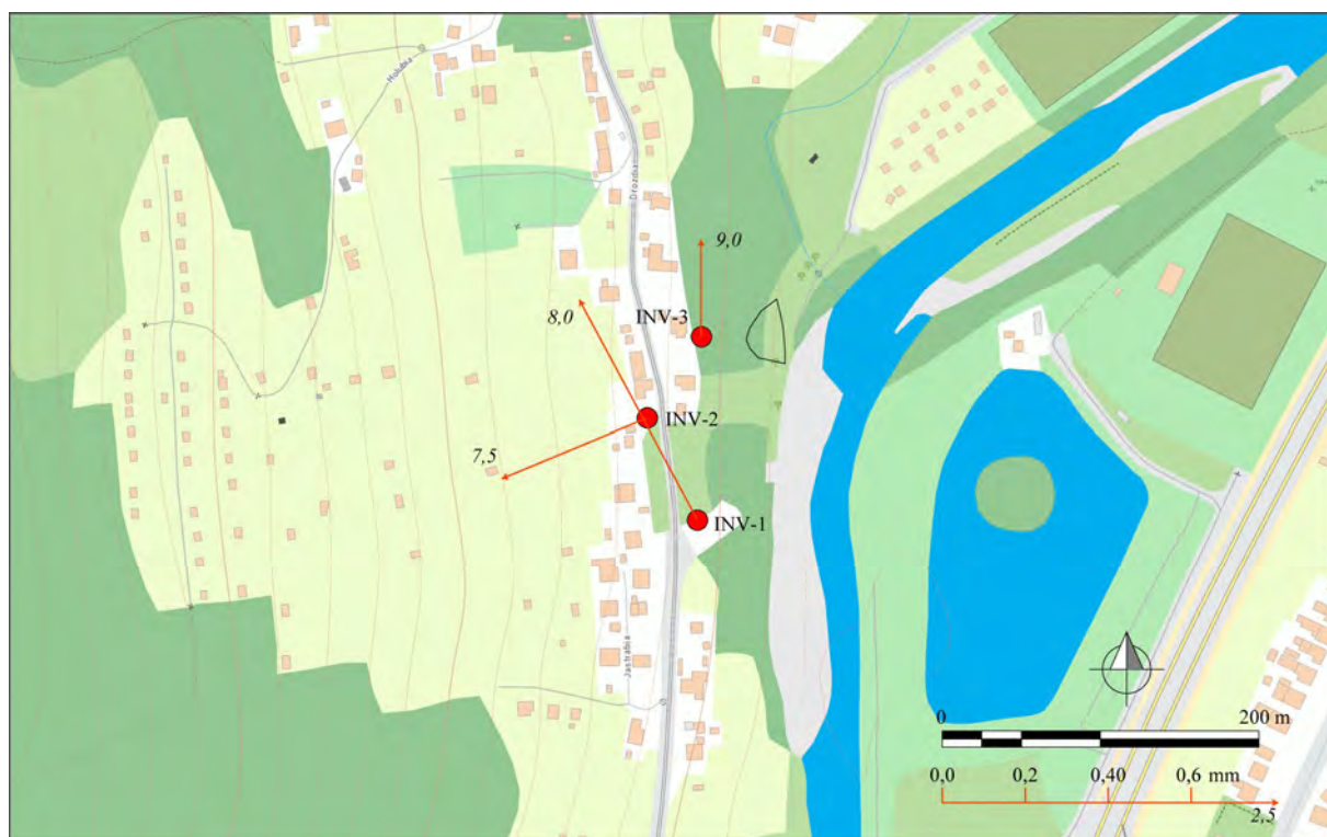
Obr. 1.112. Lokalita Vranie – výsledky inklinometrických meraní. a – vektor deformácie nameraný v roku 2014 (obdobie meracej etapy je v súlade s prílohou 1.25; číslo zobrazené pri vektore označuje hĺbku zaznamenananej deformácie od povrchu terénu v m), b – deformácia inklinometrickej pažnice; mapový podklad: ZBGIS®
