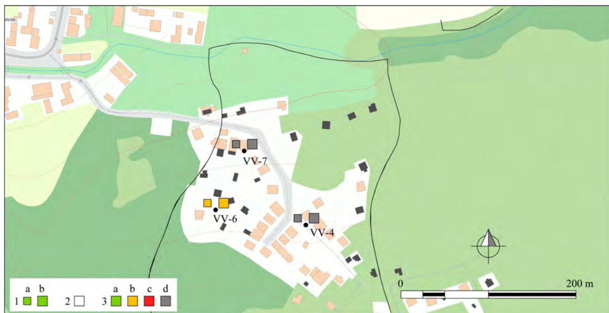
Obr. 1.131. Lokalita Varhaňovce – výsledky režimových meraní. 1 – režimové pozorovania zmien hĺbky hladiny podzemnej vody v rokoch: a – 2013, b – 2014, 2 – piezometrické vrty merané pozorovateľom, 3 – hodnotenie režimových ukazovateľov podľa kritérií, zhrnutých v tab. 1.6 (nehodnotený – vrty sú poškodené); ohraničenie zosuvu podľa Tupého et al. (2010), mapový podklad: ZBGIS®
