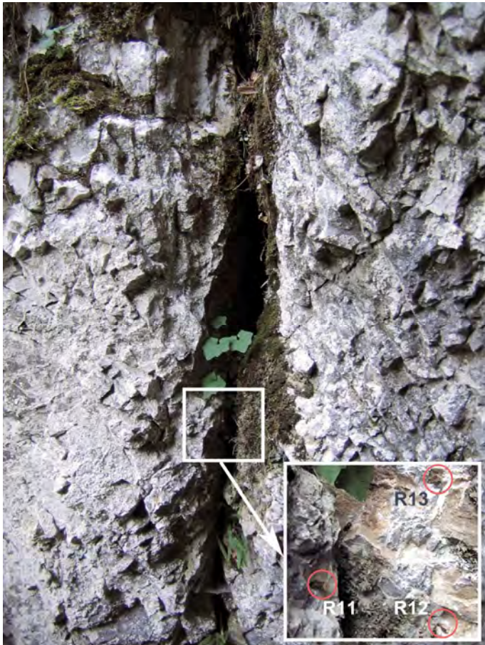
Obr. 1.183. Umiestnenie pozorovacích bodov R11, R12 a R13 (Stanovište 1) pre merania dilatometrom Somet na lokalite Pod večným dažďom (Slovenský raj)
