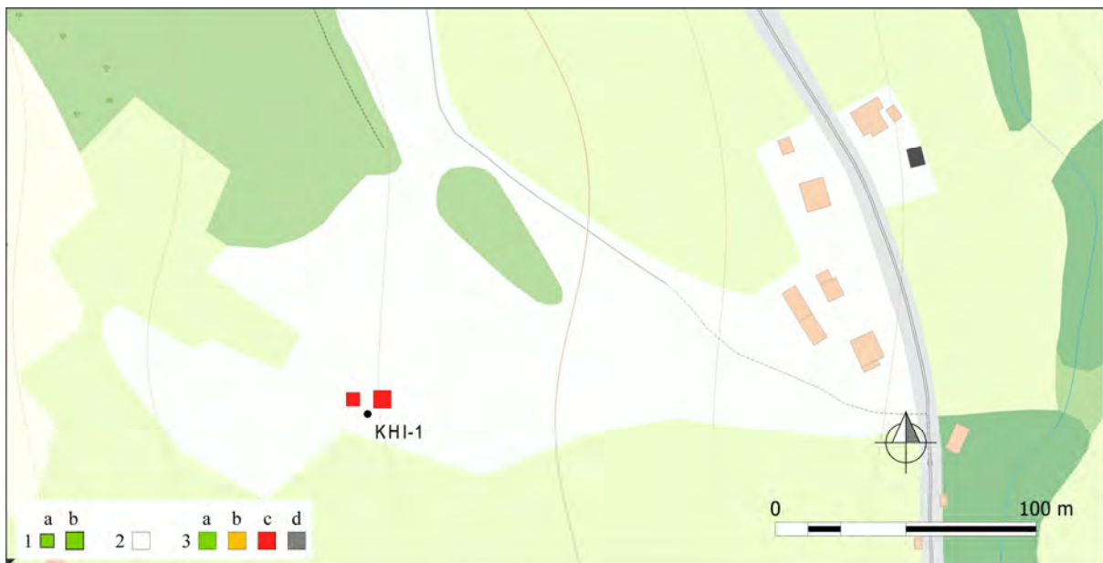
Obr. 1.115. Lokalita Kvašov – výsledky režimových pozorovaní. 1 – režimové pozorovania zmien hĺbky hladiny podzemnej vody v rokoch: a – 2013, b – 2014, 2 – piezometrický vrt meraný pozorovateľom, 3 – hodnotenie režimových ukazovateľov podľa kritérií, zhrnutých v tab. 1.6 (d – nehodnotený); mapový podklad: ZBGIS®
