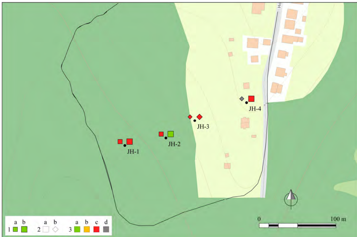
Obr. 1.96. Lokalita Prešov-Horárska ul. – výsledky režimových pozorovaní. 1 – režimové pozorovania zmien hĺbky hladiny podzemnej vody a výdatností odvodňovacích zariadení v rokoch: a – 2013, b – 2014, 2 – monitorovacie objekty: a – piezometrické vrty merané pozorovateľom, b – vrty s inštalovanými automatickými hladinomermi, 3 – hodnotenie režimových ukazovateľov podľa kritérií, zhrnutých v tab. 1.6 (d – nehodnotený); mapový podklad: ZBGIS®
