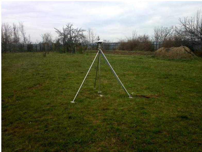
Obr. 16 Hĺbková, tyčová stabilizácia bodu - stanica GNSS v Rimavskej Sobote
