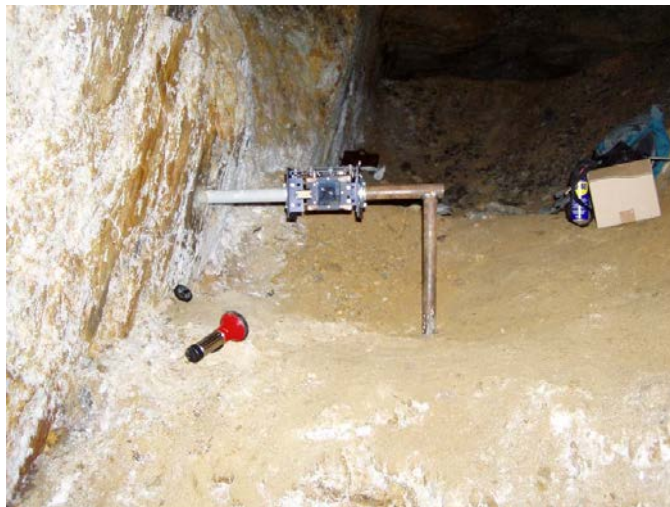
Obr. 21 Inštalácia dilatometra TM-71 v opustenej štôlni Všetehsvätých (stará) na lokalite Banská Hodruša (Hámre)
