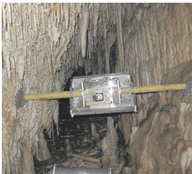
Obr. 19 Inštalácia dilatometra TM-71 v Čarovnej chodbe (Demänovská jaskyňa Slobody)
