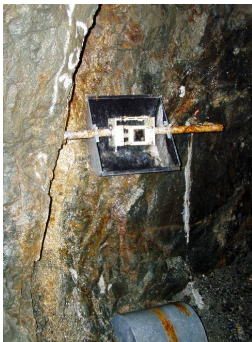
Obr. 20 Inštalácia dilatometra TM-71 v prieskumnej štôlni Izabela na lokalite Ipeľ
