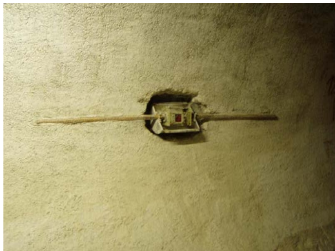
Obr. 18 Inštalácia dilatometra TM-71 v únikovej štôlni tunela Branisko
