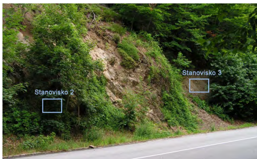
Obr. 1.171. Situovanie stanovísk 2 a 3 na lokalite Pezinská Baba na meranie mikromorfologických zmien povrchu horniny na svahu odrezu cesty
