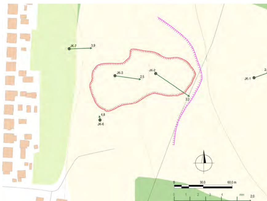
Obr. 1.22. Lokalita Handlová-Kunešovská cesta. Výsledky inklinometrických meraní za obdobie XI. 11 – VII. 12 (číslo označuje hĺbku zaznamenananej deformácie od povrchu terénu v m); mapový podklad: ZBGIS®
