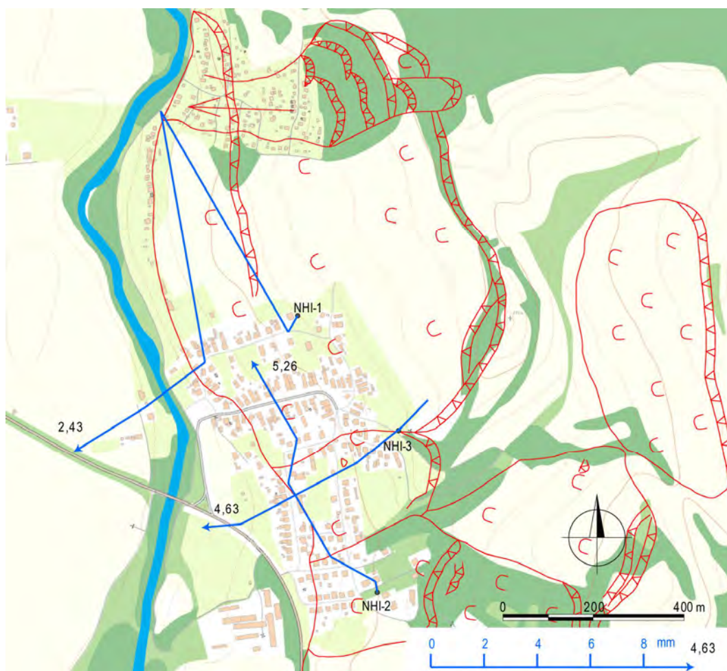
Obr. 1.110. Lokalita Nižná Hutka – výsledky inklinometrických meraní za obdobie XII. 11 – III. 12 – VIII. 12 – X. 12 – IV. 13 – VIII. 13 (číslo označuje hĺbku zaznamenatej deformácie od povrchu terénu v m); (Grman et al., 2010), červená línia – ohraničenie zosuvu (Grman et al., 2010), mapový podklad: ZBGIS®
