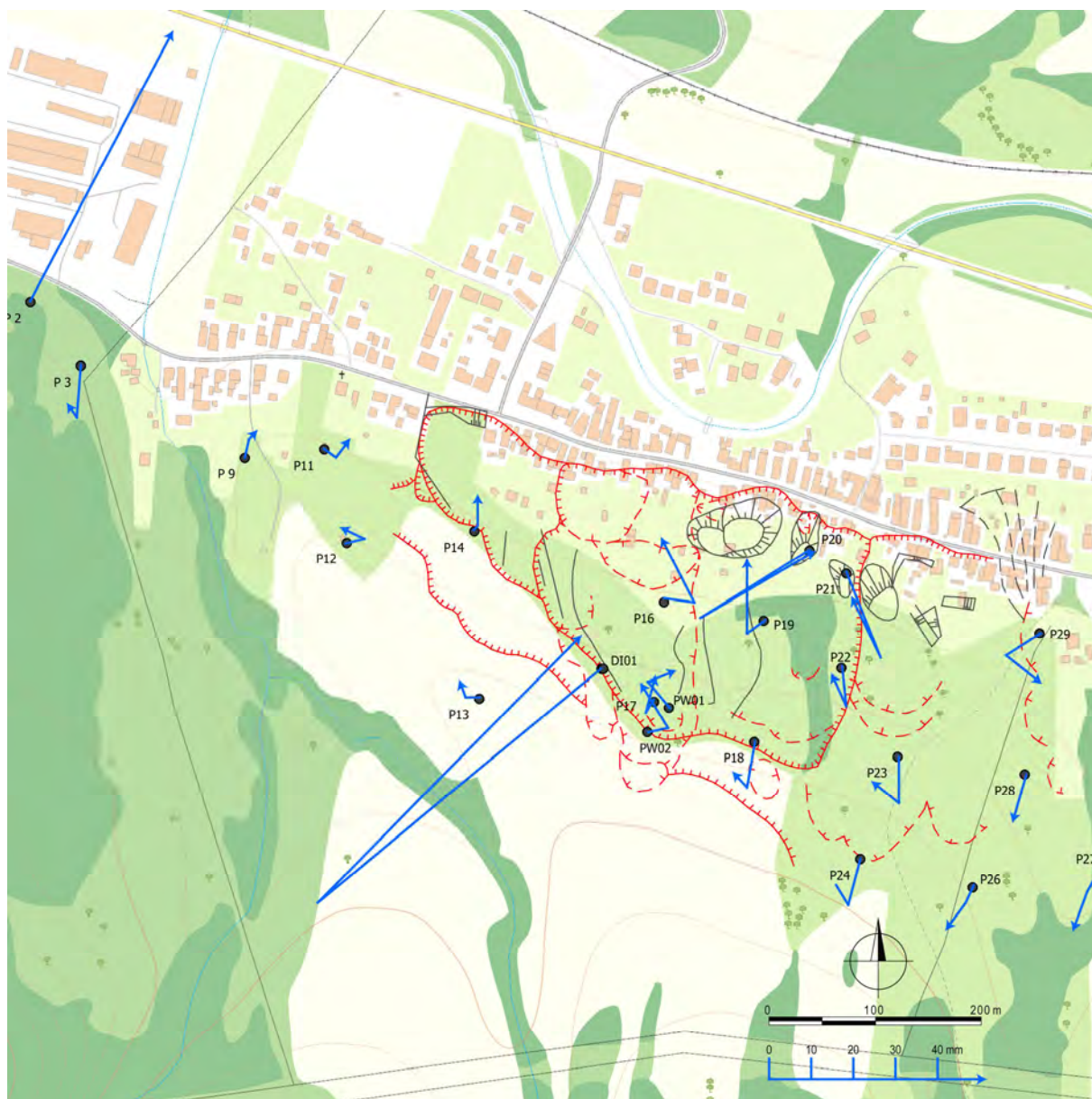
Obr. 1.5. Lokalita Veľká Čausa – výsledky geodetických (terestrických) meraní za obdobie VI. 11 – V. 12 – VI.13; mapový podklad: ZBGIS®
