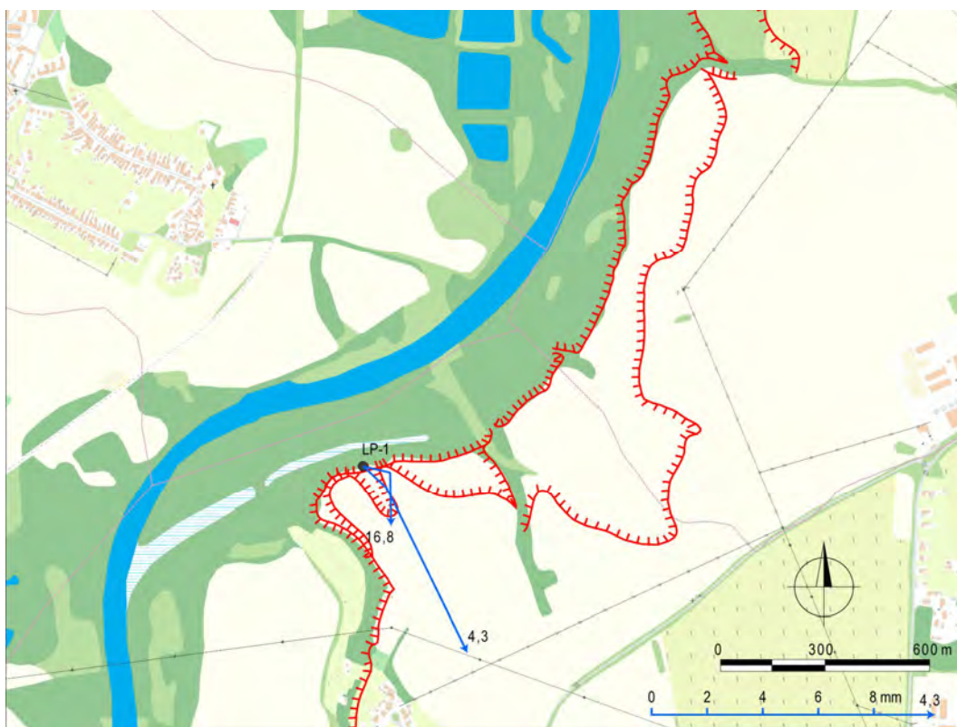
Obr. 1.139. Lokalita Hlohovec-Posádka – výsledky inklinometrických meraní za obdobie XI. 11 – IV. 12 – X. 13 (číslo označuje hĺbku zaznamenananej deformácie od povrchu terénu v m); červená línia – ohraničenie zosuvu (Otepka et al., 1986), mapový podklad: ZBGIS®
