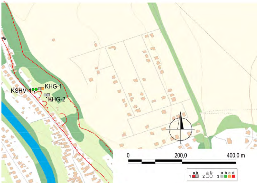
Obr. 1.108. Lokalita Košice-Krásna – výsledky semikvantitatívneho hodnotenia režimových pozorovaní. 1 – režimové pozorovania zmien hĺbky hladiny podzemnej vody a výdatností odvodňovacích zariadení v roku: a – 2012, b – 2013, 2 – monitorovacie objekty: a – pozorované vertikálne vrty, b – odvodňovacie subhorizontálne vrty, 3 – hodnotenie režimových ukazovateľov podľa kritérií, zhrnutých v tab. 1.6 (a – nehodnotený); mapový podklad: ZBGIS®
