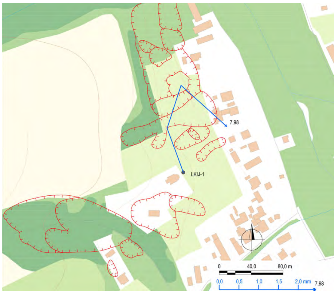
Obr. 1.77. Lokalita Lukov – výsledky inklinometrických meraní za obdobie XII. 11 – III. 12 – VIII. 12 – X. 12 – VIII. 13 (číslo označuje hĺbku zaznamenananej deformácie od povrchu terénu v m); červená línia – ohraničenie zosuvu (Havčo et al., 2010), mapový podklad: ZBGIS®
