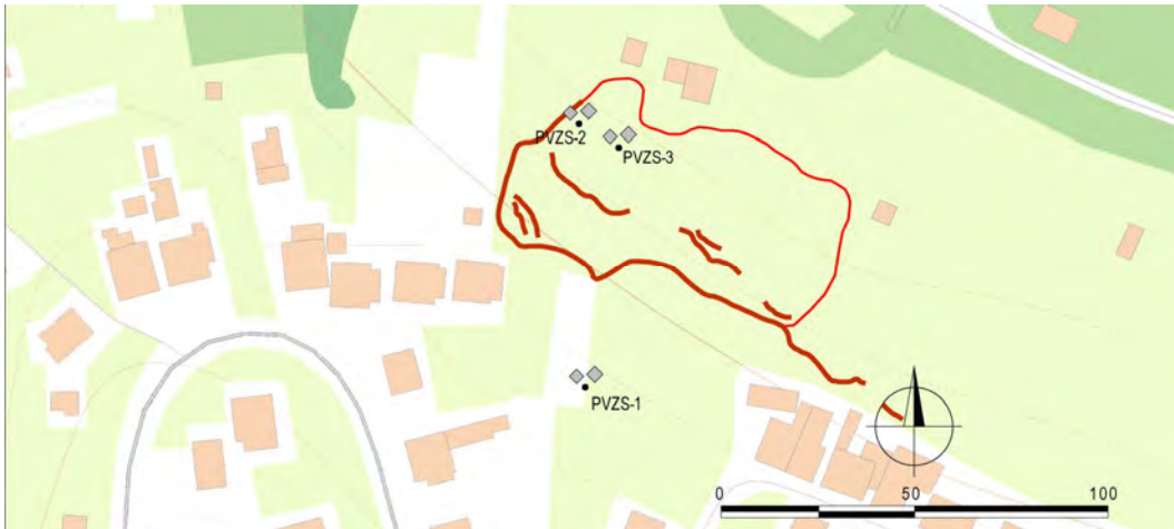
Obr. 1.128. Lokalita Šenkvice – výsledky režimových pozorovaní. 1 – režimové pozorovania zmien hĺbky hladiny podzemnej vody a výdatností odvodňovacích zariadení v rokoch 2012 a 2013 (nehodnotené); mapový podklad: ZBGIS®
