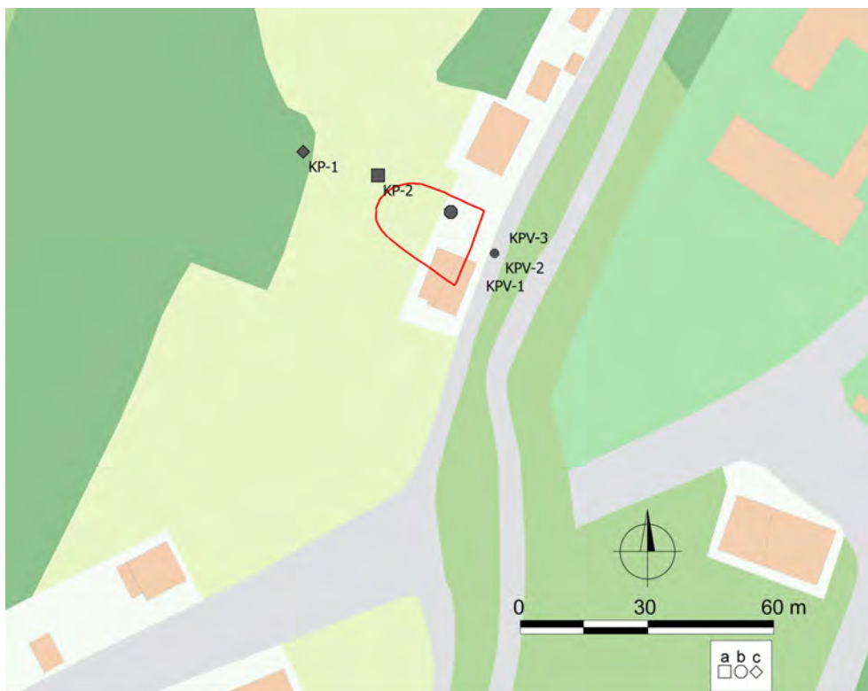
Obr. 1.95: Lokalita Krajná Poľana – sieť monitorovacích objektov pre režimové pozorovania. a – pozorovaný vertikálny vrt, b – odvodňovací subhorizontálny vrt, c – vrt s inštalovaným automatickým hladinomerom; červená línia – ohraničenie zosuvu (Grech, 2012), mapový podklad: ZBGIS®
