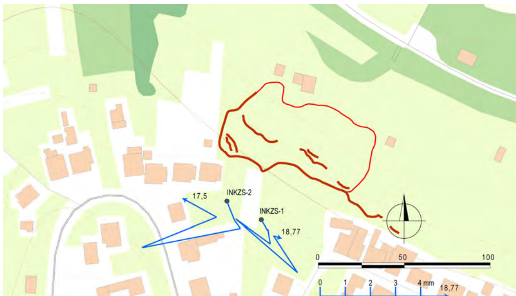
Obr. 1.126. Lokalita Šenkvice – výsledky inklinometrických meraní v rokoch za obdobie XII. 11 – III. 12 – IV. 12 – VII. 12 – X. 12 – XII. 12 – III. 13 – X. 13 – XI. 13 (číslo označuje hĺbku zaznamenananej deformácie od povrchu terénu v m); červená línia – ohraňenie zosuvu (Žabková et al., 2010), mapový podklad: ZBGIS®
