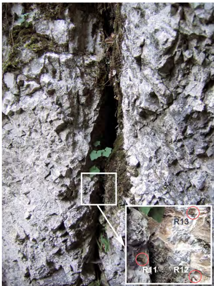
Obr. 1.164. Umiestnenie pozorovacích bodov R11, R12 a R13 (Stanovisko 1) pre merania dilatometrom Somet na lokalite Pod večným dažďom (Slovenský raj)
