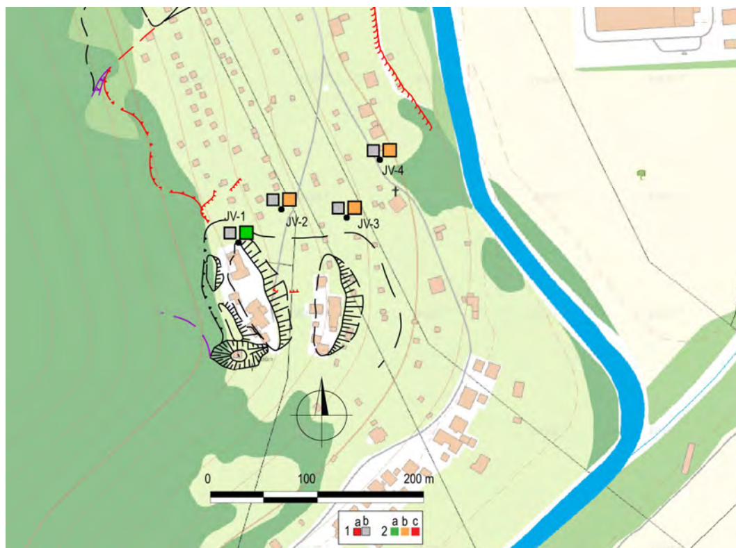
Obr. 1.91. Lokalita Prešov-Pod Wilec Hôrkou – výsledky semikvantitatívneho hodnotenia režimových pozorovaní. 1 – režimové pozorovania zmien hĺbky hladiny podzemnej vody v piezometrických vrtoch počas roku: a – 2012, b – 2013, 2 – hodnotenie režimových pozorovaní podľa kritérií, zhrnutých v tab. 1.6; červená a čierna línia – ohraničenie svahových deformácií (Tupý et al., 2011b); mapový podklad: ZBGIS®
