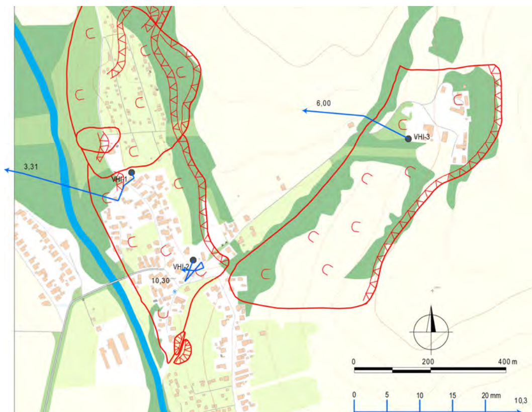
Obr. 1.122. Lokalita Vyšná Hutka – výsledky inklinometrických meraní za obdobie XII. 11 – III. 12 – VIII. 12 – X. 12 – IV. 13 – VIII. 13 (číslo označuje hĺbku zaznamenananej deformácie od povrchu terénu v m); červená línia – ohraničenie zosuvu (Grman et al., 2010), mapový podklad: ZBGIS®
