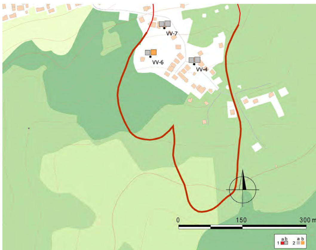
Obr. 1.116. Lokalita Varhaňovce – výsledky semikvantitatívneho hodnotenia režimových pozorovaní. 1 – režimové pozorovania zmien hĺbky hladiny podzemnej vody v roku: a – 2012, b – 2013, 2 – hodnotenie režimových ukazovateľov podľa kritérií, zhrnutých v tab. 1.6: a – nehodnotený, b – náznaky nepriaznivého stabilného stavu; červená línia – ohraničenie zosuvu (Tupý et al., 2010), mapový podklad: ZBGIS®
