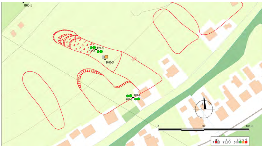
Obr. 1.67. Lokalita Bardejovská Zábava – semikvantitatívne výsledky režimových pozorovaní. 1 – režimové pozorovania zmien hĺbky hladiny podzemnej vody a výdatností odvodňovacích zariadení počas roku: a – 2012, b – 2013, 2 – monitorovacie objekty: a – pozorované vertikálne vrty, b – odvodňovacie subhorizontálne vrty, 3 – hodnotenie režimových pozorovaní podľa kritérií, zhrnutých v tab. 1.6 (a – nehodnotené); červená línia – ohraničenie zosuvu (Havčo, 2012), mapový podklad: ZBGIS®
