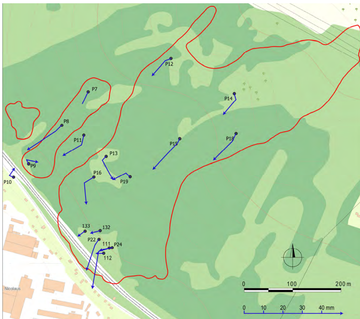
Obr. 1.53. Lokalita Okoličné – výsledky geodetických meraní za obdobie V. 11 – V. 12 – V. 13; mapový podklad: ZBGIS®
