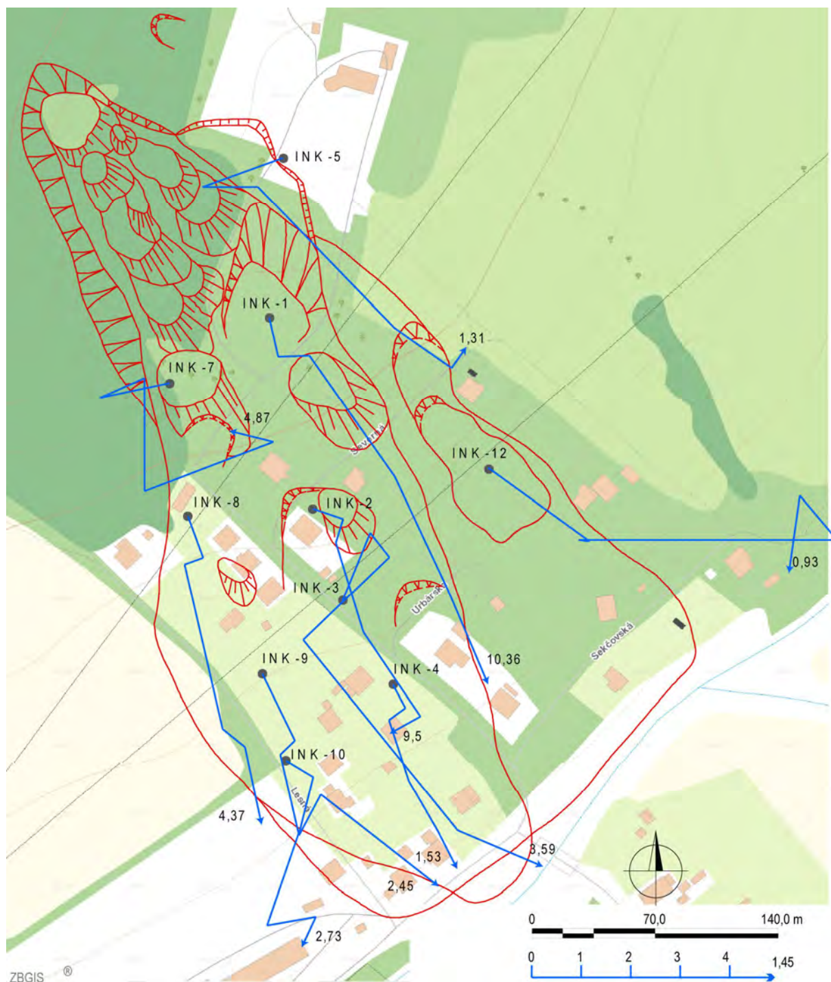
Obr. 1.35. Lokalita Kapušany – výsledky inklinometrických meraní za obdobie VIII. 12 – X. 12 – XII. 12 – IV. 13 – VII. 13 – XI. 13 (číslo označuje hĺbku zaznamenananej deformácie od povrchu terénu v m); červená línia – ohraničenie zosuvu (Laffers et al., 2012); mapový podklad: ZBGIS®
