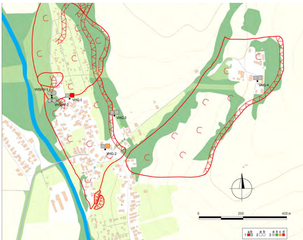
Obr. 1.124. Lokalita Vyšná Hutka – výsledky režimových pozorovaní. 1 – režimové pozorovania zmien hĺbky hladiny podzemnej vody a výdatností odvodňovacích zariadení v roku: a – 2012, b – 2013, 2 – monitorovacie objekty: a – pozorované vertikálne vrty, b – odvodňovacie subhorizontálne vrty, 3 – hodnotenie režimových ukazovateľov podľa kritérií, zhrnutých v tab. 1.6 (a – nehodnotený); červená línia – ohraničenie zosuvu (Grman et al., 2010), mapový podklad: ZBGIS®
