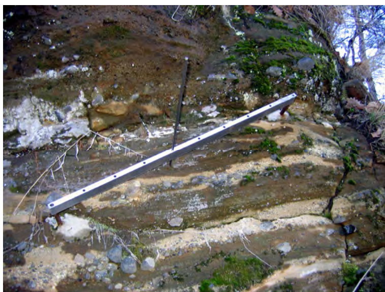
Obr. 1.157. Situovanie meradla mikromorfologických zmien povrchu horniny na skalnej stene oproti katastrofálnemu handlovskému zosuvu (lokalita Handlová-Baňa)
