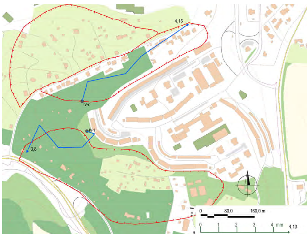
Obr. 1.102. Lokalita Košice-sídliisko Dargovských hrdinov – výsledky inklinometrických meraní za obdobia XII. 11 – III. 12 – VIII. 12 – X. 12 – IV. 13 – XI. 13 (číslo označuje hĺbku zaznamenatej deformácie od povrchu terénu v m); červená línia – ohraničenie zosuvu (Grman et al., 2010), mapový podklad: ZBGIS®
