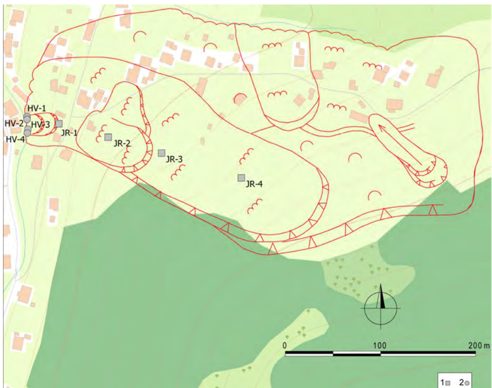
Obr. 1.97. Lokalita Čadca – sieť monitorovacích objektov pre režimové pozorovania. 1 – pozorované vertikálne vrty, 2 – odvodňovacie zariadenia; červená línia – ohraničenie zosuvu (Novotný a Mišúth, 2012), mapový podklad: ZBGIS®
