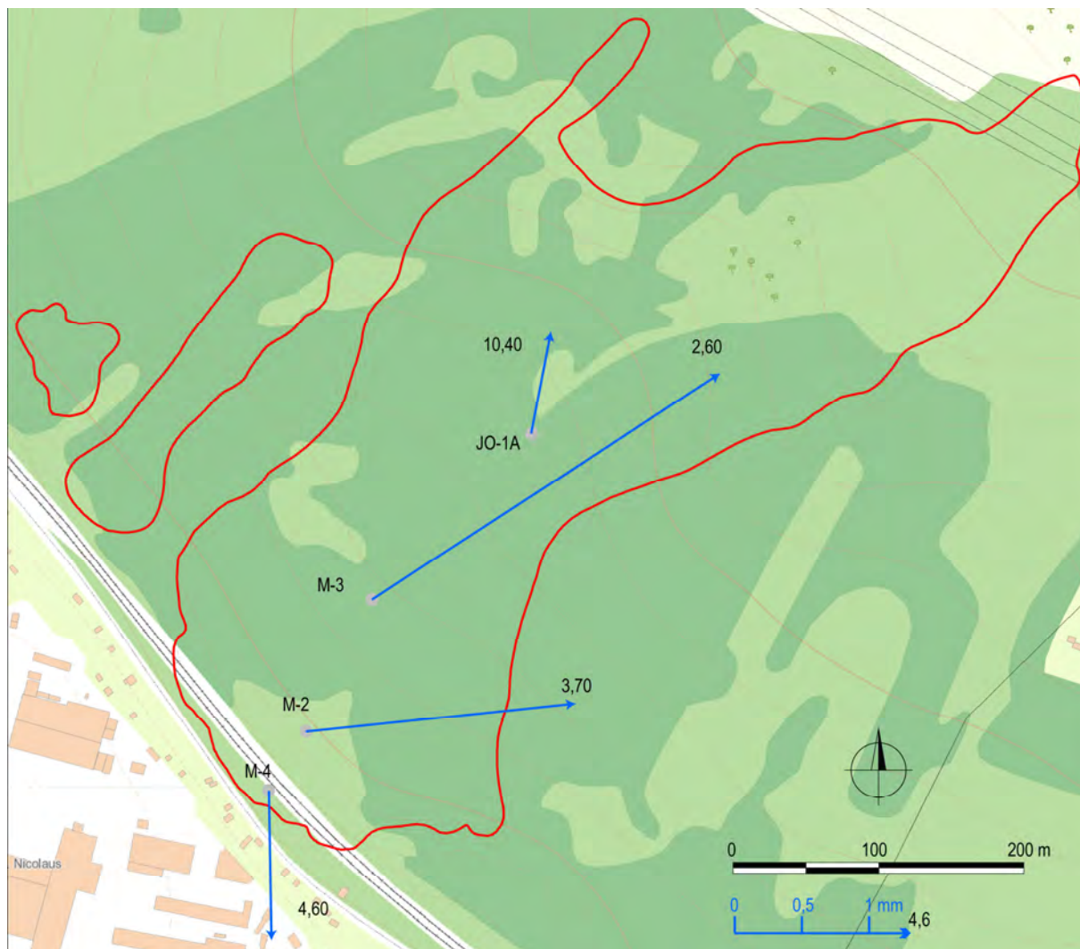
Obr. 1.55. Lokalita Okoličné – výsledky inklinometrických meraní za obdobie XI. 11 – VII. 12 (číslo označuje hĺbku zaznamenananej deformácie od povrchu terénu v m); mapový podklad: ZBGIS®
