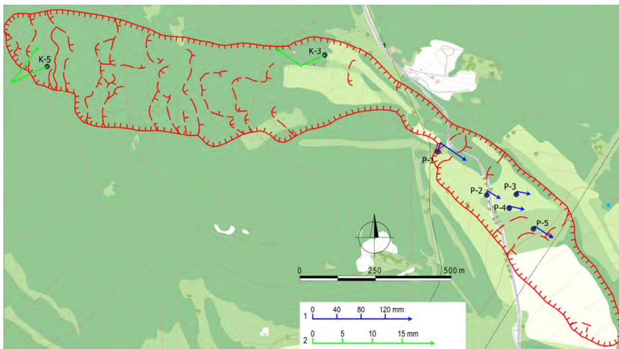
Obr. 1.25. Lokalita Fintice – výsledky geodetických a inklinometrických meraní v rokoch 2012 a 2013. 1 – mierka vektorov premiestnení geodetických bodov za obdobie XI. 11 – VI. 12 – VII. 13, 2 – mierka vektorov deformácie inklinometrickej pažnice za obdobie XI. 11 – VIII. 12 – VII. 13 (číslo označuje hĺbku zaznamenananej deformácie od povrchu terénu v m); mapový podklad: ZBGIS®
