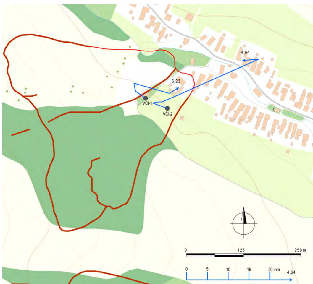
Obr. 1.118. Lokalita Vyšný Čaj – výsledky inklinometrických meraní za obdobie XII. 11 – III. 12 – VIII. 12 – X. 12 – IV. 13 – VIII. 13 (číslo označuje hĺbku zaznamenatej deformácie od povrchu terénu v m); červená línia – ohraničenie zosuvu (Grman et al., 2010), mapový podklad: ZBGIS®
