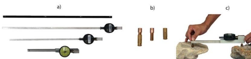
Obr. 11: Prenosný dilatometer SOMET, a – 25, 50 a 75 cm meracie tyče, dva typy snímačov, b – meracie trne, c – ukážka merania
