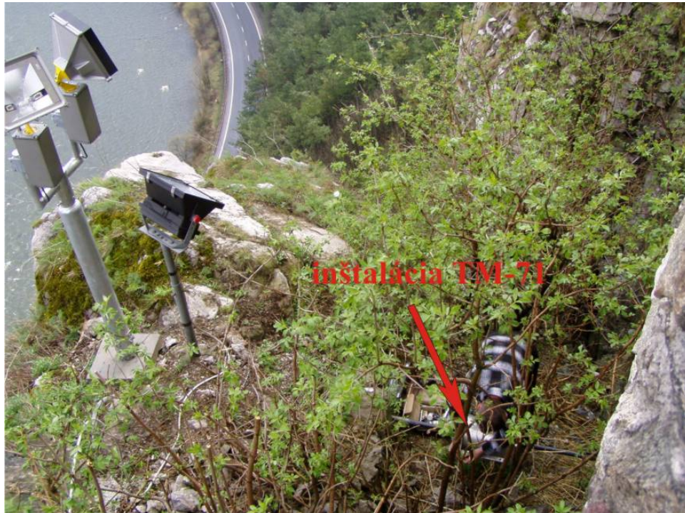
Obr. 4: Inštalácia dilatometra TM-71 v trhline nad previsom na severnej strane Strečnianskeho hradu.
