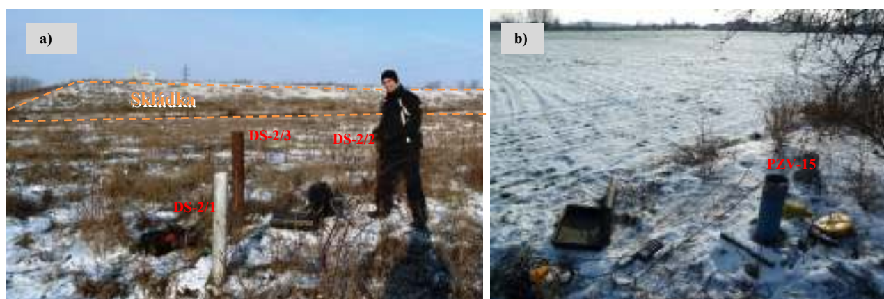
Obr. 2.9.3.: Monitorovanie indikačných vrtov; a) viacúrovňového vrtu DS-2/1,2,3; b) vrtu PZV-15 (tiež ako V-10).
