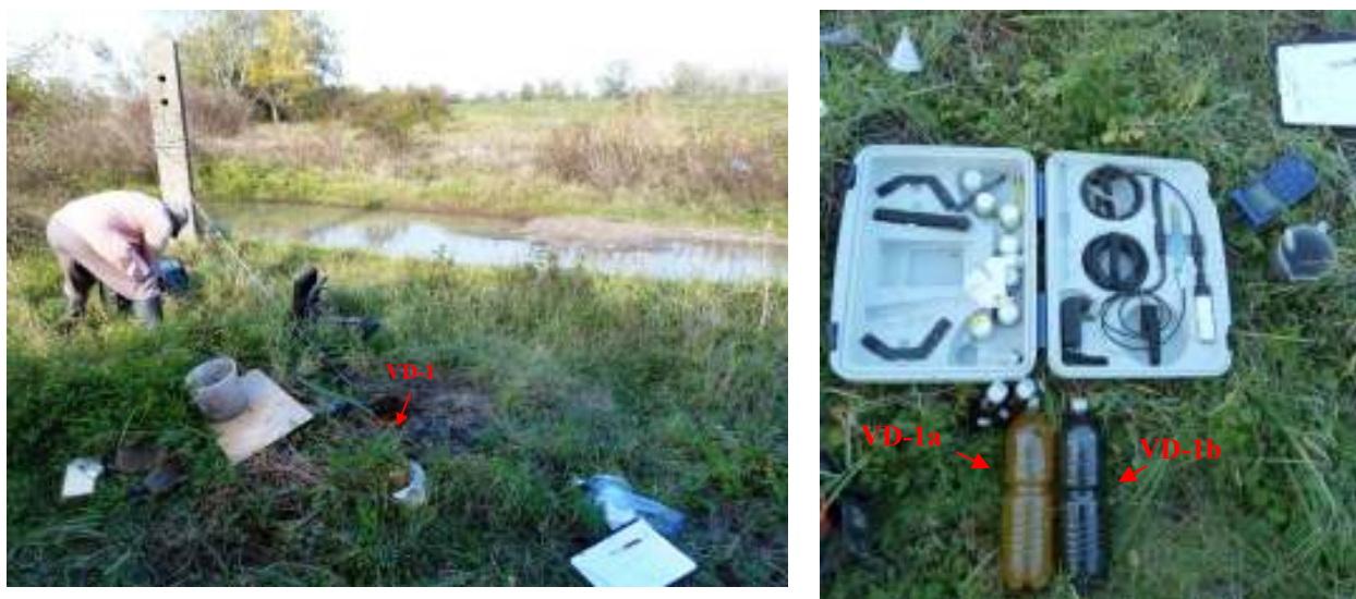
Obr. 2.6.2.: Odber vzoriek z vrtu VD-1 z vrchnej (VD-1a) a spodnej časti vodného stĺpca (VD-1b).
