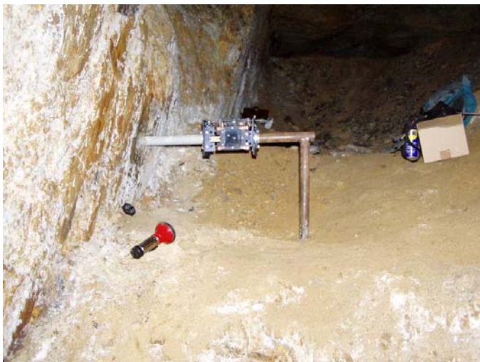
Obr. 2.2.5: Inštalácia dilatometra TM-71 v opustenej štôlni Všetehsvätých (stará) na lokalite Banská Hodruša
