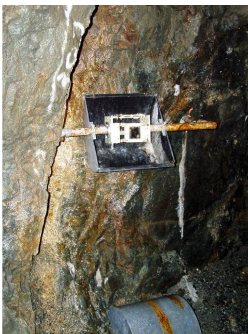
Obr. 2.2.4: Inštalácia dilatometra TM-71 v prieskumnej štôlni Izabela na lokalite Ipeľ
