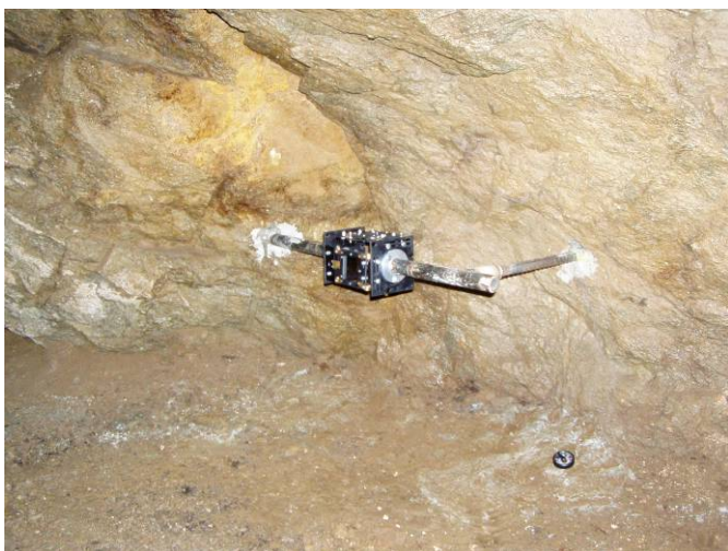
Obr. 2.2.6: Inštalácia dilatometra TM-71 v opustenej štôlni sv. Anton Paduánsky na lokalite Vyhne
