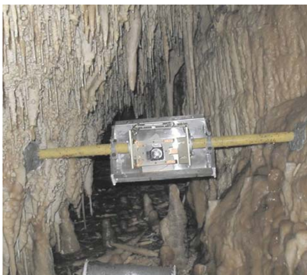
Obr. 2.2.3: Inštalácia dilatometra TM-71 v Čarovnej chodbe (Demänovská jaskyňa Slobody)
