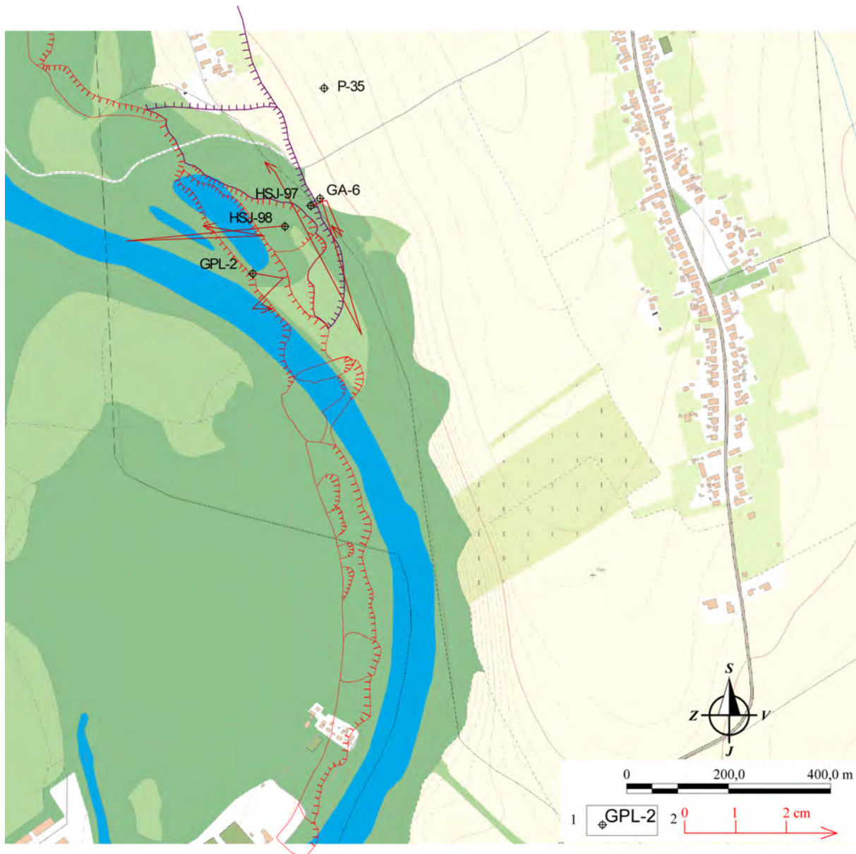
Obr. 1.100 Lokalita Vinohrady nad Váhom, miestna časť Paradič – výsledky geodetických meraní v roku 2012. 1 – geodetické body a geodeticky merané vrty, 2 – miera vektorov premiestnení geodetických bodov za obdobie XI.11 – I.12 – VII.12 – XI.12, červená línia – ohraničenie aktívnych zosuvov, fialová línia – hranice potenciálnych zosuvov; mapový podklad: ZBGIS®
