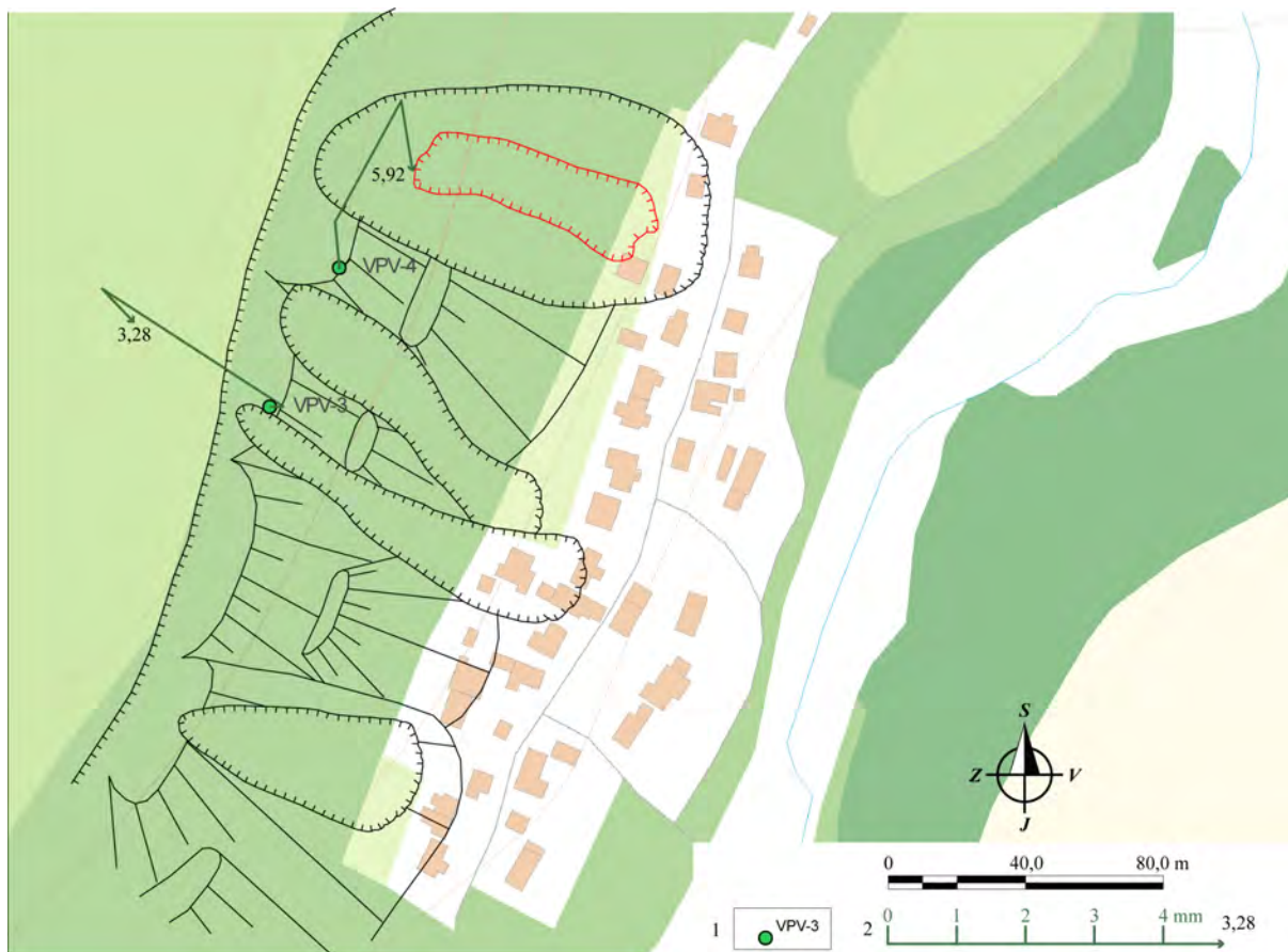
Obr. 1.65 Lokalita Pečovská Nová Ves – výsledky inklinometrických meraní v rokoch 2011 a 2012. 1 – inklinometrický vrt, 2 – mierka vektorov deformácie inklinometrickej pažnice za obdobie XII. 11 – III. 12 – VIII. 12 – X. 12 (číslo označuje hĺbku zaznamenananej deformácie od povrchu terénu v m), červená línia – ohraničenie aktívnych zosuvov z roku 2010, čierna línia – ohraničenie potenciálnych zosuvov; mapový podklad: ZBGIS®
