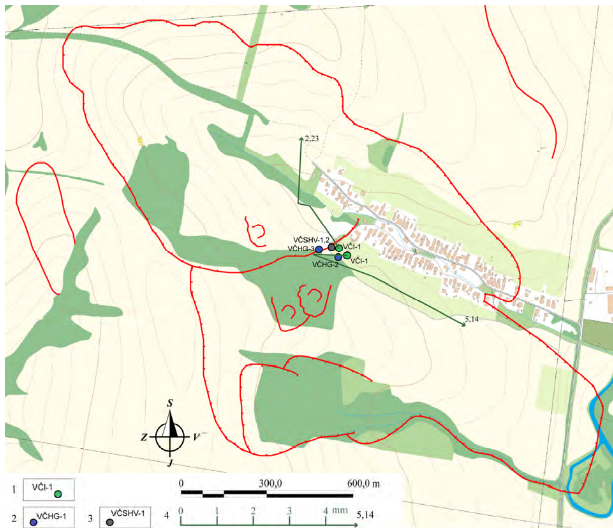
Obr. 1.87 Lokalita Vyšný Čaj – výsledky inklinometrických meraní v rokoch 2011 a 2012. 1 – inklinometrický vrt, 2 – piezometrický vrt, 3 – mierka vektorov deformácie inklinometrickej pažnice za obdobie XII. 11 – III. 12 – VIII. 12 – X. 12 (číslo označuje hĺbku zaznamenananej deformácie od povrchu terénu v m), červená línia – ohraničenie zosuvov; mapový podklad: ZBGIS®
