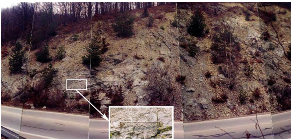
Obr. 1.132 Skalná stena odrezu cesty na lokalite Lipovník (s detailom umiestnenia meradla mikromorfologických zmien – foto Ľ. Petro, 2006)
