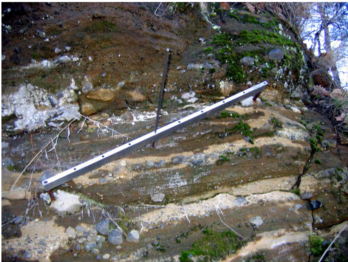
Obr. 1.115 Situovanie meradla mikromorfologických zmien povrchu horniny na skalnej stene oproti katastrofálnemu handlovskému zosuvu (lokalita Handlová-Baňa)
