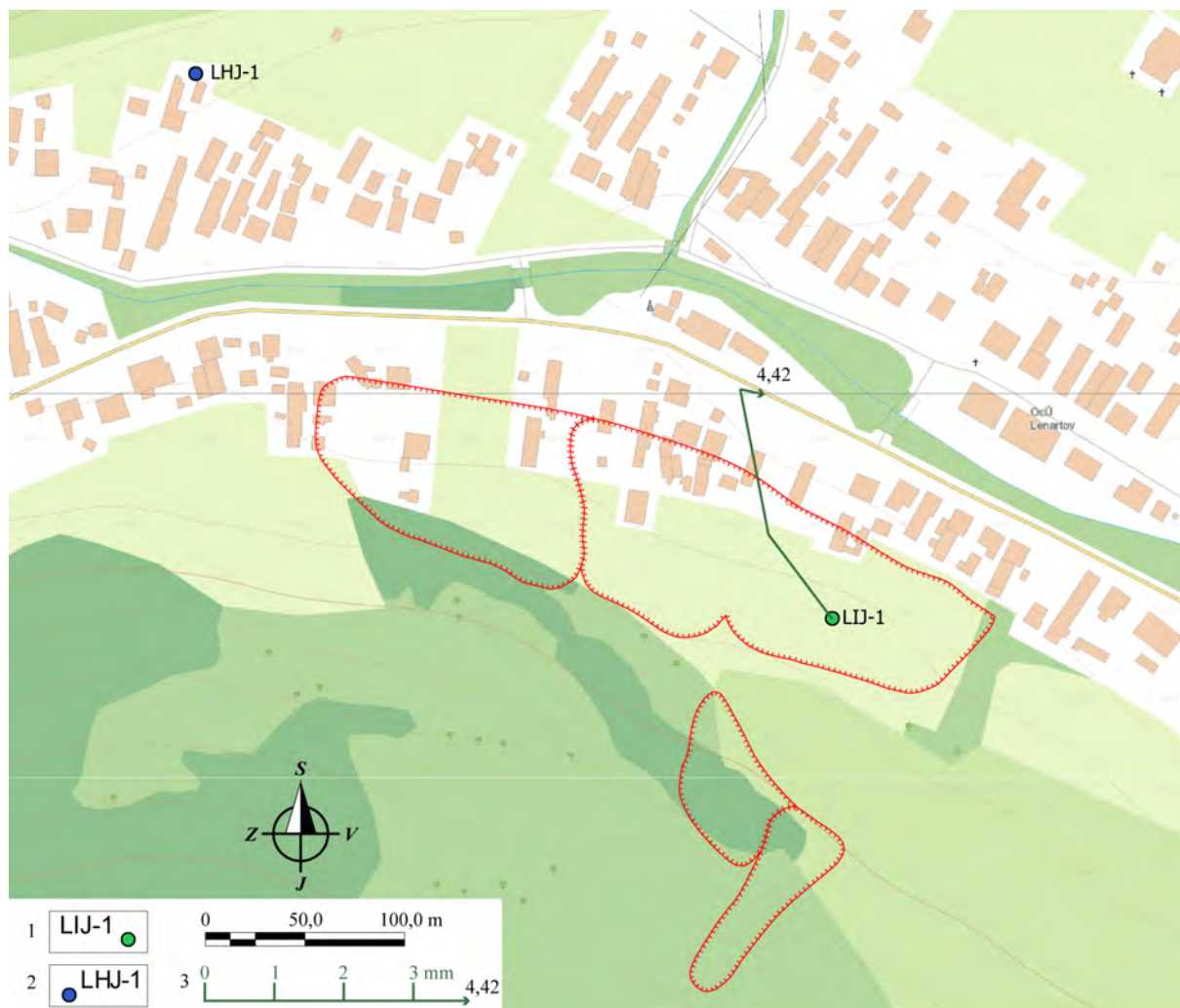
Obr. 1.59 Lokalita Lenartov – výsledky inklinometrických meraní v rokoch 2011 a 2012. 1 – inklinometrický vrt, 2 – piezometrický vrt, 3 – mierka vektorov deformácie inklinometrickej pažnice za obdobie XII. 11 – III. 12 – VIII. 12 – X. 12 (číslo označuje hĺbku zaznamenatej deformácie od povrchu terénu v m), červená línia – ohraničenie zosuvov; mapový podklad: ZBGIS®
