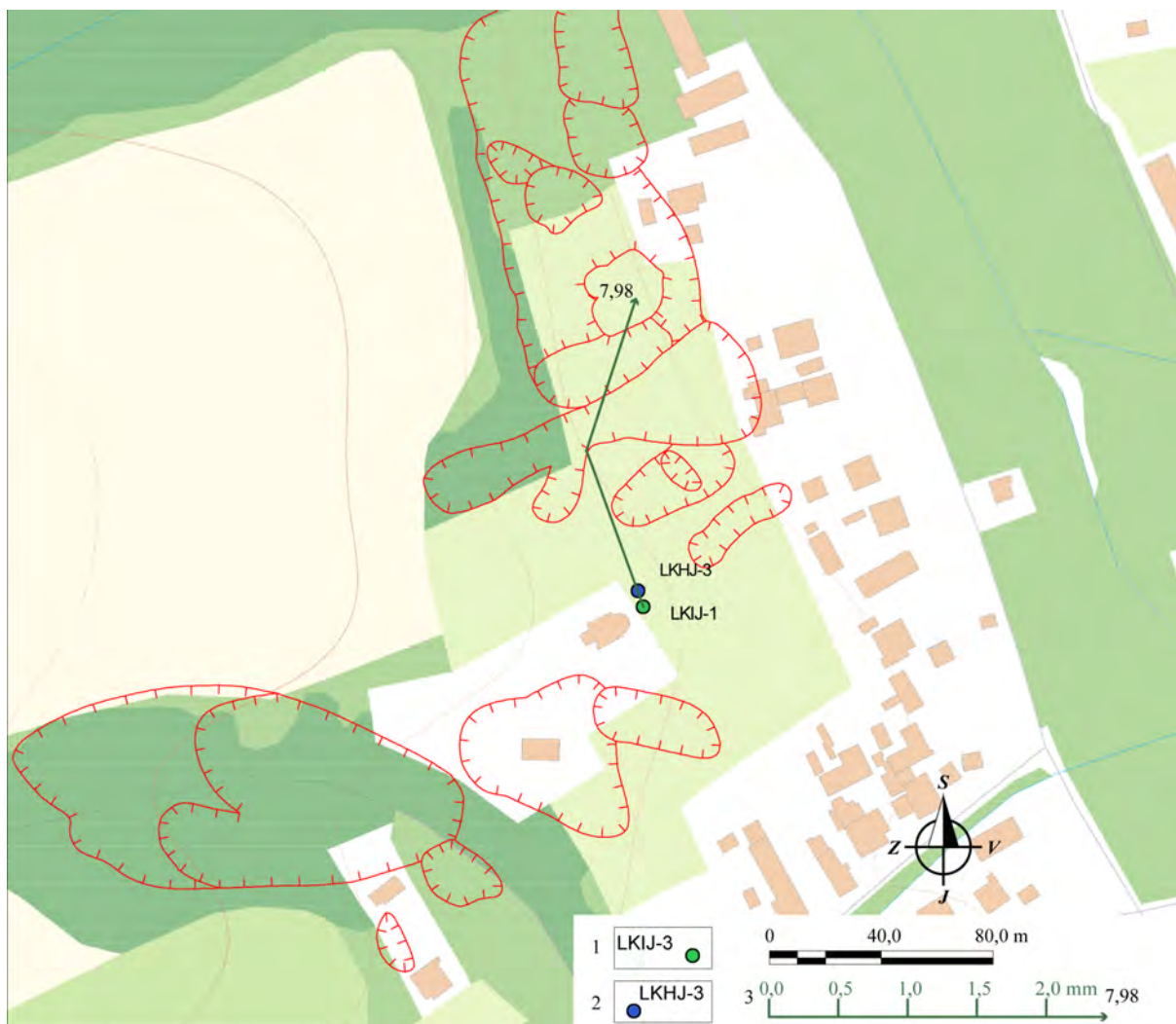
Obr. 1.62 Lokalita Lukov – výsledky inklinometrických meraní v rokoch 2011 a 2012. 1 – inklinometrický vrt, 2 – piezometrický vrt, 3 – mierka vektorov deformácie inklinometrickej pažnice za obdobie XII. 11 – III. 12 – VIII. 12 – X. 12 (číslo označuje hĺbku zaznamenananej deformácie od povrchu terénu v m), červená línia – ohraničenie zosuvov; mapový podklad: ZBGIS®
