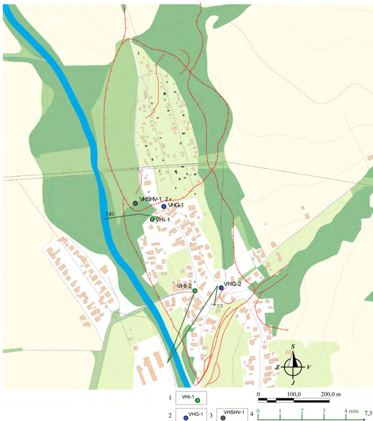
Obr. 1.90 Lokalita Vyšná Hutka – výsledky inklinometrických meraní v rokoch 2011 a 2012. 1 – inklinometrický vrt, 2 – piezometrický vrt, 3 – subhorizontálny odvodňovací vrt, 4 – mierka vektorov deformácie inklinometrickej pažnice za obdobie XII. 11 – III. 12 – VIII. 12 – X. 12 (číslo označuje hĺbku zaznamenananej deformácie od povrchu terénu v m), červená línia – ohraňenie zosuvov; mapový podklad: ZBGIS®
