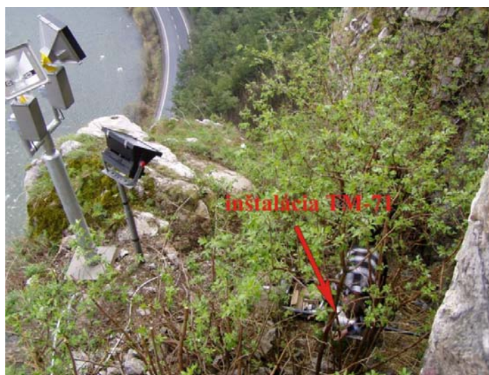
Obr. 22 Pozícia dilatometra TM-71 v trhline pod kaplnkou hradu Strečno
