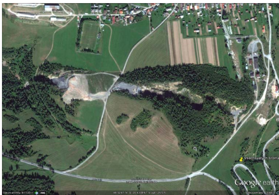
Obr. 14 Zavážanie závalového pásma J od obce Poráč elektrárenským popolčekom – situácia z 31.12.2006 (hore) a z 9.11.2011; družicové snímky Google Earth
