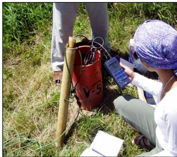
Obr. 2.3.2. Meranie vodivosti a teploty vo vrtoch
