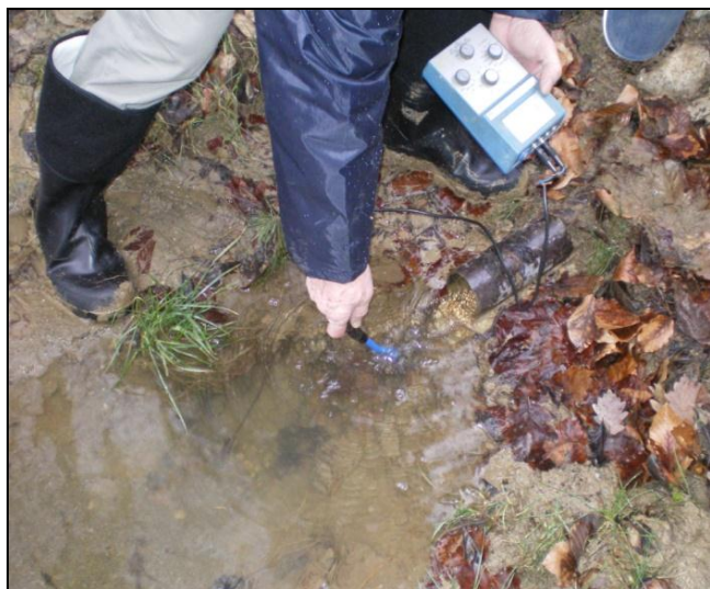
Obr. 2.3.1. Meranie vodivosti a teploty v prirodzených výveroch
