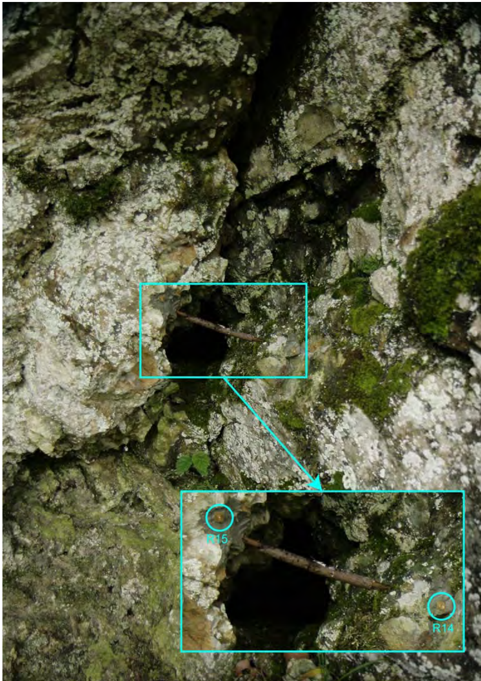
Obr. 2.1.83: Umiestnenie pozorovacích bodov R14 a R15 (Stanovisko 2) pre merania dilatometrom Somet na lokalite Pod večným dažďom (Slovenský raj) – foto P. Ondrejka, 2007
