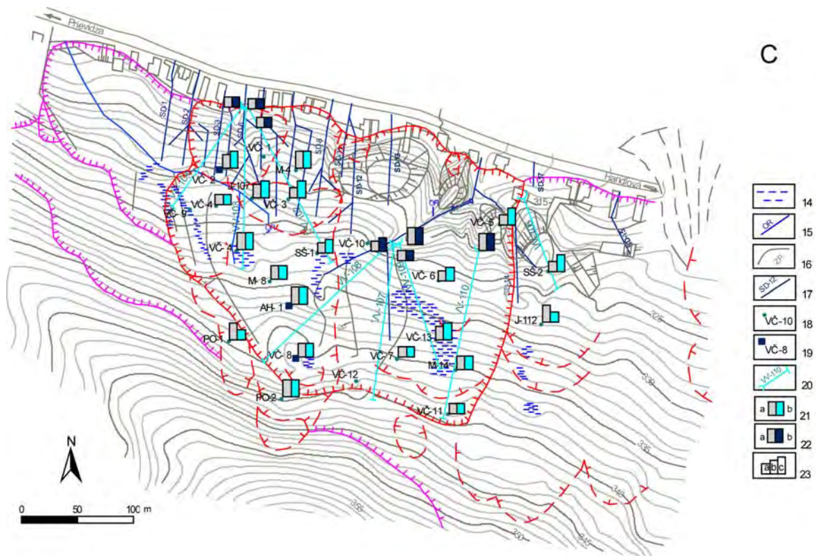
Obr. 2.1.4C: Lokalita Velká Čausa – výsledky režimových pozorování. 14 – zamokrené územia, 15 – dláždené odvodňovacie rigoly, 16 – zemné odvodňovacie priekopy, 17 – sanačné drenáže a stabilizačné rebrá, 18 – pozorované vertikálne vrty, 19 – vrty s automatickými hladinomeri, 20 – odvodňovacie subhorizontálne vrty, 21 – režimové pozorovania zmien hĺbky hladiny podzemnej vody v roku: a – 2009, b – 2010, 22 – režimové pozorovania zmien výdatnosti odvodňovacích zariadení v roku: a – 2009, b – 2010, 23 – hodnotenie režimových pozorování podľa kritérií, zhrnutých v tab. 2.1.6: a – stav priaznivý (stupeň 1) vo vertikálnych vrtoch, resp. priemerná výdatnosť do 1 \text{ l} \cdot \text{min}^{-1} v horizontálnych vrtoch, b – náznaky nepriaznivého stavu (stupeň 2), resp. priemerná výdatnosť 1 až 3 \text{ l} \cdot \text{min}^{-1} , c – stav nepriaznivý (stupeň 3), resp. priemerná výdatnosť nad 3 \text{ l} \cdot \text{min}^{-1}
