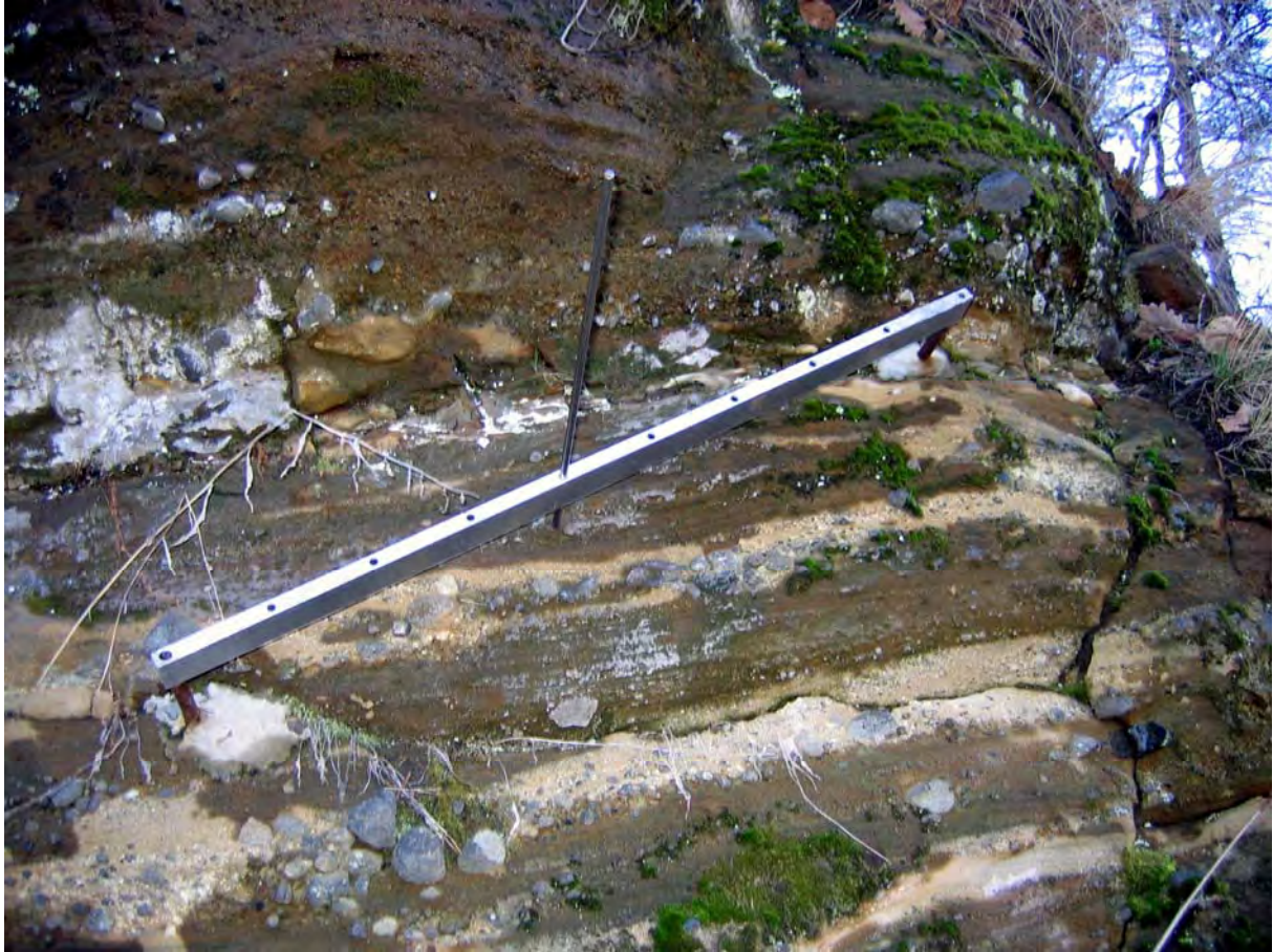
Obr. 2.1.73: Situovanie meradla mikromorfologických zmien povrchu horniny na skalnej stene oproti katastrofálnemu handlovskému zosuvu (lokalita Handlová-Baňa; foto P. Liščák, 2005)
