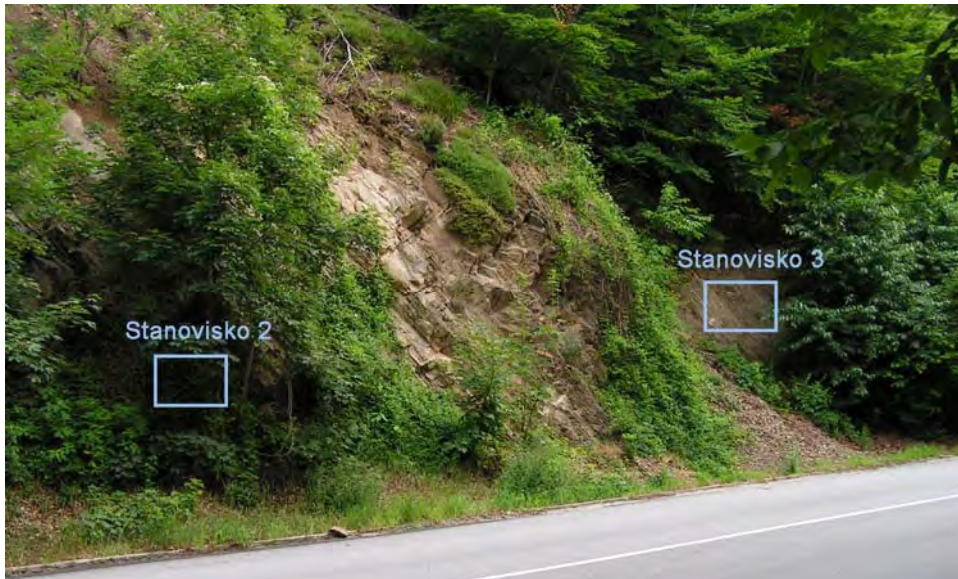
Obr. 2.1.93: Situovanie stanovísk 2 a 3 na lokalite Pezinská Baba na meranie mikromorfologických zmien povrchu horniny na svahu odrezu cesty (foto P. Ondrejka, 2007)
