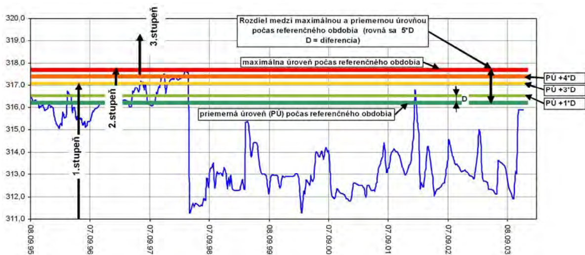
Obr. 2.1.3: Postup odvodenia referenčných hodnôt pre semikvantitatívne hodnotenie zmien úrovně hladiny podzemnej vody, obsiahnuté v tab. 2.1.6 (záznam z pozorovania hladiny podzemnej vody vo vrte VČ-4 z lokality Veľká Čausa). Postup vypracoval S. Scherer (2004)
