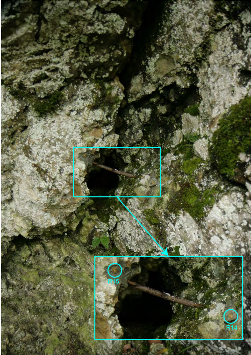
Obr. 2.1.141: Umiestnenie pozorovacích bodov R14 a R15 (Stanovisko 2) pre merania dilatometrom Somet na lokalite Pod večným dažďom (Slovenský raj) – foto M. Brček, 2009
