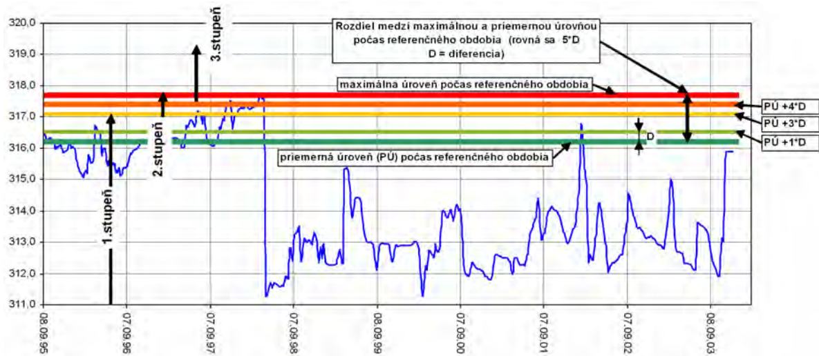
Obr. 2.1.2: Postup odvodenia referenčných hodnôt pre semikvantitatívne hodnotenie zmien úrovnne hladiny podzemnej vody, obsiahnuté v tab. 2.1.6 (záznam z pozorovania hladiny podzemnej vody vo vrte VČ-4 z lokality Veľká Čausa). Postup vypracoval S. Scherer (2004)
