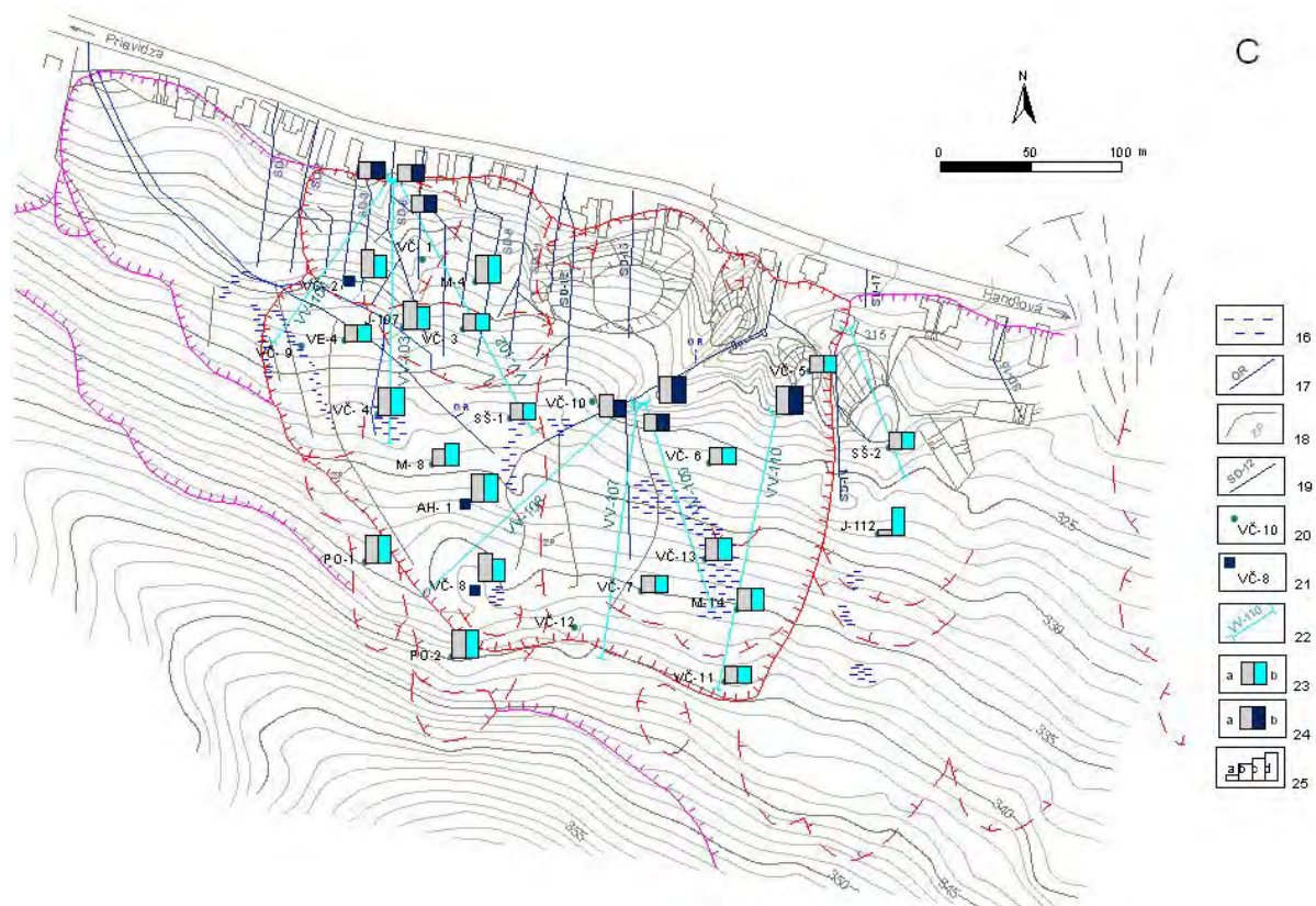
Obr. 2.1.5c: Lokalita Veľká Čausa – výsledky režimových pozorovaní. 16 – zamokrené územia, 17 – dláždené odvodňovacie rigoly, 18 – zemné odvodňovacie priekopy, 19 – sanačné drenážne a stabilizačné rebrá, 20 – pozorované vertikálne vrty, 21 – vrty s automatickými hladinomeri, 22 – odvodňovacie subhorizontálne vrty, 23 – režimové pozorovania zmien hĺbky hladiny podzemnej vody v roku: a – 2008, b – 2009, 24 – režimové pozorovania zmien výdatnosti odvodňovacích zariadení v roku: a – 2008, b – 2009, 25 – hodnotenie režimových pozorovaní podľa kritérií, zhrnutých v tab. 2.1.6: a – namerané, b – stav priaznivý (stupeň 1) vo vertikálnych vrtoch, resp. priemerná výdatnosť do 1 \text{ l} \cdot \text{min}^{-1} v horizontálnych vrtoch, c – náznaky nepriaznivého stavu (stupeň 2), resp. priemerná výdatnosť 1 až 3 \text{ l} \cdot \text{min}^{-1} , d – stav nepriaznivý (stupeň 3), resp. priemerná výdatnosť nad 3 \text{ l} \cdot \text{min}^{-1}
