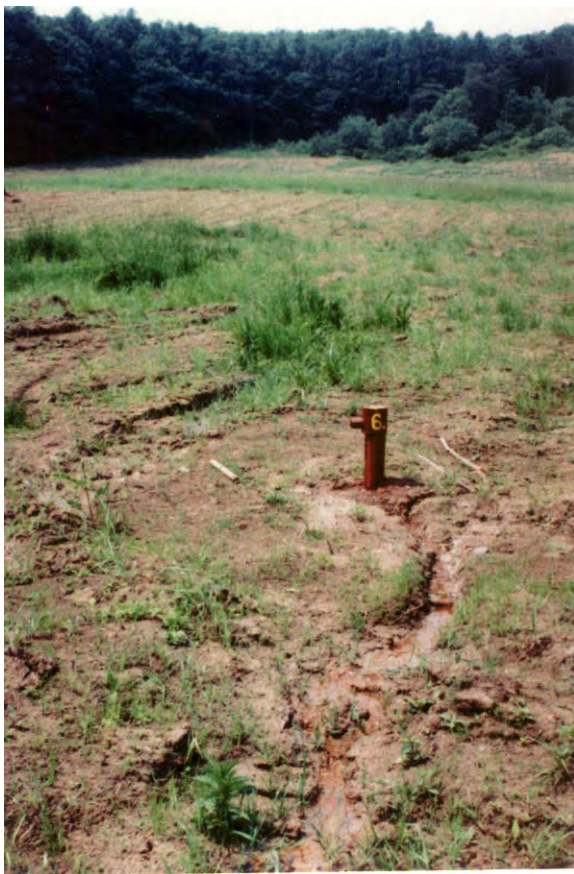
Obr. 2.1.99: Pohľad od prelivového vrtu MČ-6 na časť sanovaného zosuvu pri Malej Čausi (foto D. Jadroň, 1997)
