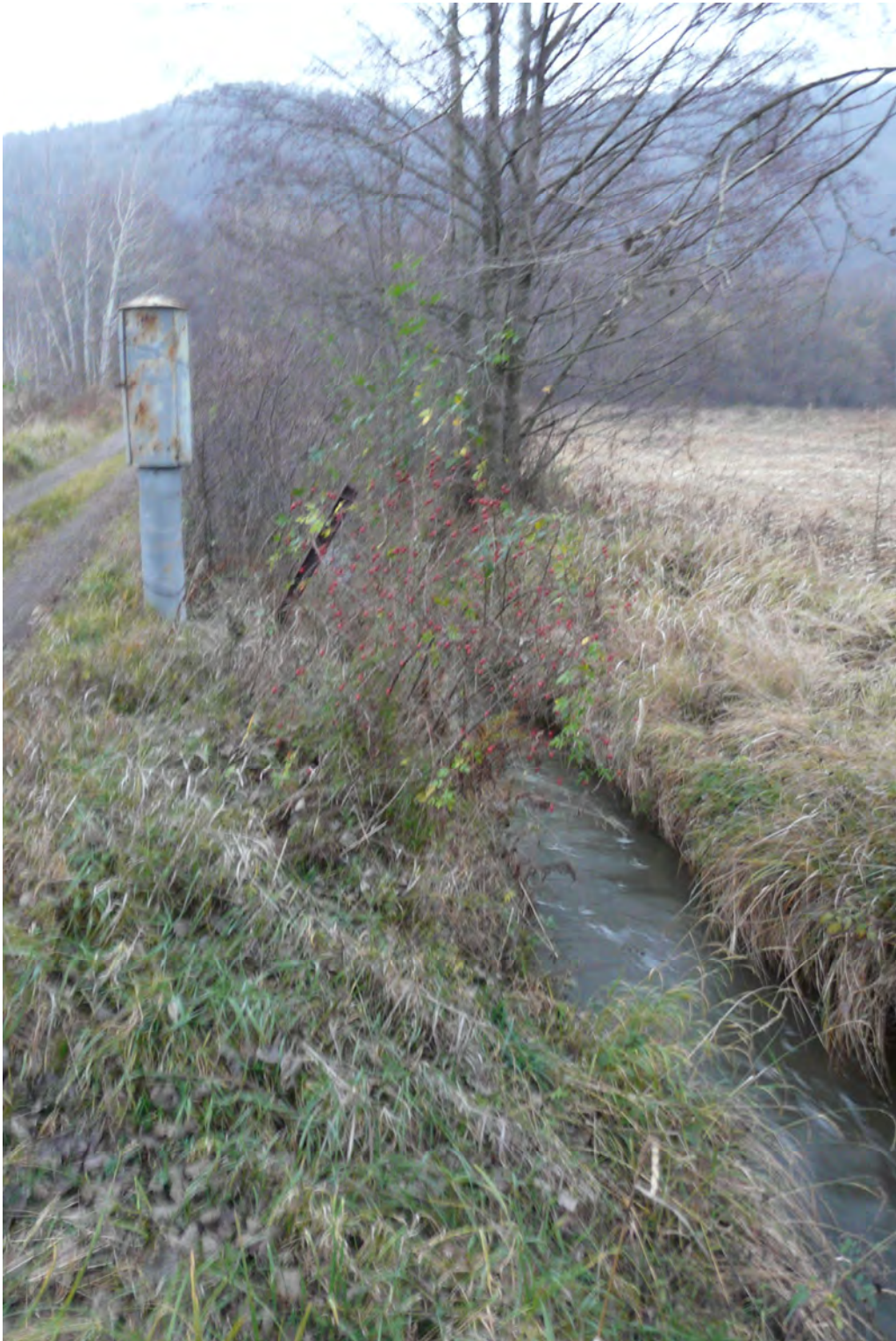
Obr. 81: Lokalita Kremnica. Opustený merný profil s limnigrafom pod ústím Hlavnej dediny -tôlne pred vtokom do Hrona.. Foto ó P. Bajto-, 13.11.2008.
