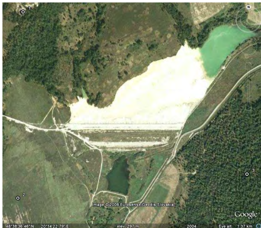
Obr. 2: Lokalita Jelšava. Odkalisko SMZ Jelšava v hornej časti s jazierkom. Pod jeho hrádzou havarijná nádrž. Zdroj: Google Earth, satelitná snímka z roku 2004.
