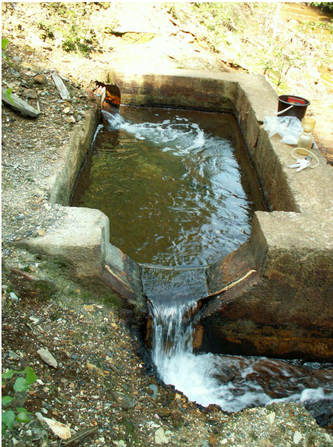
Obr. 56: Lokalita Smolník. Detail merného objektu banskej vody -achty Pech. Foto: P. Bajto-, 30.6.2008.
