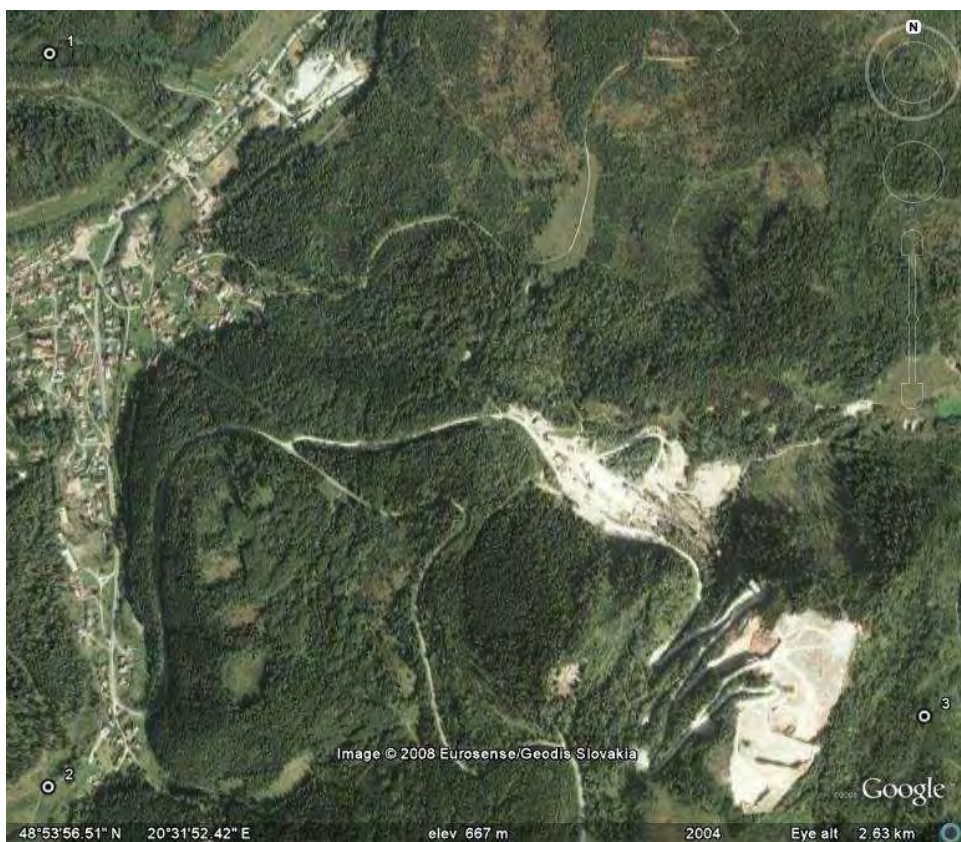
Obr.30: Lokalita Novoveská Huta. Vápencový lom Gréťla V od obce Novoveská Huta, S od neho sa v smere Z – V tiahne pásmo závalov nad vyťaženými časťami sadrovcového ložiska Tollstein ťaženého úpadnicou z Novoveskej Hutu. Zdroj: Google Earth, satelitná snímka z roku 2004.
