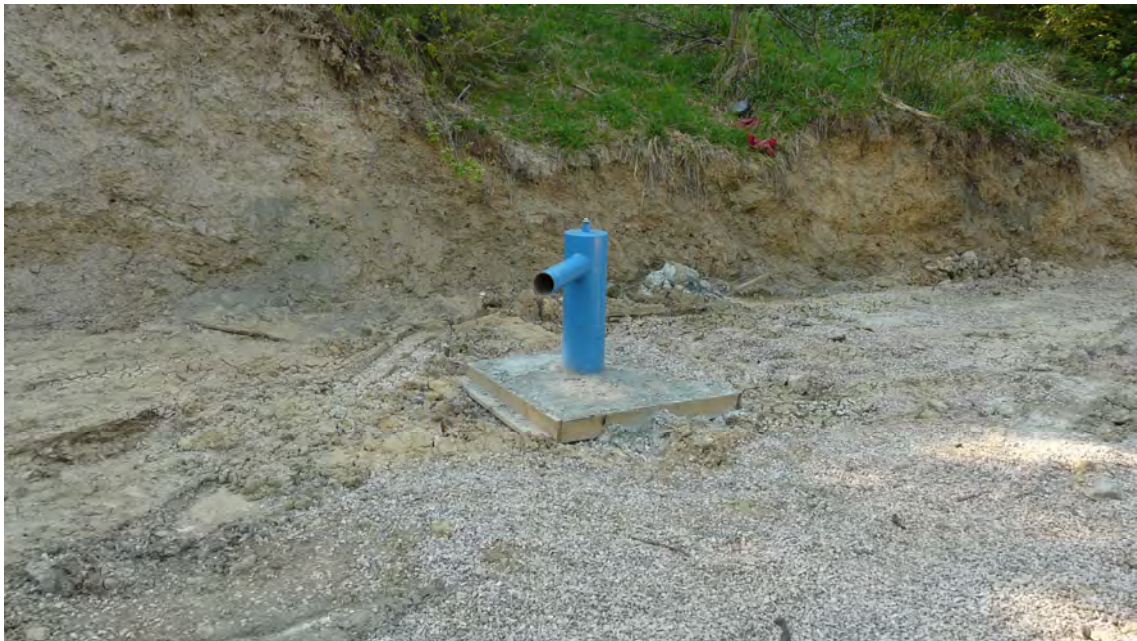
Obr. 112: Teplá ka nad Hornádom ako následky prievahu banskej vody z Novej Ťolne. Monitorovací vrt situovaný do Novej Ťolne nad závalom. Priemer krátera 15 m, hĺbka 8-10 m. Foto: P. Bajtoš, 3.5.2009.
