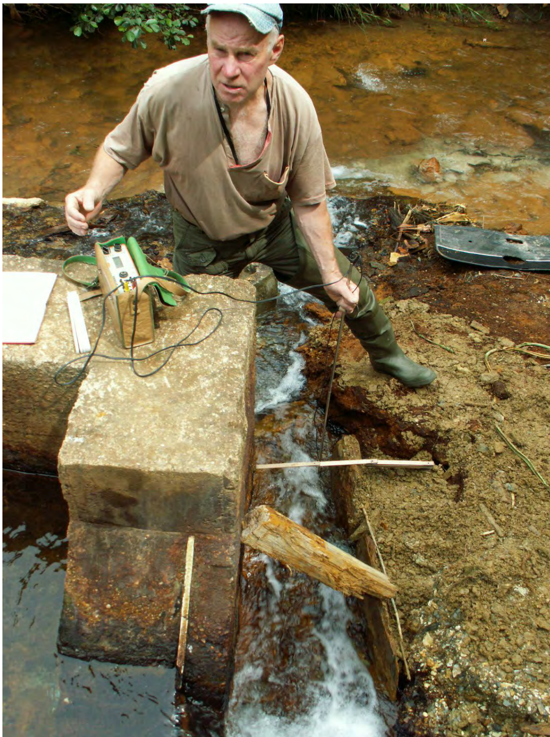
Obr. 57: Lokalita Smolník. Detail merného objektu banskej vody –achty Pech. Pre po–kodenie prelivovej hrany je nemožné merať pomocou výšky prepadu, pre nevhodné osadenie objektu je nemožné merať do nádoby. Improvizované hydrometrické merania J. Blahuta. Foto: P. Bajtoš, 30.6.2008.
