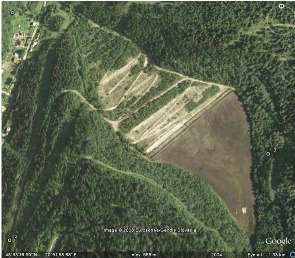
Obr. 25: Lokalita Slovinky. Nové odkalisko so zčasti rekultivovanou spodnou časťou. Zdroj: Google Earth, satelitná snímka z roku 2004.
