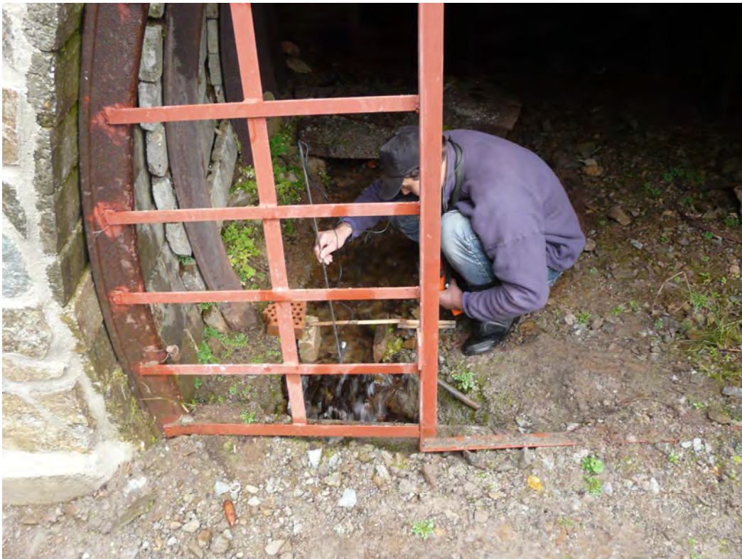
Obr. 90: Lokalita Dúbrava. Hydrometrické meranie prietoku banskej vody v ústí –tôlne Rakytová. Foto: P. Bajtoš, 3.10.2008.
