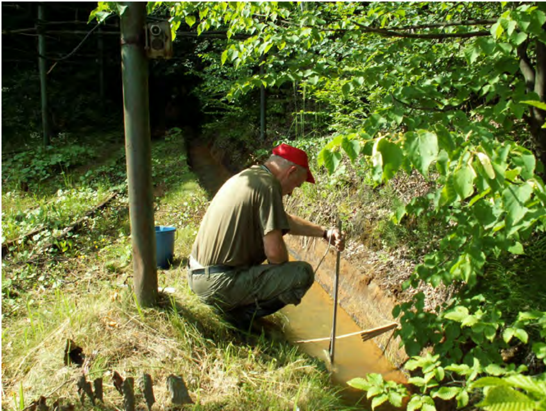
Obr. 39: Lokalita Slovinky. Meranie prietoku výtoku banskej vody zo ťólne Alfbeta v Slovinkách. Hydrometruje Jozef Blahut. Foto: P. Bajto-, 26.6.2008
