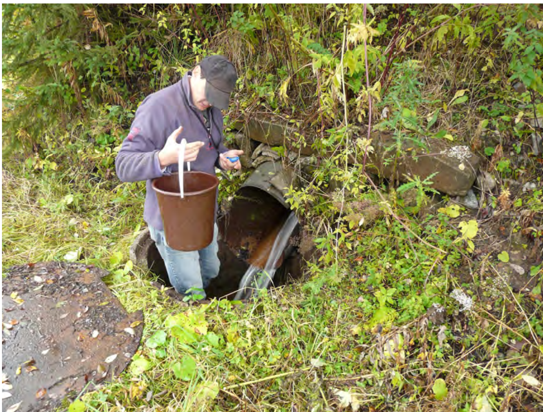
Obr. 92: Lokalita Dúbrava. Meranie prietoku banskej vody S. Olek-ák v prepadovej -achte pod ústím -tölne Flota ná. Foto: P. Bajto-, 3.10.2008.
