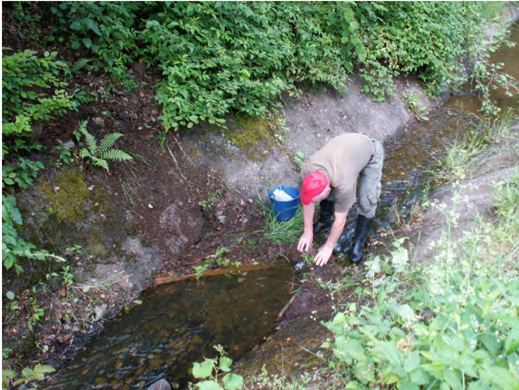
Obr. 44: Lokalita Slovinky. Meranie prietoku potô ka (v odvod ovacom rigole) pritekajúceho k starému odkalisku Slovinky z vyšie položeného úseku doliny. Foto: P. Bajtoš, 26.6.2008
