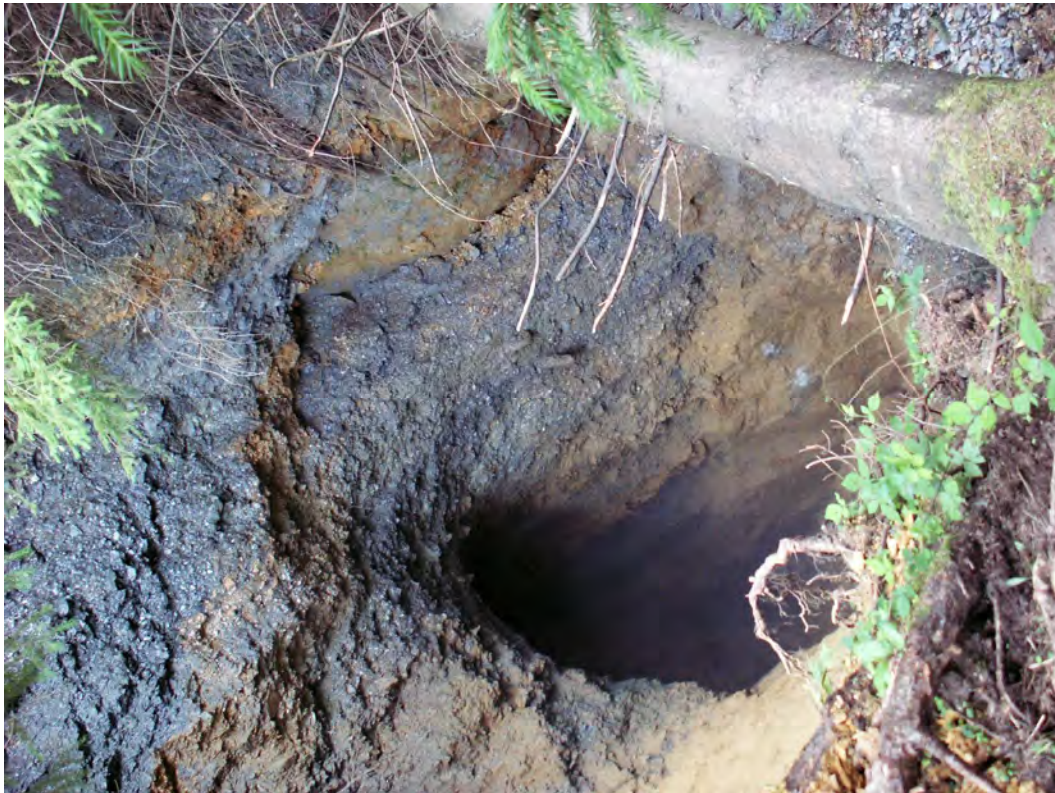
Obr. 67: Lokalita Smolník. Nový zával pri ceste nad odkaliskom - komín h bky vy-e 4 m s ústím 3,5x3 m. Foto: P. Bajto-, 30.6.2008.
