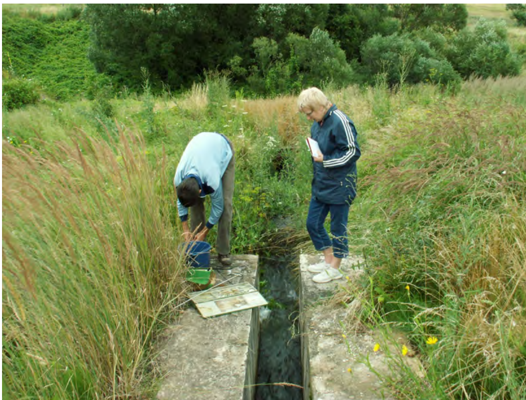
Obr. 7: Lokalita Jel-ava. Merný objekt priesaku z odkaliska SMZ Jel-ava. Meranie prietoku (P. Bajto-, . Záhorová). Foto: P. Baláfl, 15.7.2008.
