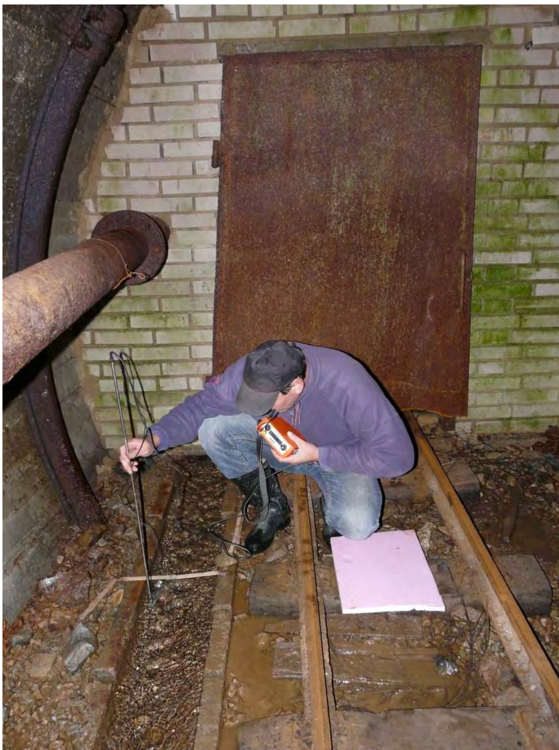
Obr. 82: Lokalita Dúbrava. Hydrometrické meranie profilu v -tôlni Martin S. Olek-ákom. Foto: P. Bajto-, 3.10.2008.
