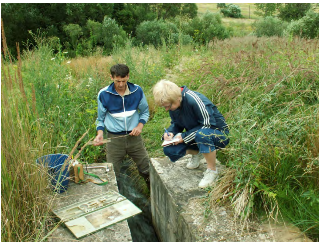
Obr. 8: Lokalita Jel-ava. Merný objekt priesaku z odkaliska SMZ Jel-ava. Meranie prietoku (P. Bajto-, . Záhorová). Foto: P. Baláfl, 15.7.2008.
