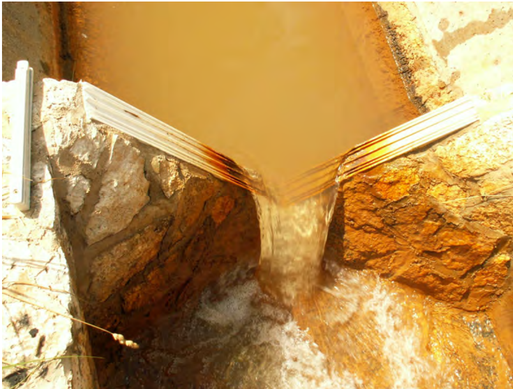
Obr. 42: Lokalita Slovinky. Prepadová hrana na mernom objekte na výtoku banskej vody zo -tólne Alfbeta v Slovinkách. Prepadová hrana neumofl uje presné meranie ó jej hrúbka je 7 cm. Foto: P. Bajto-, 26.6.2008
