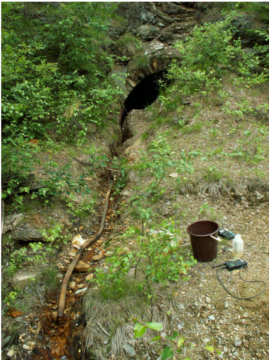
Obr. 58: Lokalita Smolník. Ústie ťôlne Karitas s odtokom banskej vody zvedenom gumenou hadicou. Foto: P. Bajtoš, 30.6.2008.
