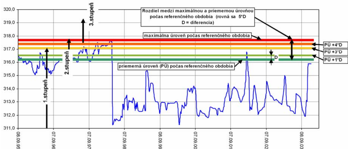
Obr. 2.1.2: Postup odvodenia referenčných hodnôt pre semikvantitatívne hodnotenie zmien úrovne hladiny podzemnej vody, obsiahnuté v tab. 2.1.4 (záznam z pozorovania hladiny podzemnej vody vo vrte VČ-4 z lokality Veľká Čausa – vypracoval S. Scherer, 2004)
