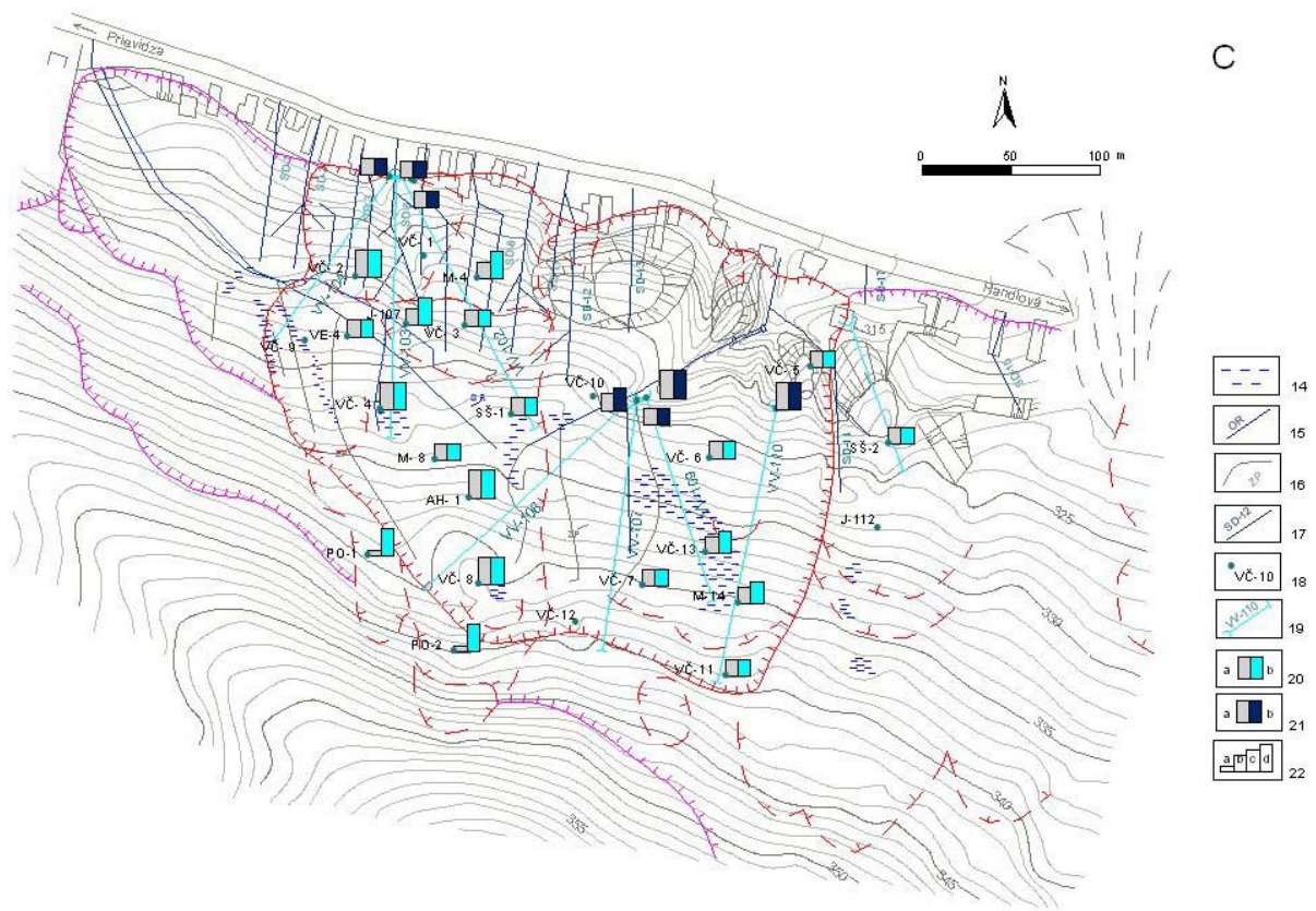
Obr. 2.1.3C: Lokalita Veľká Čausa – výsledky režimových pozorovaní. 14 – zamokrené územia, 15 – dláždené odvodňovacie rigoly, 16 – zemné odvodňovacie priekopy, 17 – sanačné drenážne a stabilizačné rebrá, 18 – pozorované vertikálne vrty, 19 – odvodňovacie subhorizontálne vrty, 20 – režimové pozorovania zmien hĺbky hladiny podzemnej vody v roku: a – 2007, b – 2008, 21 – režimové pozorovania zmien výdatnosti odvodňovacích zariadení v roku: a – 2007, b – 2008, 22 – hodnotenie režimových pozorovaní podľa kritérií, zhrnutých v tab. 2.1.4: a – namerané, b – stav priaznivý (stupeň 1) vo vertikálnych vrtoch, resp. priemerná výdatnosť do 1 l.min -1 v horizontálnych vrtoch, c – náznaky nepriaznivého stavu (stupeň 2), resp. priemerná výdatnosť 1 až 3 l.min -1 , d – stav nepriaznivý (stupeň 3), resp. priemerná výdatnosť nad 3 l.min -1
