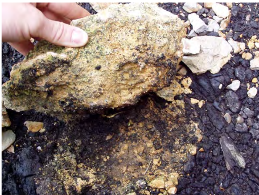
Obr. 8 Kontakt kyských gudrónov a zásaditých vápencov
