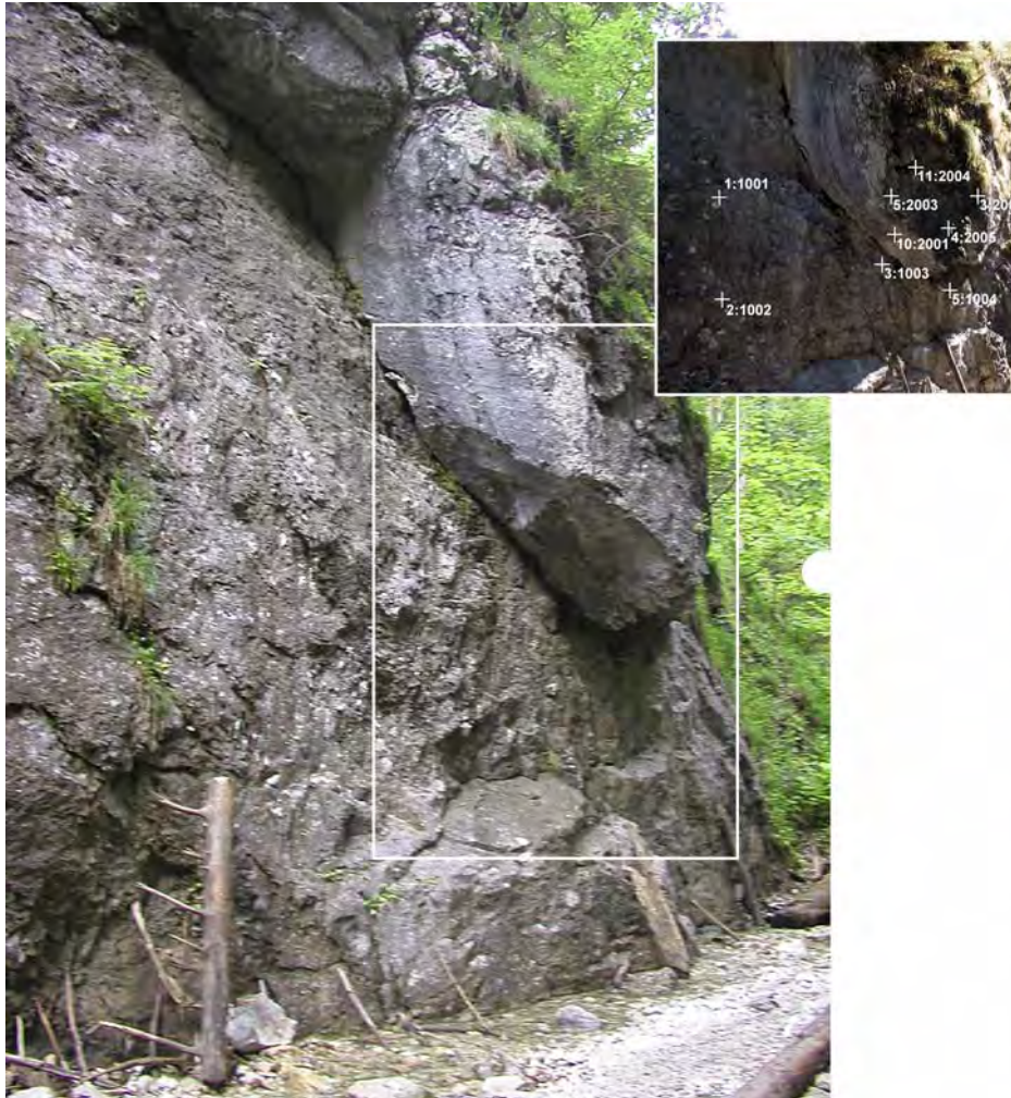
Obr. 2.1.78: Potenciálne nestabilný skalný blok nad turistickým chodníkom v doline Suchá Belá (Slovenský raj). V detaile je rozmiestnenie vzťažných a pozorovaných bodov pre fotogrametrické snímkovanie
