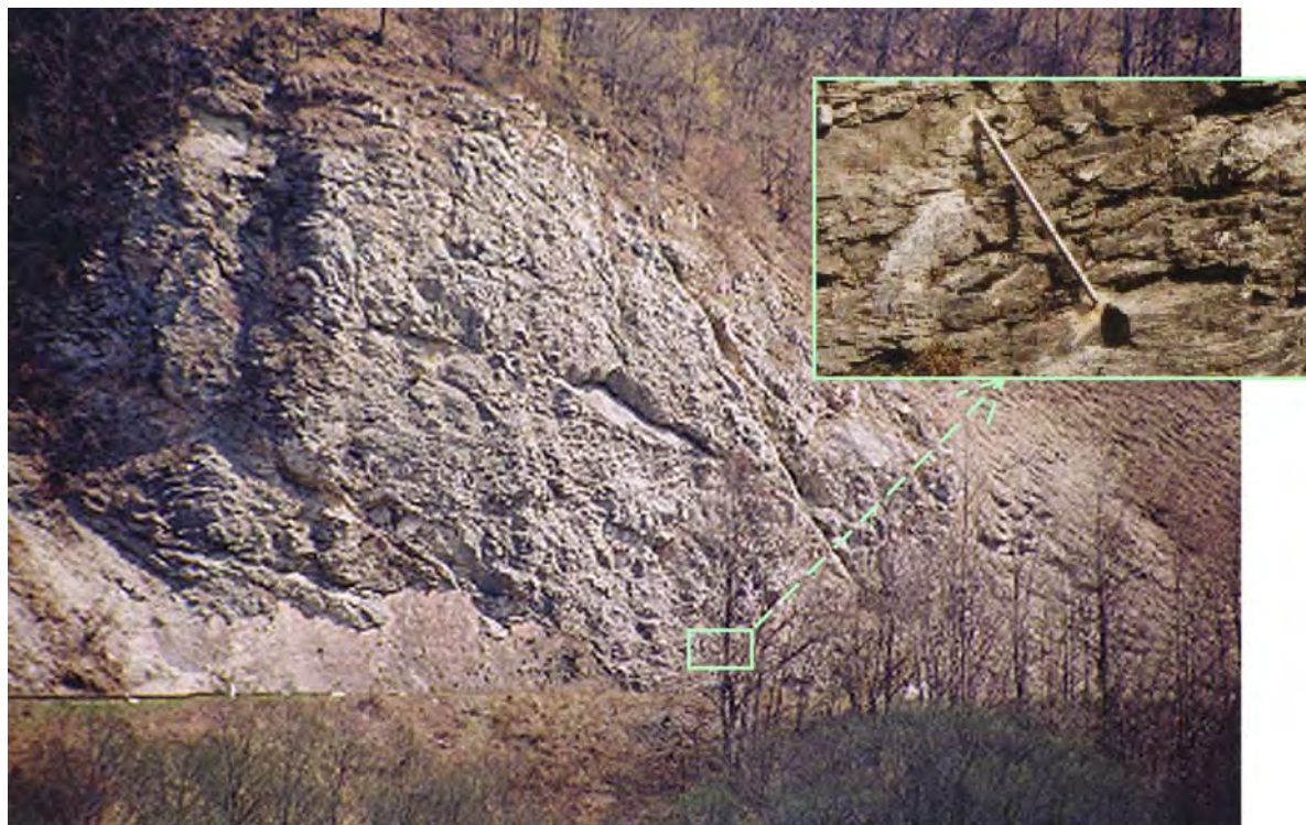
Obr. 2.1.84: Skalná stena zárezu lokality Jakub, na ktorej sa vykonáva meranie mikromorfologických zmien povrchu (s detailom umiestnenia meradla morfologických zmien)
