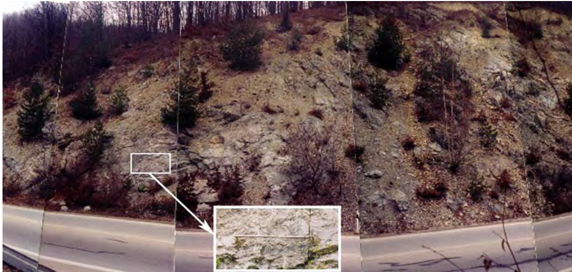
Obr. 2.1.90: Skalná stena odrezu cesty na lokalite Lipovník (s detailom umiestnenia meradla mikromorfologických zmien)
