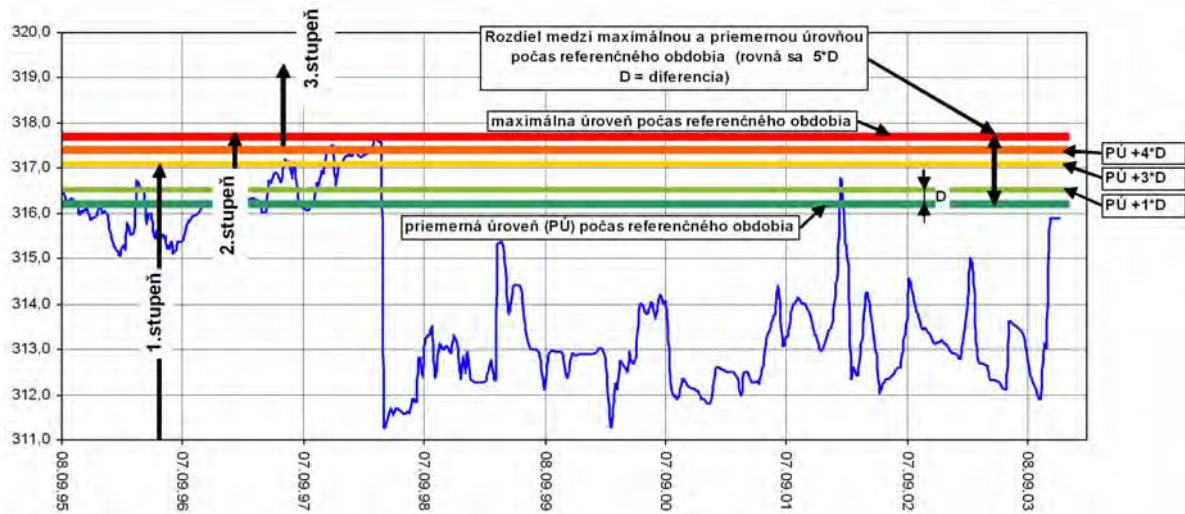
Obr. 2.1.2: Postup odvodenia referenčných hodnôt pre semikvantitatívne hodnotenie zmien úrovne hladiny podzemnej vody, obsiahnuté v tab. 2.1.5 (záznam z pozorovania hladiny podzemnej vody vo vrte VČ-4 z lokality Veľká Čausa – vypracoval S. Scherer, 2004)
