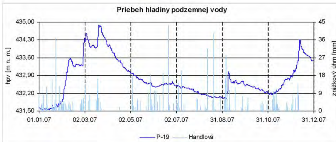
Obr. 2.1.11: Priebeh zmien úrovne hladiny podzemnej vody (hpv), zaznamenaný v roku 2007 automatickými hladinomermi, umiestnenými vo vrtoch P-17 a P-19 na lokalite Handlová – Morovnianske sídlisko spoločne so znázornením denných zrážkových úhrnov zo stanice SHMÚ v Handlovej
