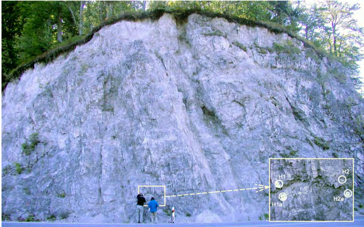
Obr. 2.1.82: Rozmiestnenie pozorovacích bodov (H1, H1', H2, H2') na monitorovanom úseku zárezu cesty medzi Dolným Harmancom a Čremošným pre merania dilatometrom Somet
