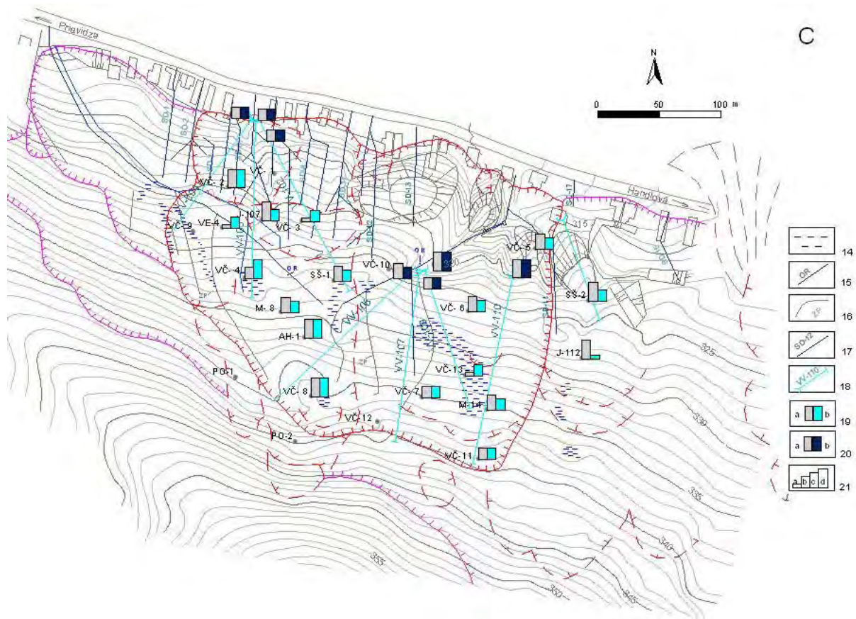
Obr. 2.1.3C: Lokalita Veľká Čausa – výsledky režimových pozorovaní. 14 – zamokrené územia, 15 – dláždené odvodňovacie rigoly, 16 – zemné odvodňovacie priekopy, 17 – sanačné drenáže a stabilizačné rebrá, 18 – odvodňovacie subhorizontálne vrty, 19 – režimové pozorovania zmien hĺbky hladiny podzemnej vody v roku: a – 2006, b – 2007, 20 – režimové pozorovania zmien výdatnosti odvodňovacích zariadení v roku: a – 2006, b – 2007, 21 – hodnotenie režimových pozorovaní podľa kritérií, zhrnutých v tab. 2.1.5: a – namerané, b – stav priaznivý (stupeň 1) vo vertikálnych vrtoch, resp. priemerná výdatnosť do 1 \text{ l.min}^{-1} v horizontálnych vrtoch, c – náznaky nepriaznivého stavu (stupeň 2), resp. priemerná výdatnosť 1 až 3 \text{ l.min}^{-1} , d – stav nepriaznivý (stupeň 3), resp. priemerná výdatnosť nad 3 \text{ l.min}^{-1}
