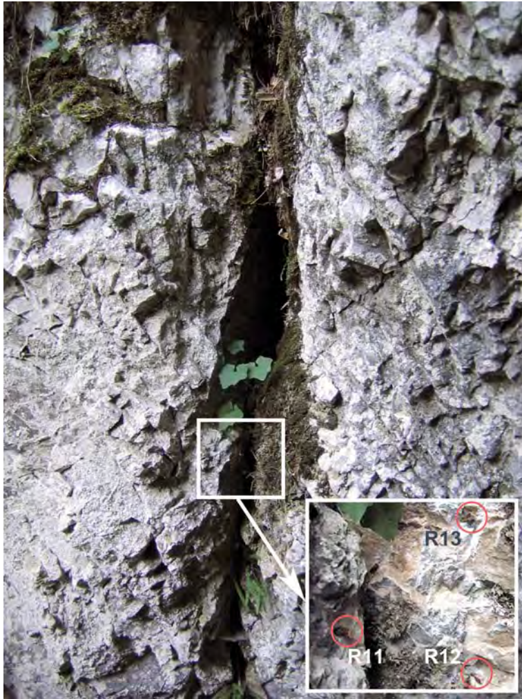
Obr. 2.1.80: Umiestnenie pozorovacích bodov R11, R12 a R13 pre merania dilatometrom Somet na lokalite Pod večným dažďom (Slovenský raj)
