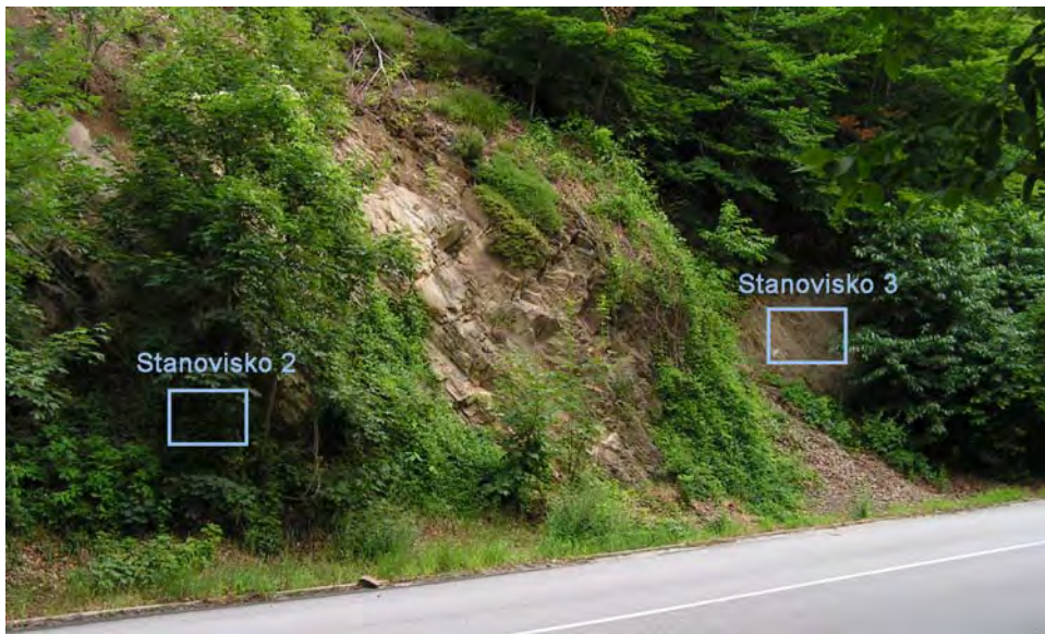
Obr. 2.1.88: Situovanie stanovísk 2 a 3 na lokalite Pezinská Baba na meranie mikromorfologických zmien povrchu horniny na svahu odrezu cesty
