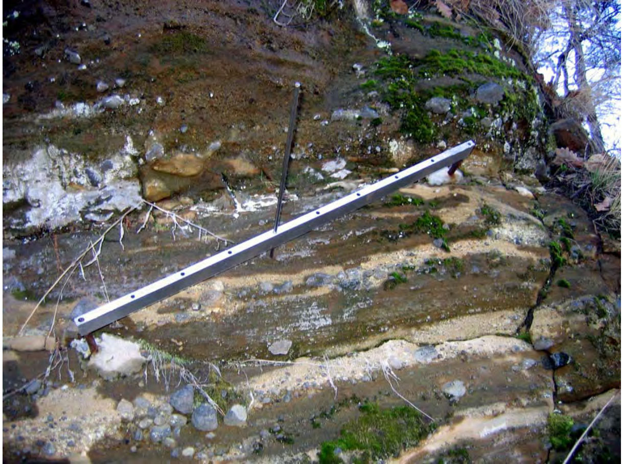
Obr. 2.1.29: Situovanie meradla mikromorfologických zmien povrchu horniny na skalnej stene oproti katastrofálnemu handlovskému zosuvu
