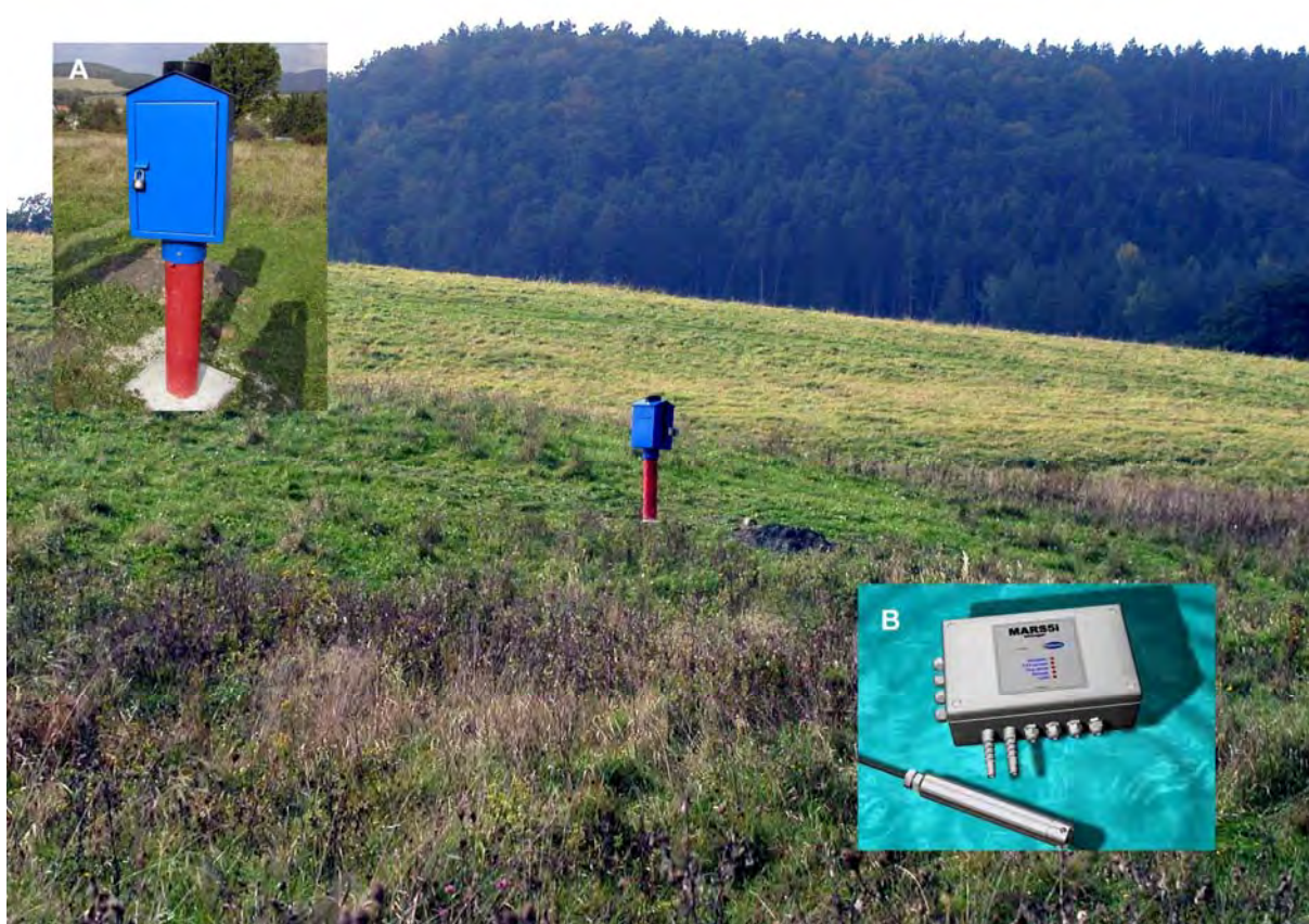
Obr. 2.1.4: Datalogger MARS5i na zosuvnom území Veľká Čausa. A – umiestnenie prístroja v ochrannom zariadení vo vrte AH-1, B – datalogger a meracia sonda
