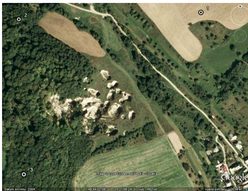
Obr. 40: Lokalita Nižná Slaná. Skupina kráterovitých závalov nad vyťaženými časťami ložiska Kobeliarovo SZ od obce Kobeliarovo. Zdroj: Google Earth, satelitná snímka z roku 2004
