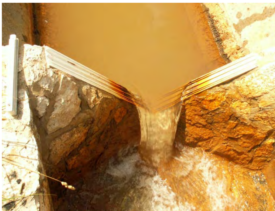
Obr. 42: Lokalita Slovinky. Prepadová hrana na mernom objekte na výtoku banskej vody zo štólne Alžbeta v Slovinkách. Prepadová hrana neumožňuje presné meranie – jej hrúbka je 7 cm. Foto: P. Bajtoš, 26.6.2008
