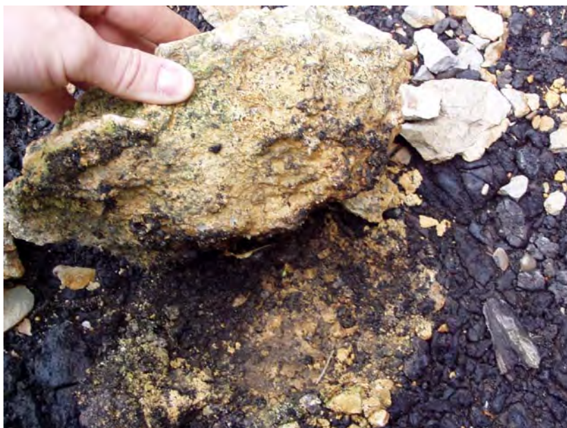
Obr. 2.3.45: Kontakt kyslých gudrónov a zásaditých vápencov
