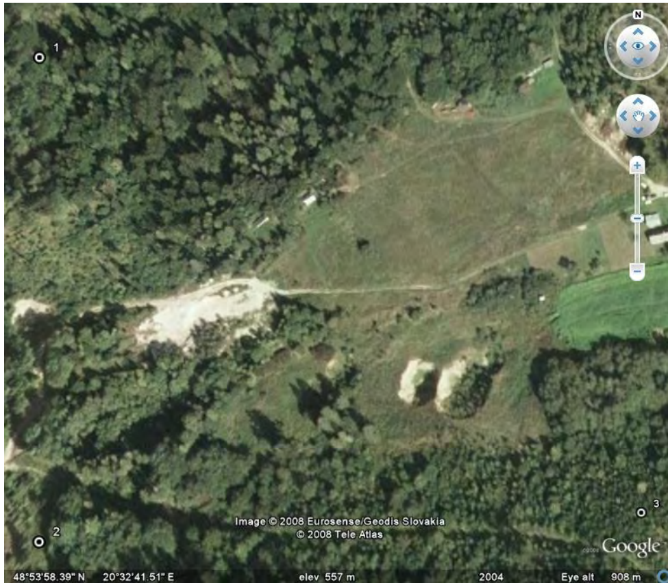
Obr. 31: Lokalita Novoveská Huta. Skupina kráterovitých závalov v doline Podzámčiská – časť závalového pásma sadrovcového ložiska Tollstein. Zdroj: Google Earth, satelitná snímka z roku 2004
