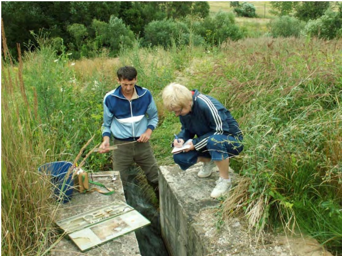
Obr. 8: Lokalita Jelšava. Merný objekt priesaku z odkaliska SMZ Jelšava. Meranie prietoku (P. Bajtoš, Ľ. Záhorová). Foto: P. Baláž, 15.7.2008
