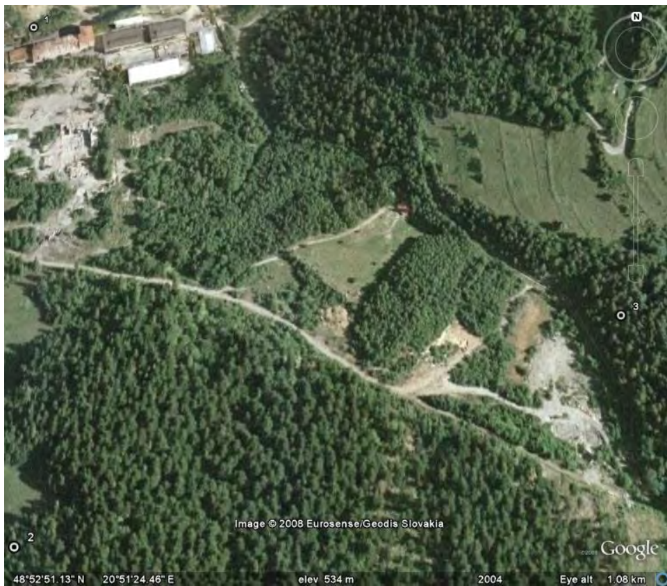
Obr. 24: Lokalita Slovinky. J časť bývalého ťažobno - spracovateľského závodu ŽB (vľavo hore) so Starým odkaliskom (trojuholník obmedzený z J cestou a zo S regulovaným potokom). Zdroj: Google Earth, satelitná snímka z roku 2004
