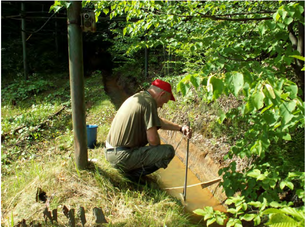
Obr. 39: Lokalita Slovinky. Meranie prietoku výťoku banskej vody zo štólne Alžbeta v Slovinkách. Hydrometruje Jozef Blahut. Foto: P. Bajtoš, 26.6.2008
