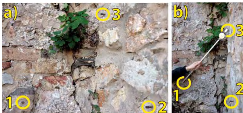
Obr. 2.6.53: Monitorovacie stanovisko Somet 1 (oblúky); a) pohľad na meracie body, b) ukážka merania dilatácie trhliny medzi bodmi 1 – 3
