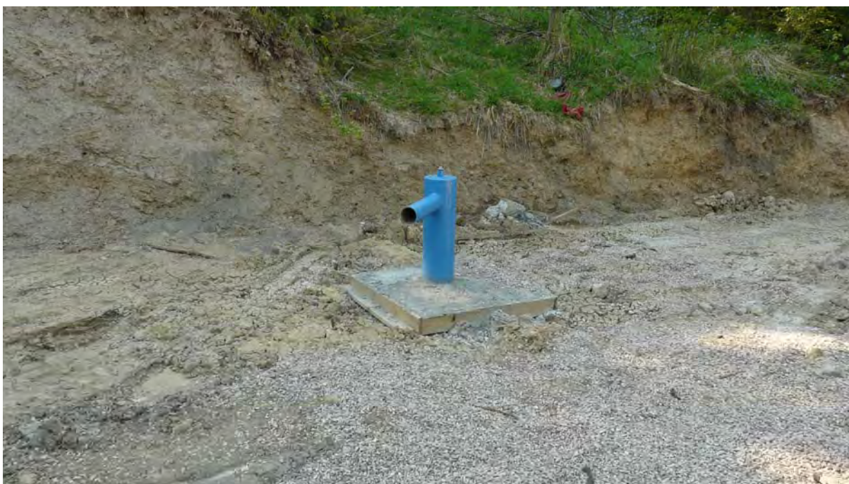
Obr. 112: Teplička nad Hornádom – následky prievahu banskej vody z Novej štólne. Monitorovací vrt situovaný do Novej štólne nad závalom. Priemer krátera 15 m, hĺbka 8-10 m. Foto: P. Bajtoš, 3.5.2009
