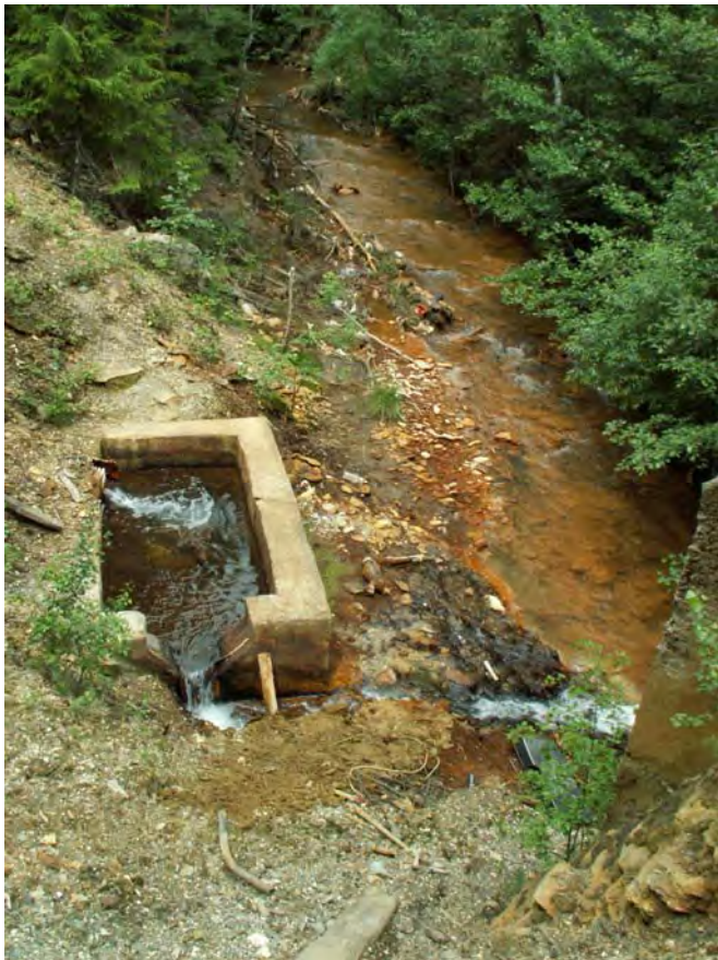
Obr. 59: Lokalita Smolník. Merný objekt banských vôd zo šachty Pech pri Smolníckom potoku. Foto: P. Bajtoš, 30.6.2008
