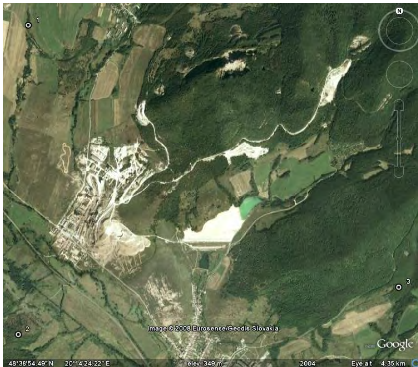
Obr. 1: Lokalita Jelšava. Areál závodu SMZ SZ od Jelšavy s depóniami odpadu po úprave, na V od neho odkalisko a pod jeho hrádzou havarijná nádrž, S od odkaliska Dúbravský masív na vrchole so závalovým pásmom a po svojom obvode s haldami. Zdroj: Google Earth, satelitná snímka z roku 2004
