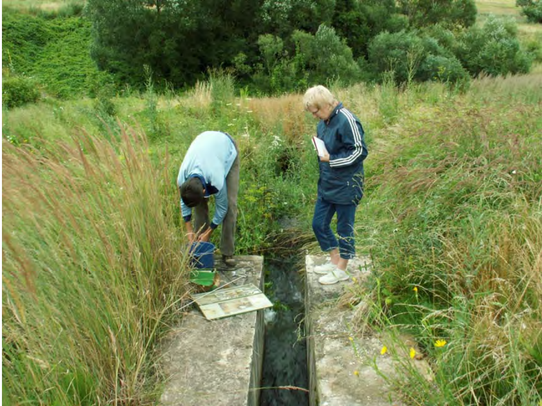
Obr. 7: Lokalita Jelšava. Merný objekt priesaku z odkaliska SMZ Jelšava. Meranie prietoku (P. Bajtoš, Ľ. Záhorová). Foto: P. Baláž, 15.7.2008
