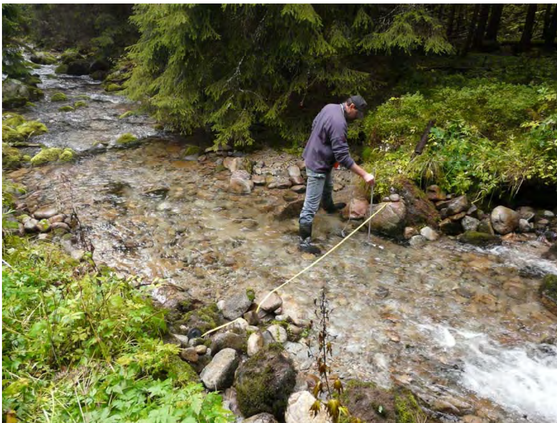
Obr. 84: Lokalita Dúbrava. Hydrometrické meranie potoka Paludžanka v profile nad štôľňou Svätopluk. Foto: P. Bajtoš, 3.10.2008
