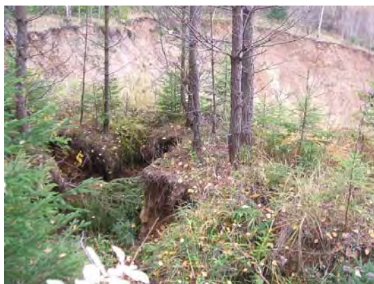
Obr.2.4.91: Zátřhy na okrajoch závalu siahajú hlboko do lesného porastu (foto Záhorová, 2007)
