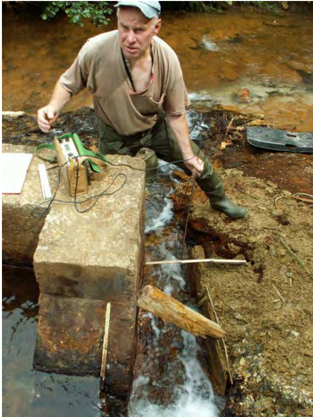
Obr. 57: Lokalita Smolník. Detail merného objektu banskej vody šachty Pech. Pre poškodenie prelivovej hrany je nemožné merať pomocou výšky prepadu, pre nevhodné osadenie objektu je nemožné merať do nádoby. Improvizované hydrometrické merania J. Blahuta. Foto: P. Bajtoš, 30.6.2008
