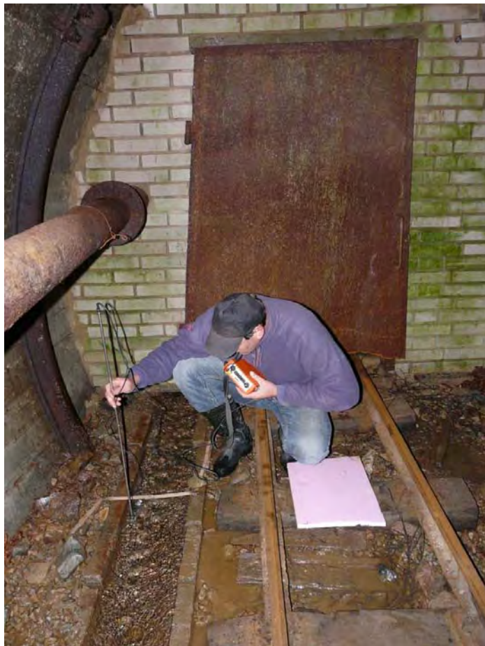
Obr. 82: Lokalita Dúbrava. Hydrometrické meranie profilu v štôlni Martin S. Olekšákom. Foto: P. Bajtoš, 3.10.2008
