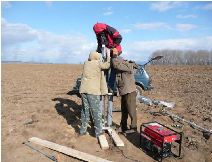
Obr.2.8.7: Vrtanie sondy pomocou vrtného kladiva
