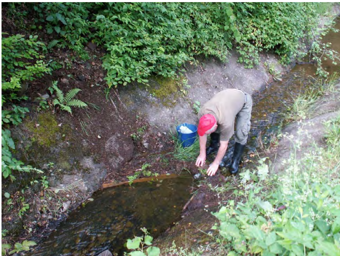
Obr. 44: Lokalita Slovinky. Meranie prietoku potôčka (v odvodňovacom rigole) pritekajúceho k starému odkalisku Slovinky z vyššie položeného úseku doliny. Foto: P. Bajtoš, 26.6.2008
