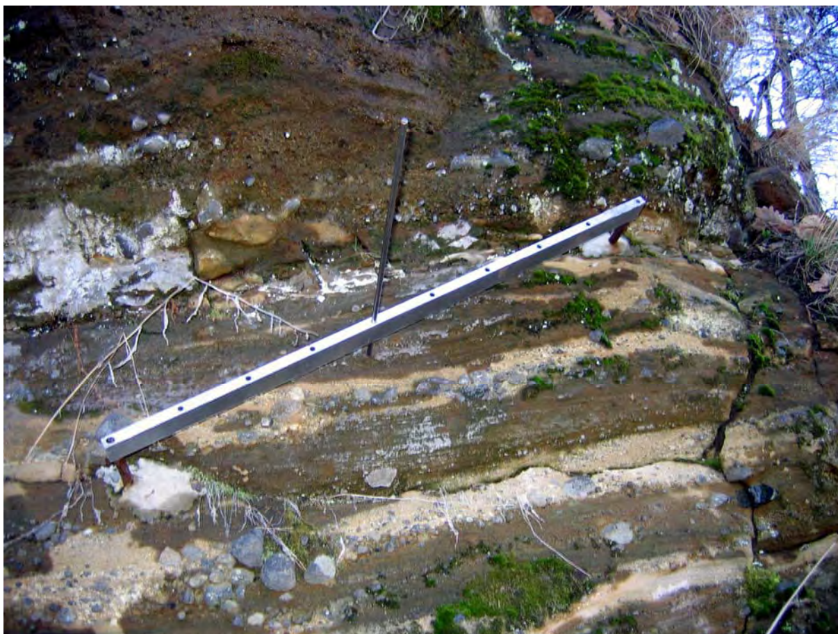
Obr. 2.1.128: Situovanie meradla mikromorfologických zmien povrchu horniny na skalnej stene oproti katastrofálnemu handlovskému zosuvu (lokalita Handlová-Baňa; foto P. Liščák, 2005)
