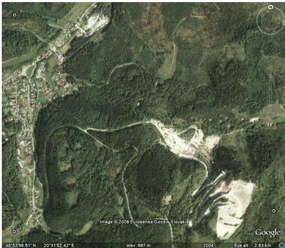
Obr.30: Lokalita Novoveská Huta. Vápencový lom Gréťa V od obce Novoveská Huta, S od neho sa v smere Z – V tiahne pásmo závalov nad vyťaženými časťami sadrovcového ložiska Tollstein ťaženého úpadnicou z Novoveskej Huty. Zdroj: Google Earth, satelitná snímka z roku 2004
