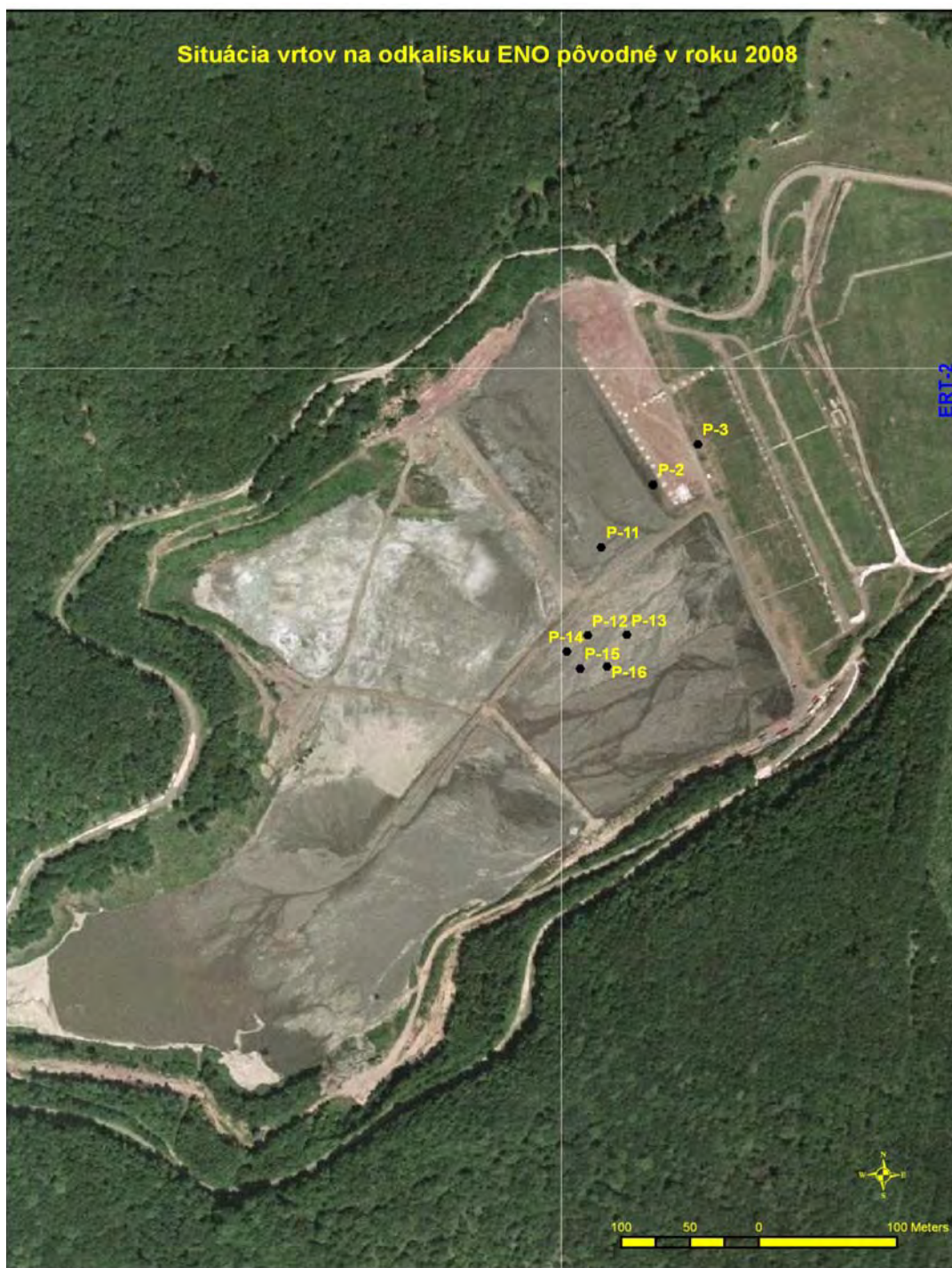
Obr. 2.3.66: Odkalisko ENO Pôvodné – situácia vrtov na odber vzoriek a na presiometrické merania
