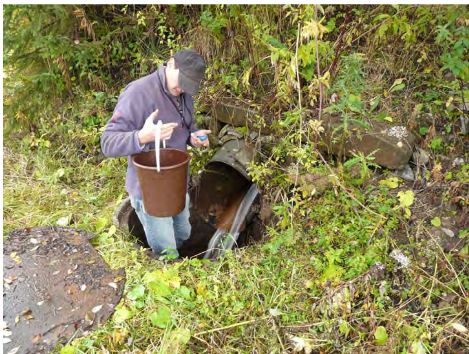
Obr. 92: Lokalita Dúbrava. Meranie prietoku banskej vody S. Olekšákom v prepadovej šachte pod ústím štólne Flotačná. Foto: P. Bajtoš, 3.10.2008
